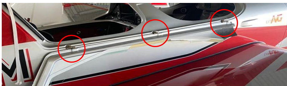
Rys. 4 Rozmieszczenie zawiasów mocowania osłony kabiny na prawej burcie samolotu [źródło: PKBWL]
