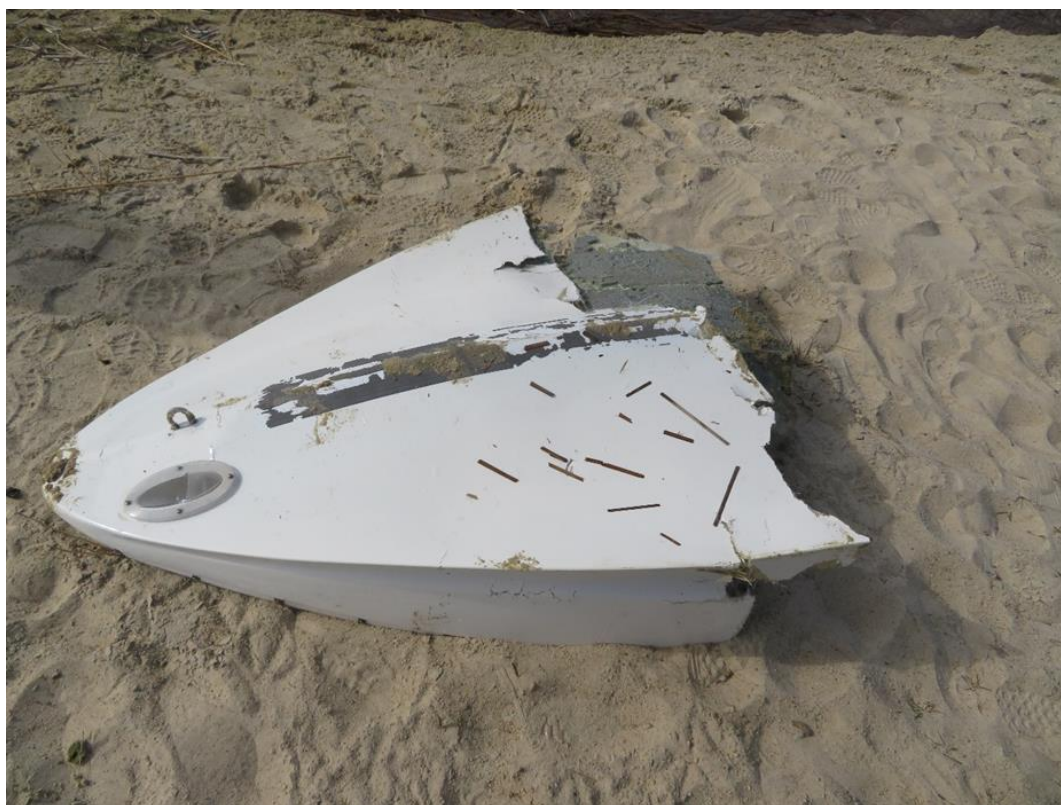
Rys. 4. Widok oderwanej dolnej części kadłuba [źródło: PKBWL].
