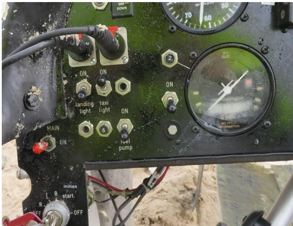
Rys. 10. Sylwetka samolotu w zakrętomierzu wskazująca zakręt w lewo [źródło: PKBWL].
