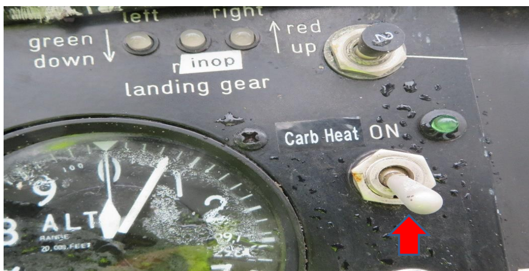
Rys. 9. Wyłącznik podgrzewu gaźników w położeniu wyłączonym. [źródło: PKBWL].
