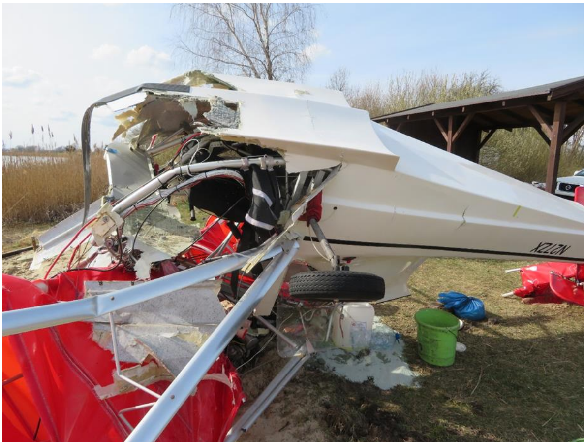
Rys. 3. Widok zniszczeń przedniej części kadłuba samolotu w położeniu odwróconym [źródło: PKBWL].
