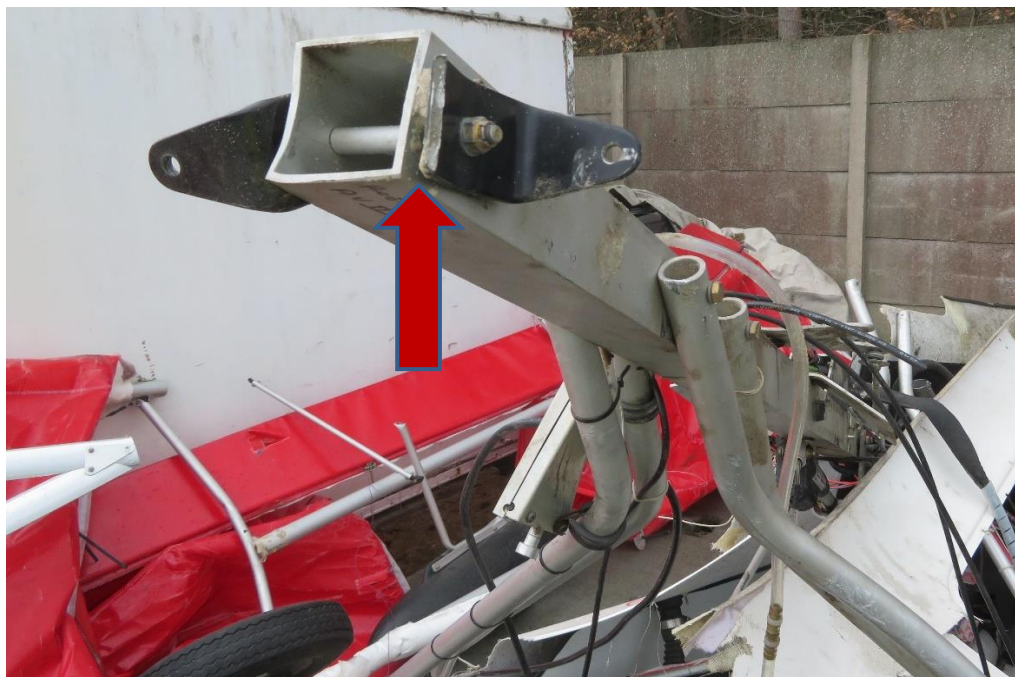
Rys. 8. Urwany zawias mocowania przedniego dźwigara lewego skrzydła [źródło: PKBWL].
