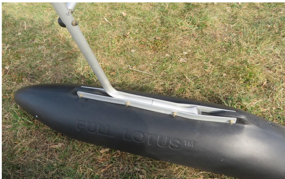
Rys. 7. Widok urwanego lewego pływaka [źródło: PKBWL].
