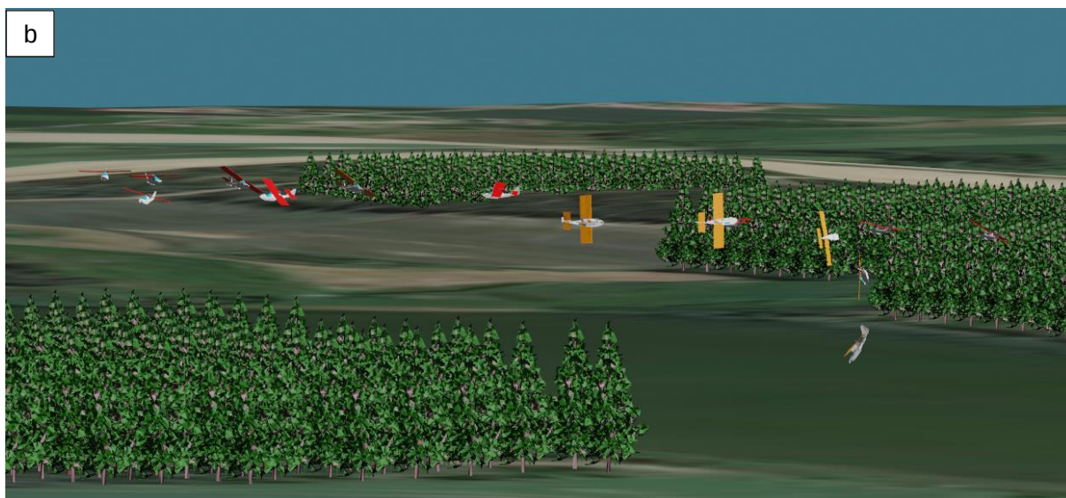
Rys. 15. Trasa lotu samolotu w rejonie jeziora Kłeckiego odtworzona na podstawie zeznania świadka nr 3, a – widok z wysokości oczu świadka nr 3, b – widok z wysokości 50 m AGL [źródło: PKBWL].
