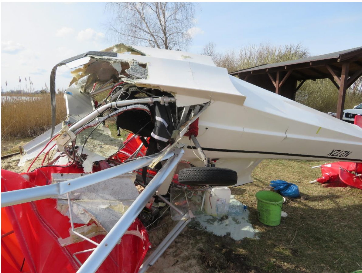
Rys.2 Uszkodzenia przedniej części kadłuba samolotu w położeniu odwróconym [źródło: PKBWL]
