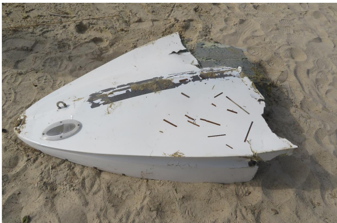
Rys.3 Oderwana dolna część kadłuba [źródło: PKBWL]
