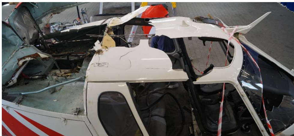
Rys. 3 Uszkodzony kadłub śmigłowca i miejsce po przekładni głównej.
