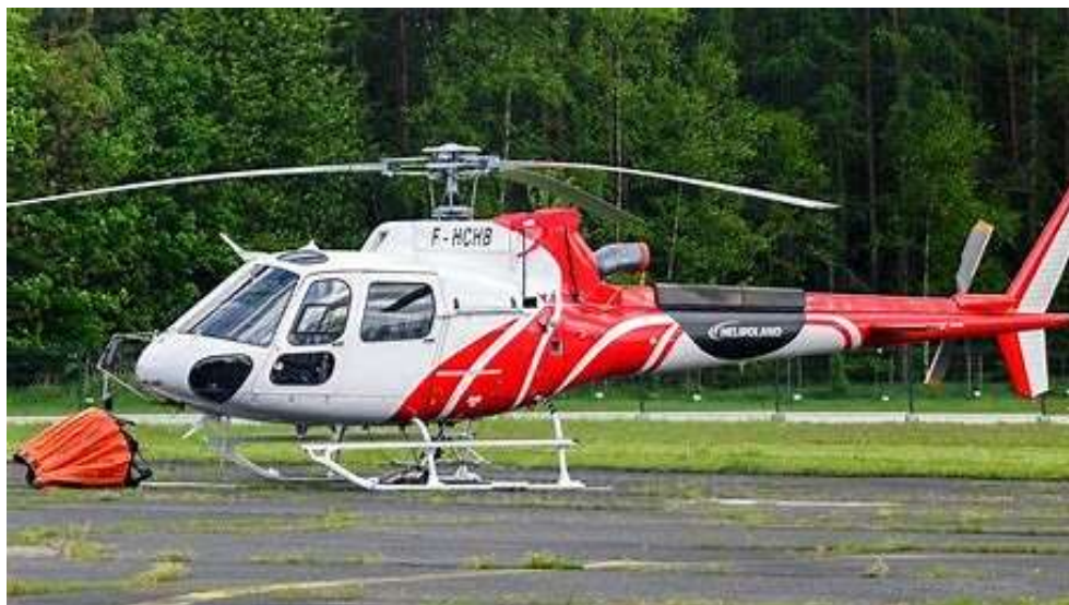
Rys. 4 Śmigłowiec AS350B3e oraz zasobnik typu bambi bucket do transportowania wody [źródło: airplane-pictures.net]
