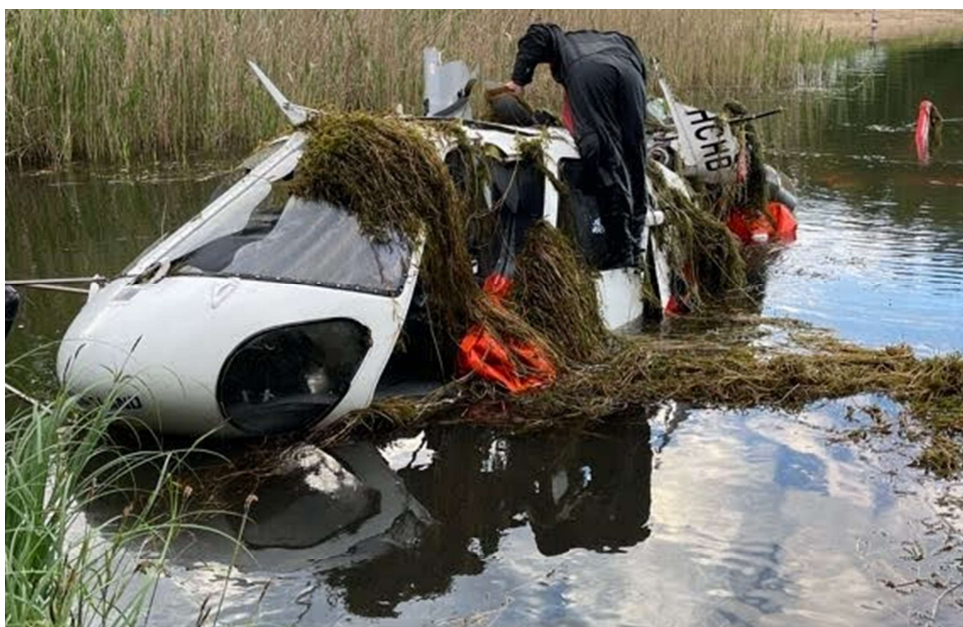
Rys. 2 Wrak śmigłowca podczas wydobywania na brzeg jeziora. Zwraca uwagę brak wirnika oraz oddzielona przekładnia główna.
