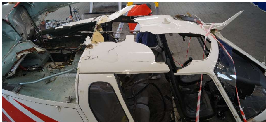
Rys. 3 Wrak podczas oględzin powypadkowych w hangarze Operatora. Widać miejsce po wybudowanej przekładni, spękaną skorupę kadłuba oraz wybite oszklenie kabiny [źródło: PKBWL]
