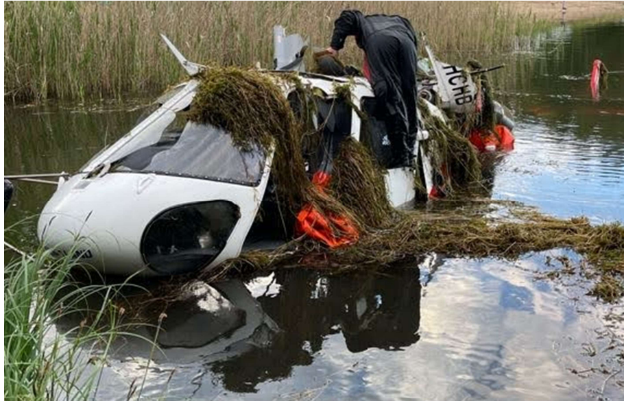
Rys. 2 Wrak śmigłowca podczas wydobywania na brzeg jeziora. Zwraca uwagę oddzielony wirnik oraz przekładnia główna [źródło: PKBWL]
