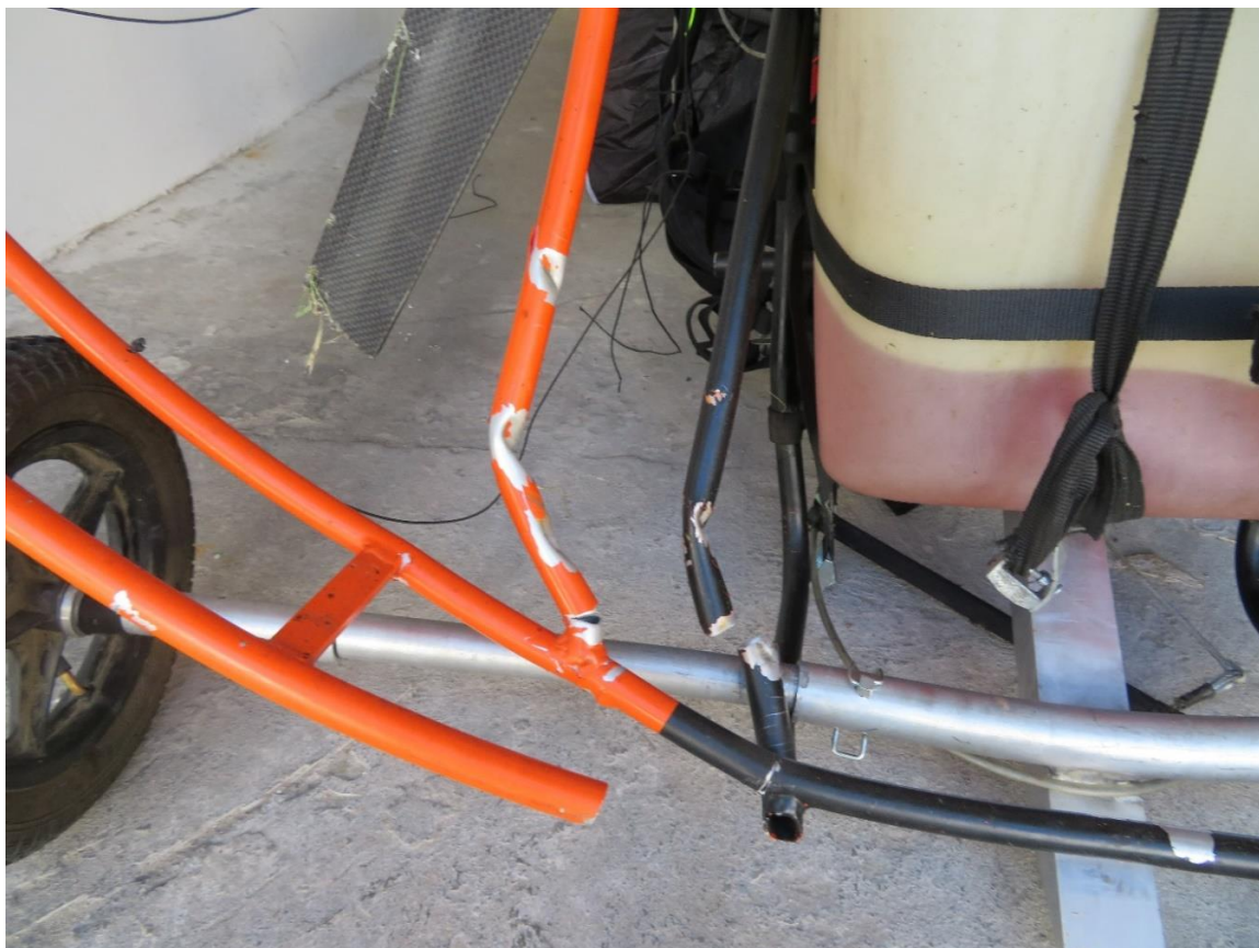
Rys. 3 - uszkodzone przez łopaty śmigła elementy mocowania kosza ochronnego [źródło PKBWL]
