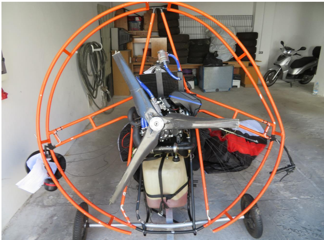
Rys. 1- widok uszkodzeń osłony od strony mocowania silnika [Źródło PKBWL]
