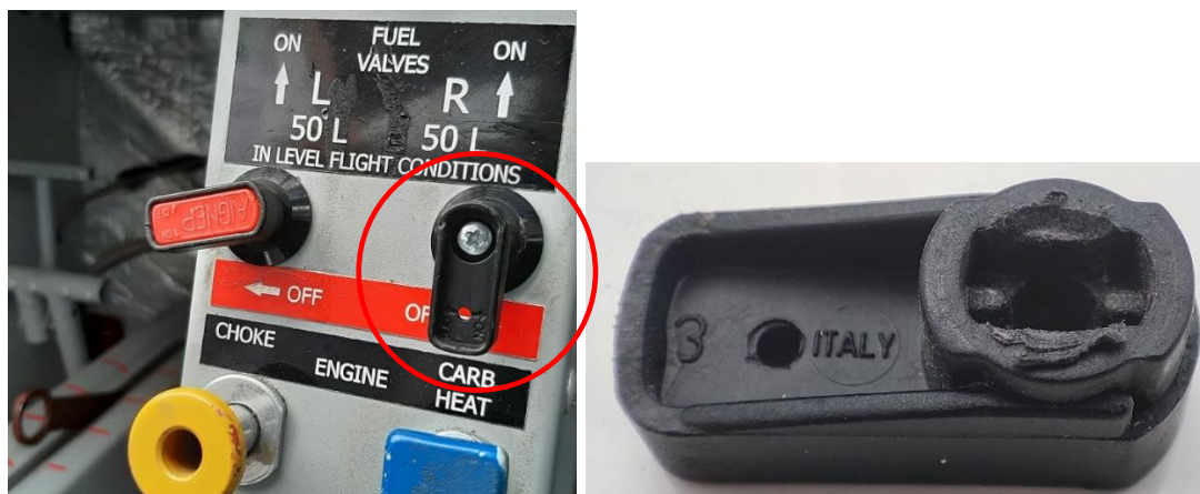
Rys. 2. Uszkodzone pokrętko zaworu zbiornika paliwa w prawym skrzydle. Po prawej stronie powiększony obraz pokrętki (widok od spodu) z wyraźnie widocznymi wyżłobieniami pod trzpień [źródło: PKBWL]
