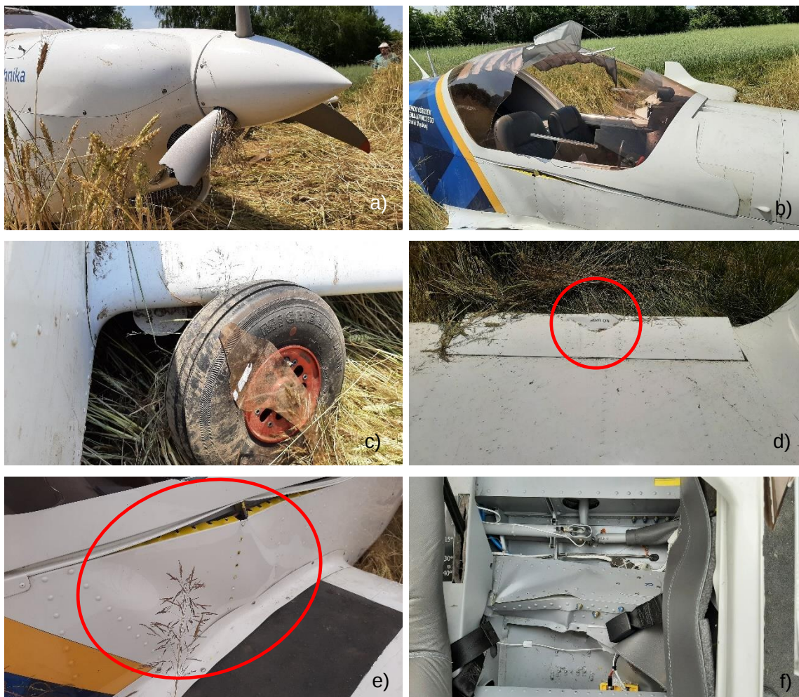
Rys. 1. Uszkodzenia samolotu: a) śmigło, b) rozbite oszklenie kabiny, c) uszkodzone podwozie, d) zdeformowana lewa lotka, e) sfalowana struktura prawej burty kadłuba, f) rozerwane wzmocnienia pod goleń podwozia głównego w kadłubie [źródło: PKBWL]
