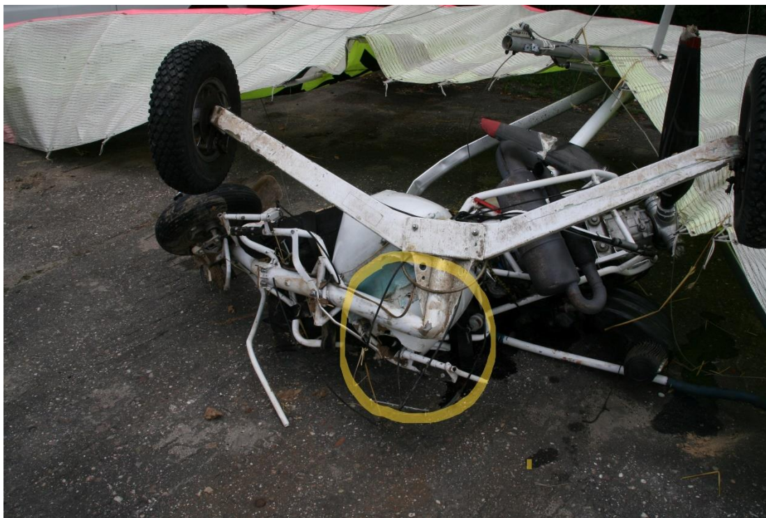
Rys. 2. Uszkodzenie rury poziomej przedniego koła, kolorem żółtym zaznaczono wygięcie rury (źródło: PKBWL)
