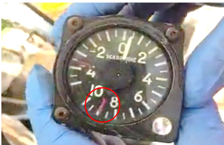
Rys. 13 Przeciężniomierz znaleziony we wraku – kadr z nagrania video z miejsca wypadku [źródło: PKBWL]
