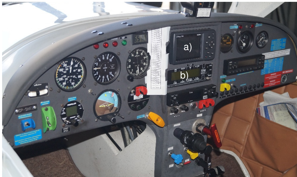
Rys. 11 Tablica przyrządów samolotu holującego: (a) GPS Garmin 296, (b) FLYdat [źródło: PKBWL]
