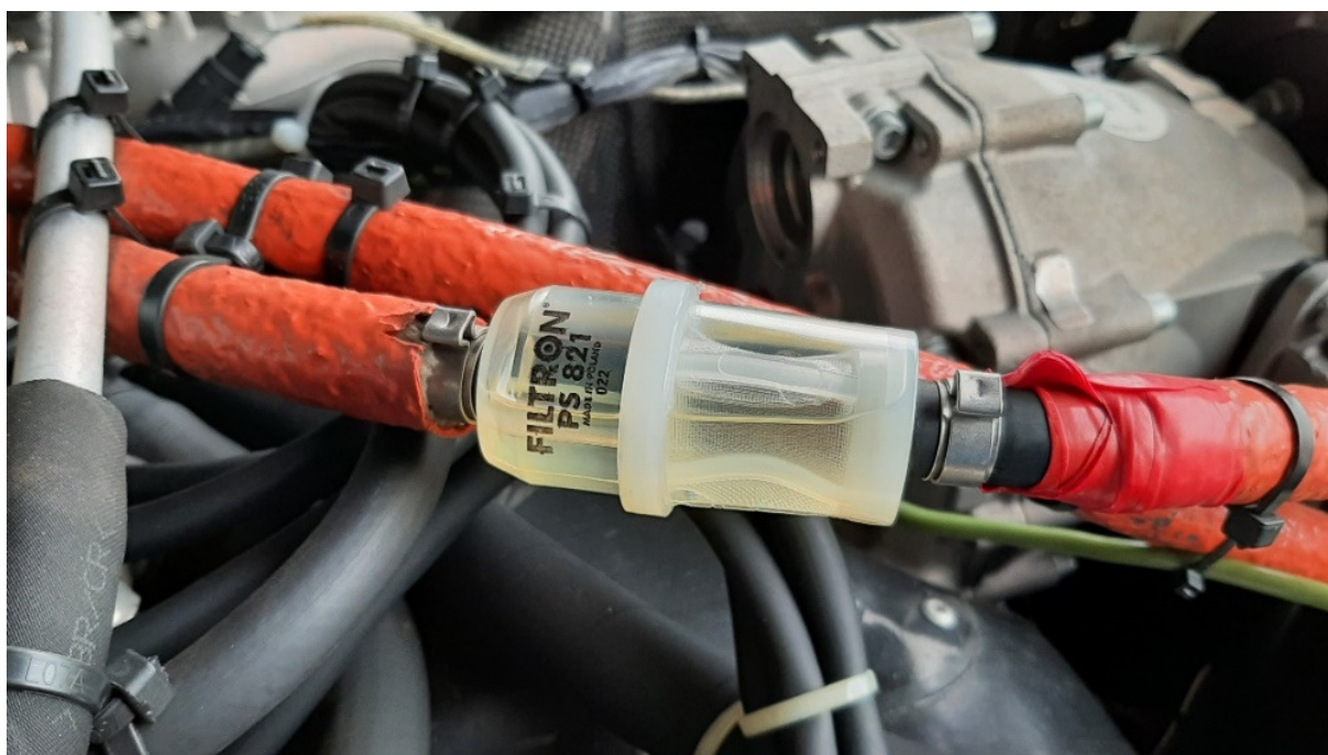
Rys. 17 Paliwo w filtrze na silniku [źródło: PKBWL]
