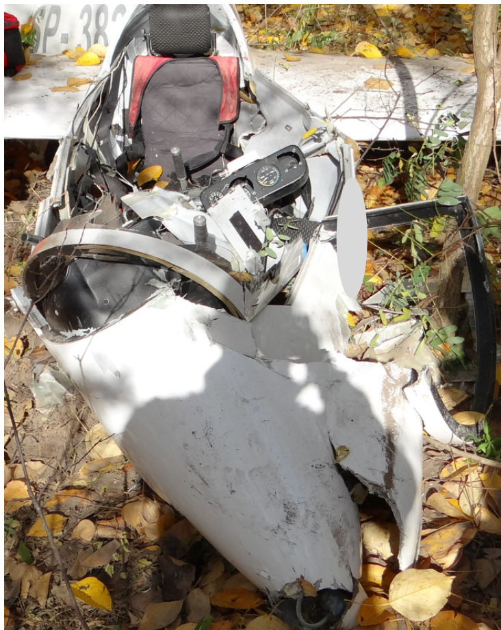
Rys. 4 Zniszczenia kabiny szybowca [źródło: PKBWL]
