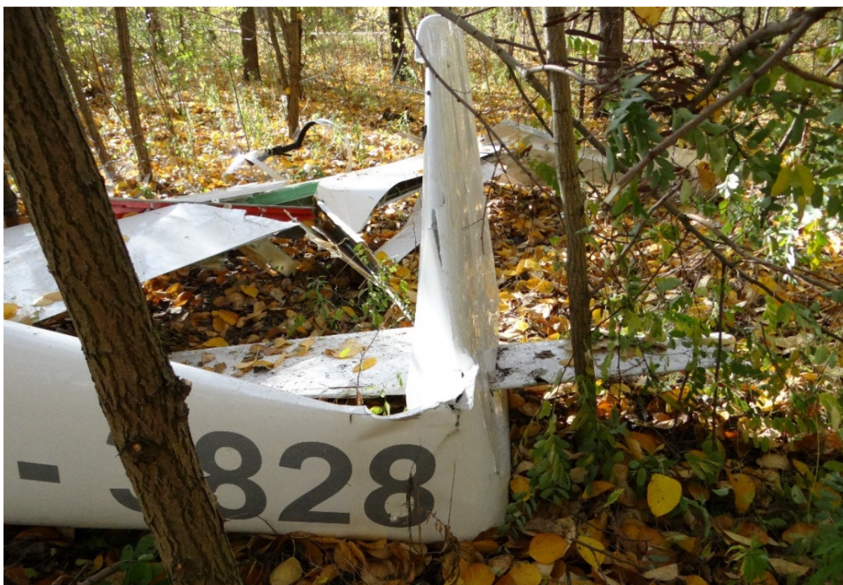
Rys. 3 Zgnieciony i przelamany ogon oraz rozerwane prawe skrzydło [źródło: PKBWL]
