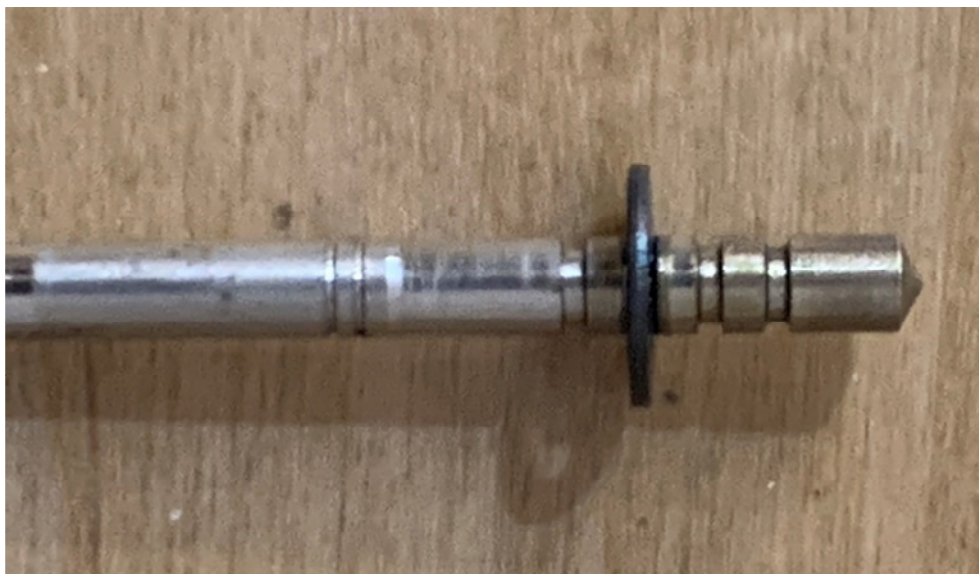
Rys. 18 Iglica gaźnika i jej ustawienie [źródło: PKBWL]
