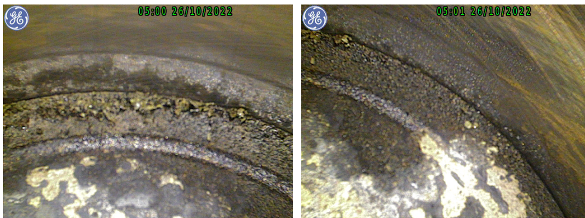
Rys. 15 Zdjęcia wnętrza cylindra nr 1, wykonane przy użyciu boroskopu [źródło: PKBWL]
