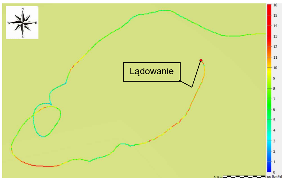
Rys. 9. Trasa i prędkość lotu balonu względem ziemi – ostatnie 15 min. Rozkład prędkości i kierunków wiatru przed lądowaniem [źródło: SeeYou]
