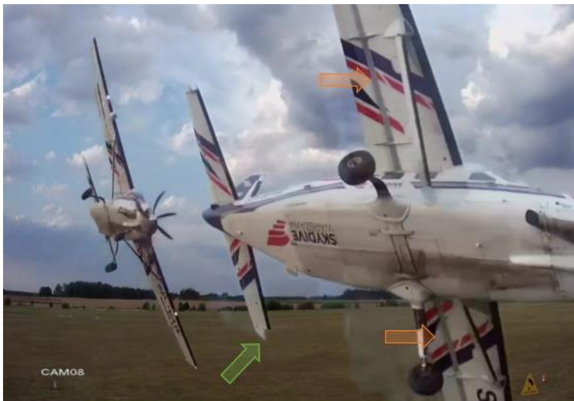
Rysunek 2. Cessna 208B, SP-WAW (dalszy ciąg rys. 1), gdzie: prawy kadr pokazuje samolot w momencie kontaktu lewego skrzydła z powierzchnią lądowiska, wysunięte symetrycznie klapki skrzydeł – pomarańczowe strzałki, ster wysokości wychylony do góry – zielona strzałka
