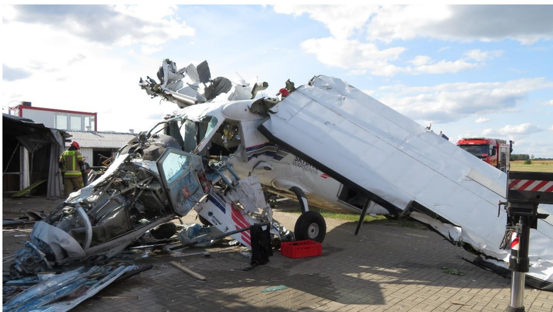
Rysunek 5. Samolot Cessna 208B, SP-WAW – wrak po oddzieleniu od konstrukcji budynku
