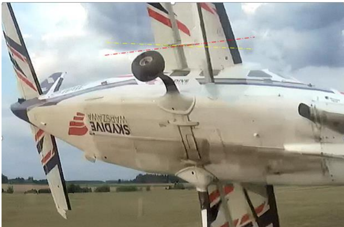
Rysunek 15. Cessna 208B, SP-WAW – powiększenie jednego z kadrów monitoringu, gdzie: linia czerwona wskazuje na przedłużenie krawędzi prowadnicy klap, linia żółta wskazuje na przedłużenie krawędzi wspornika klap
