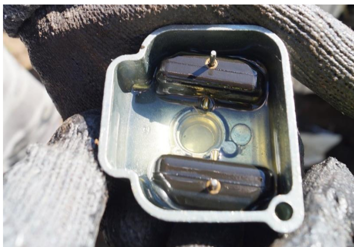
Rysunek 11. Komora pływakowa gaźnika samolotu Storch CL OK-TUV 61 z ujawnionym wewnątrz paliwem
