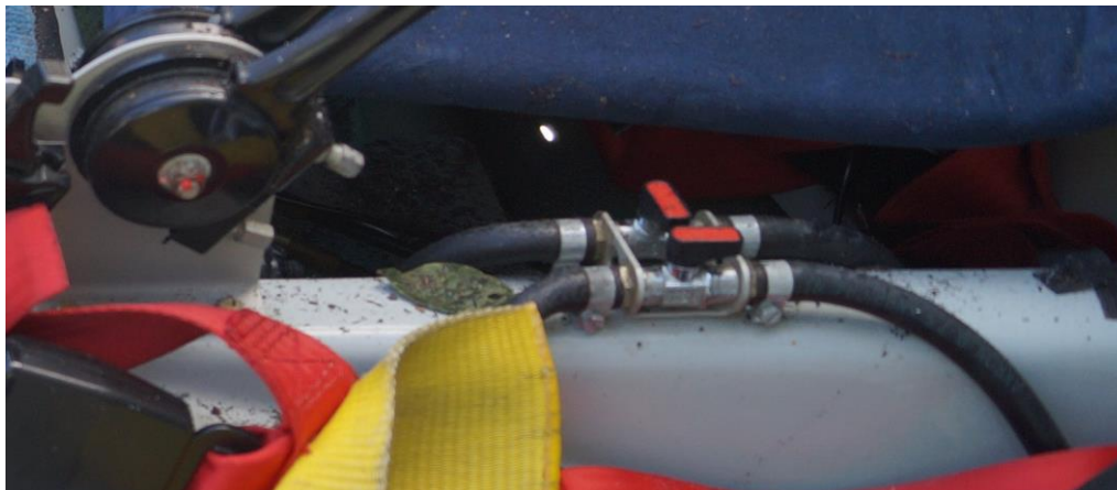
Rysunek 10. Krany paliwowe samolotu Storch CL OK-TUV 61 po wypadku. Widoczny zamknięty kran prawego zbiornika i otwarty kran paliwowy lewego zbiornika
