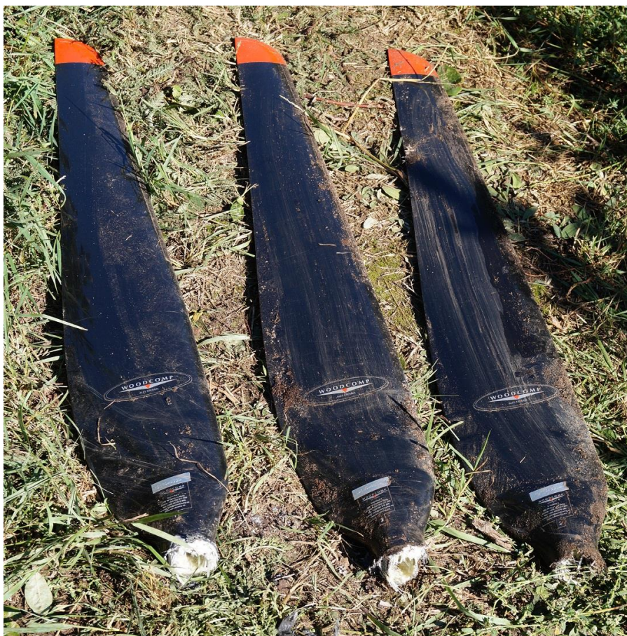
Rysunek 6. Łopaty śmigła samolotu Storch CL OK-TUV 61 po wydobyciu ich spod wraku samolotu
