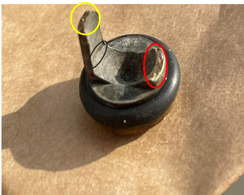
Rysunek 4. Kolor żółty-przełom doraźny; czarny-wgłębienie materiału (karb); czerwony-przełom zmęczeniowy
