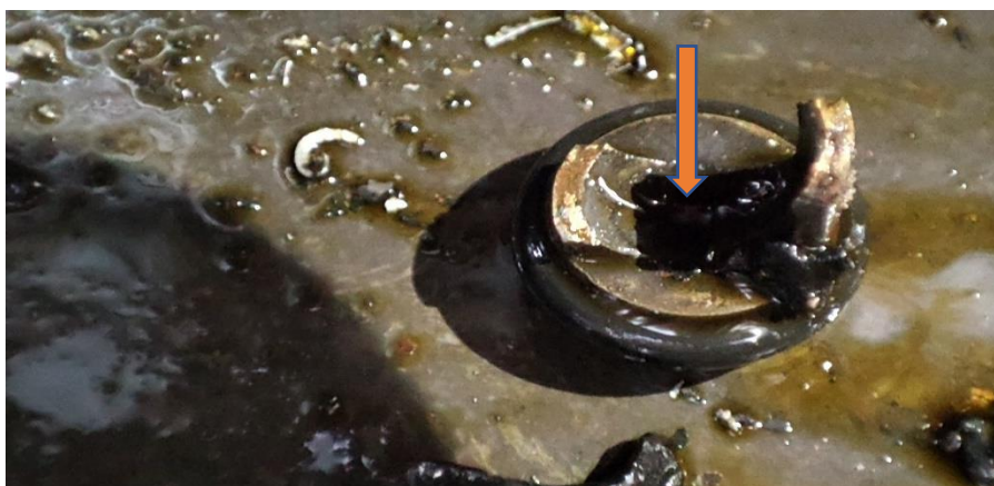
Rysunek 3. Górna część urwanego zaworu spustu paliwa
