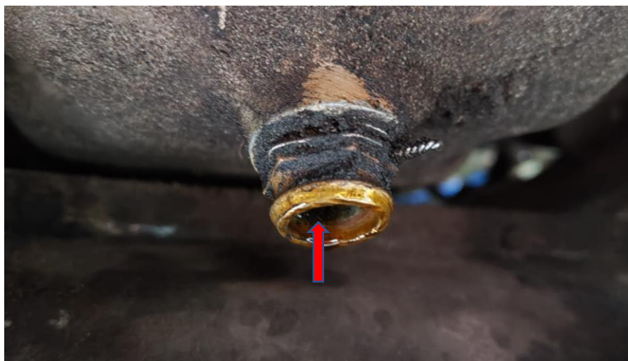
Rysunek 2. Miejsce montażu zaworu spustu oleju
