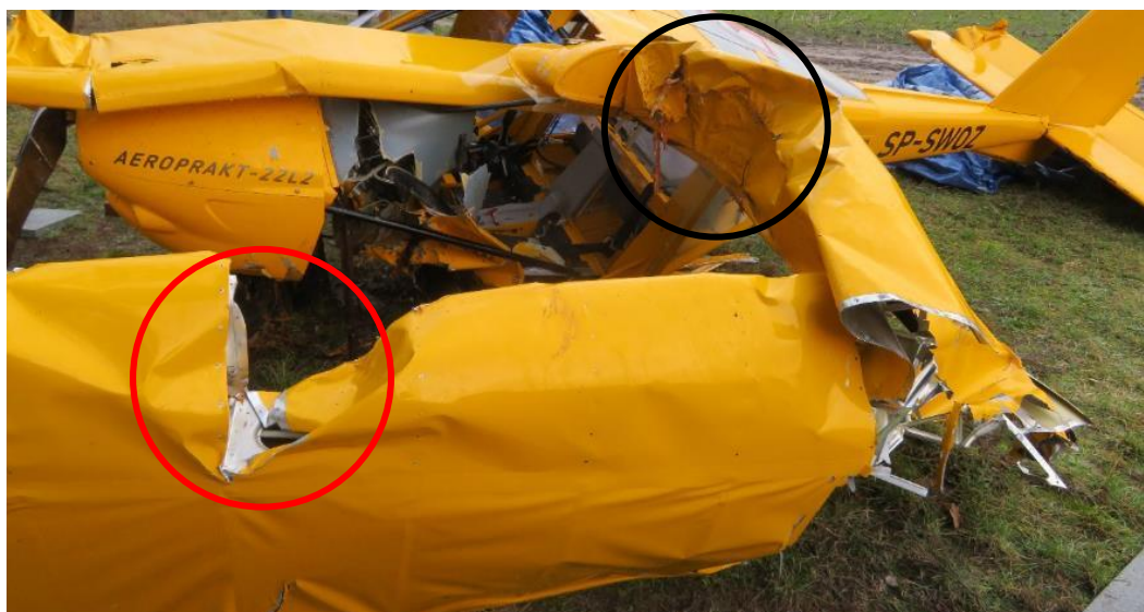
Rys. 13. Charakter i rozmiar uszkodzeń lewego skrzydła (kolory jak na rys. 12.)
