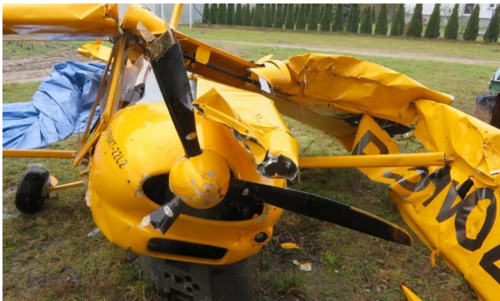
Rys. 9. Widok uszkodzonych łopat śmigła
