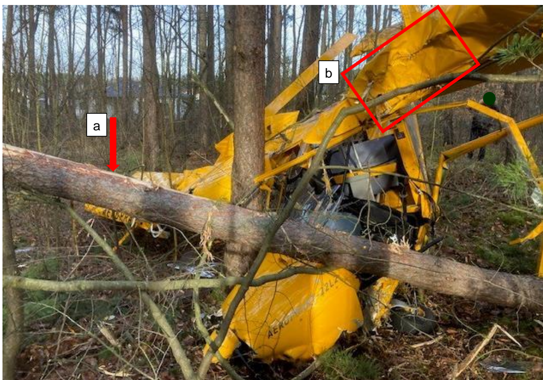
Rys. 3. a – sosna nr 2 przewrócona po uderzeniu lewego skrzydła samolotu; b – wgniecenie krawędzi natarcia lewego skrzydła.
