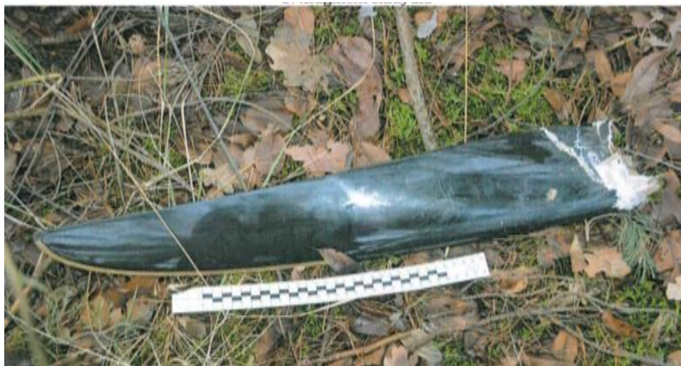
Rys. 10. Fragment urwanej łopaty [źródło: Policja]
