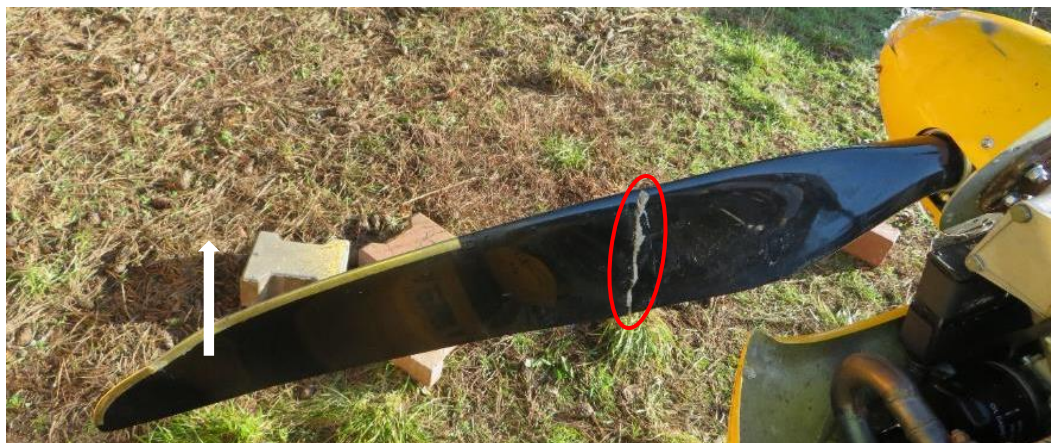
Rys. 11. Miejsce pęknięcia tylnej ścianki łopaty oraz zaznaczony kierunek przemieszczania jej końcówki
