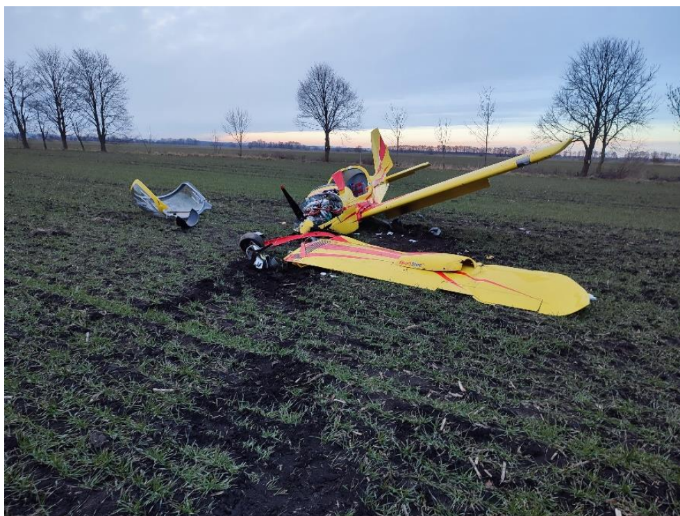
Rysunek 1. Szczątki samolotu w miejscu zdarzenia (widoczne liczne uszkodzenia konstrukcji m.in.: oderwane skrzydła, urwane prawe koło podwozia)
