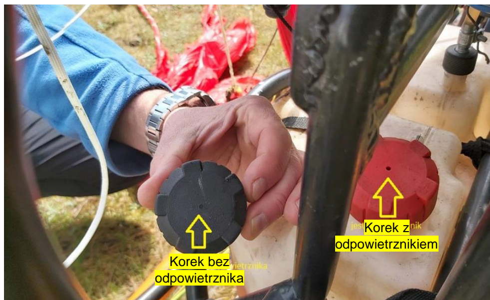
Rysunek 8. Korki paliwa znajdujące się na wyposażeniu motoparalotni. Korek w kolorze czarnym (bez odpowietrznika) używany był do transportu motoparalotni, korek w kolorze czerwonym, wyposażony został w odpowietrznik i stosowany był podczas lotu.
