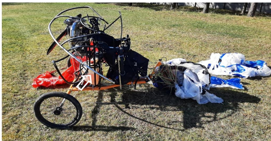
Rysunek 3. Zestaw motoparalotni wydobyty z rzeki. Widoczne fragmenty spletanego i podartego skrzydła (koloru niebiesko-białego) oraz spadochron ratowniczy (koloru czerwonego). Wyraźnie widoczny jest także poziom paliwa w zbiorniku (oznaczono białą strzałką)
