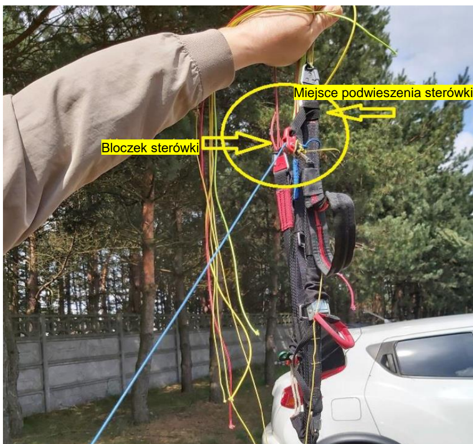
Rysunek 10. Fragment uprząży z pokazanym miejscem podwieszenia sterówek
