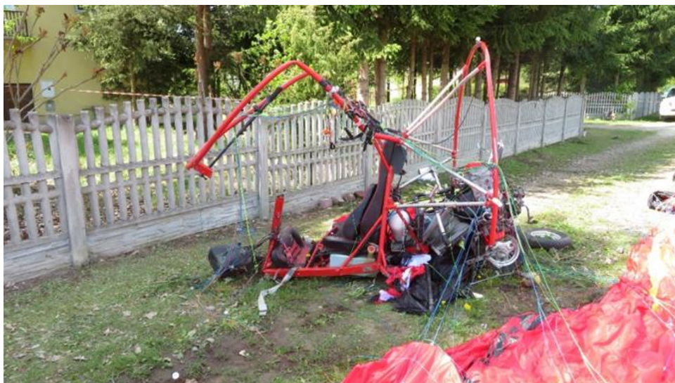
Rysunek 4. Uszkodzony wózek motoparalotni
