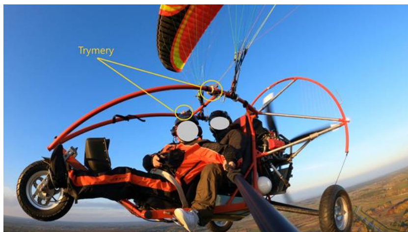
Rysunek 8. Miejsce zamontowania uchwytów trymerów [źródło: użytkownik]
