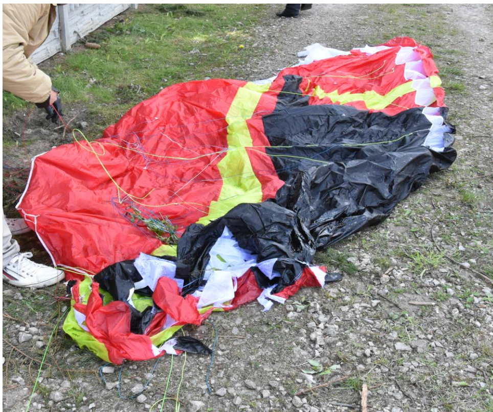
Rysunek 5. Urwany stabilizator skrzydła motoparalotni [źródło: Policja]
