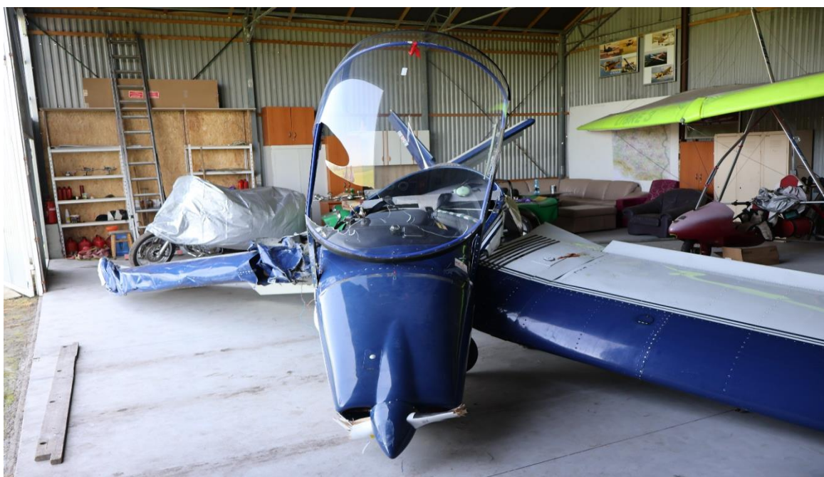
Rysunek 4. Widok uszkodzeń śmigła i lewego skrzydła samolotu.
