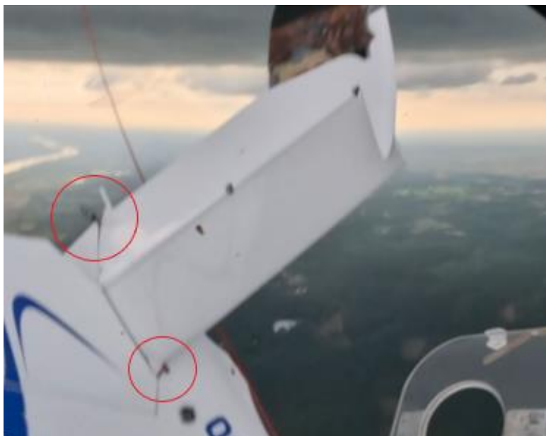
Rysunek 5. Widok na zablokowany liną holowniczą ster wysokości [źródło: kamera pilota]
