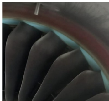
Zdjęcie 1. Ślady wpadnięcia ptaka do silnika oraz zdeformowane łopatki wentylatora. (Źródło PKBWL).
