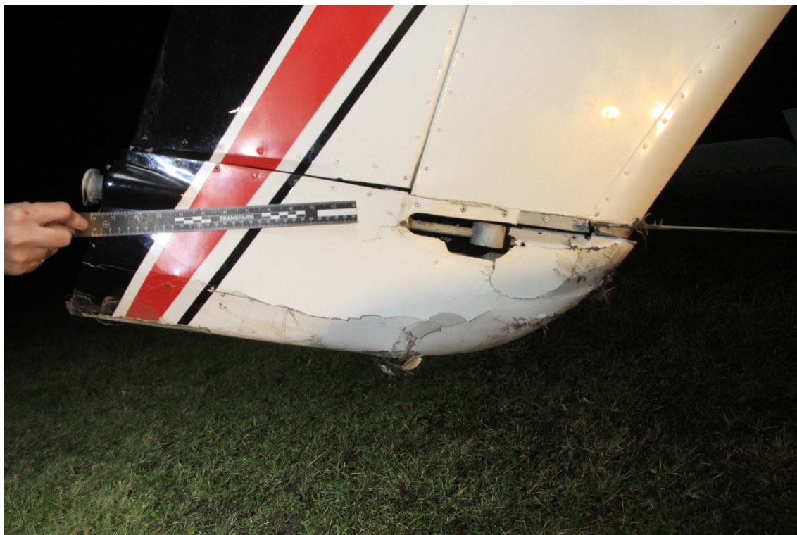
Rysunek 9. Uszkodzenia statecznika pionowego [źródło: KPP w Płońsku]
