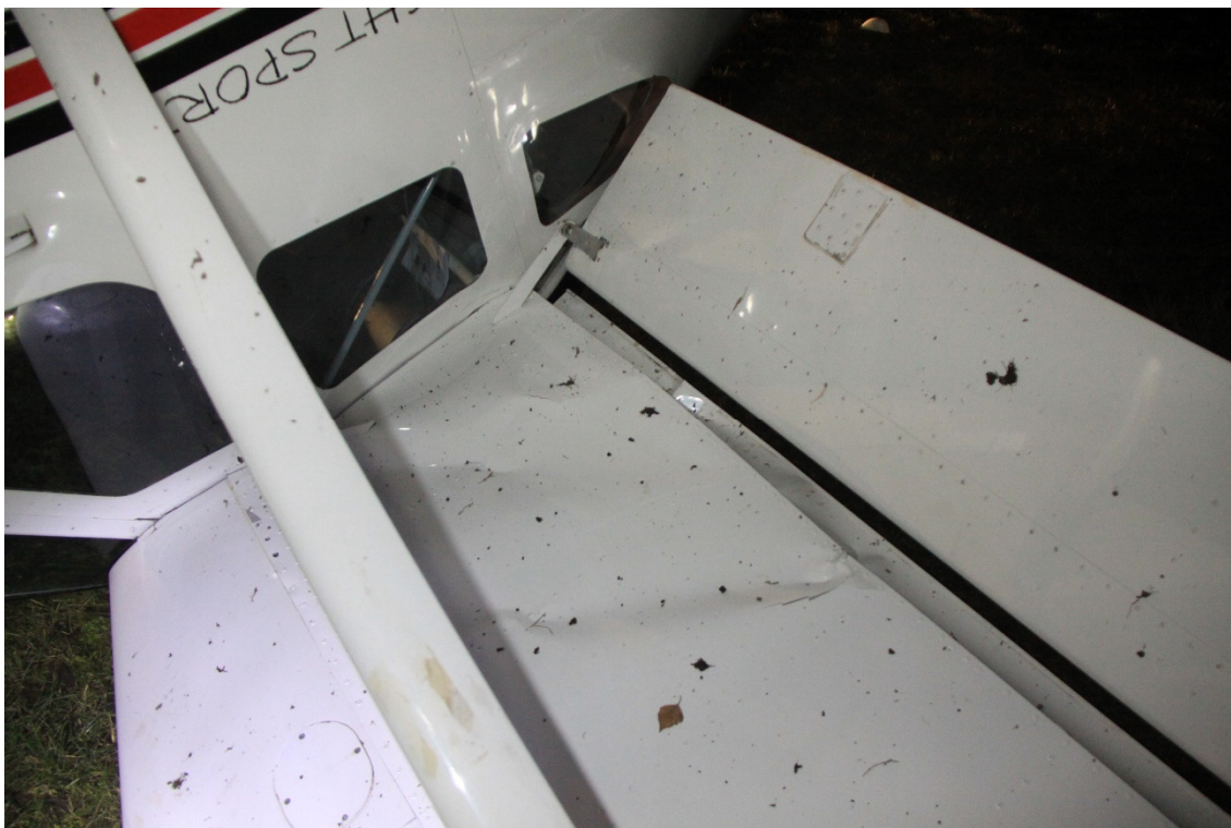
Rysunek 7. Uszkodzenie lewego skrzydła [źródło: KPP w Płońsku]
