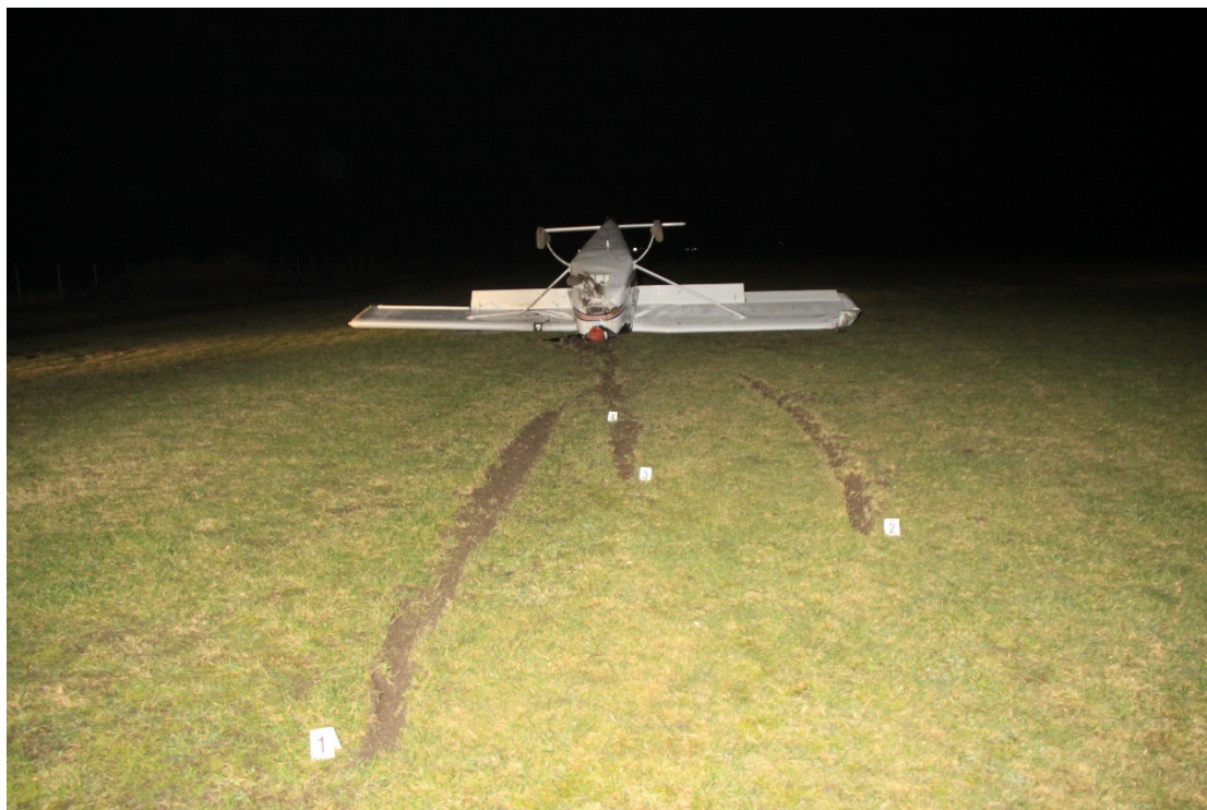
Rysunek 3. Ślady przyziemienia samolotu [źródło: KPP w Płońsku]
