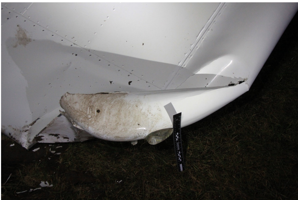
Rysunek 8. Uszkodzona lewa końcówka skrzydła [źródło: KPP w Płońsku]
