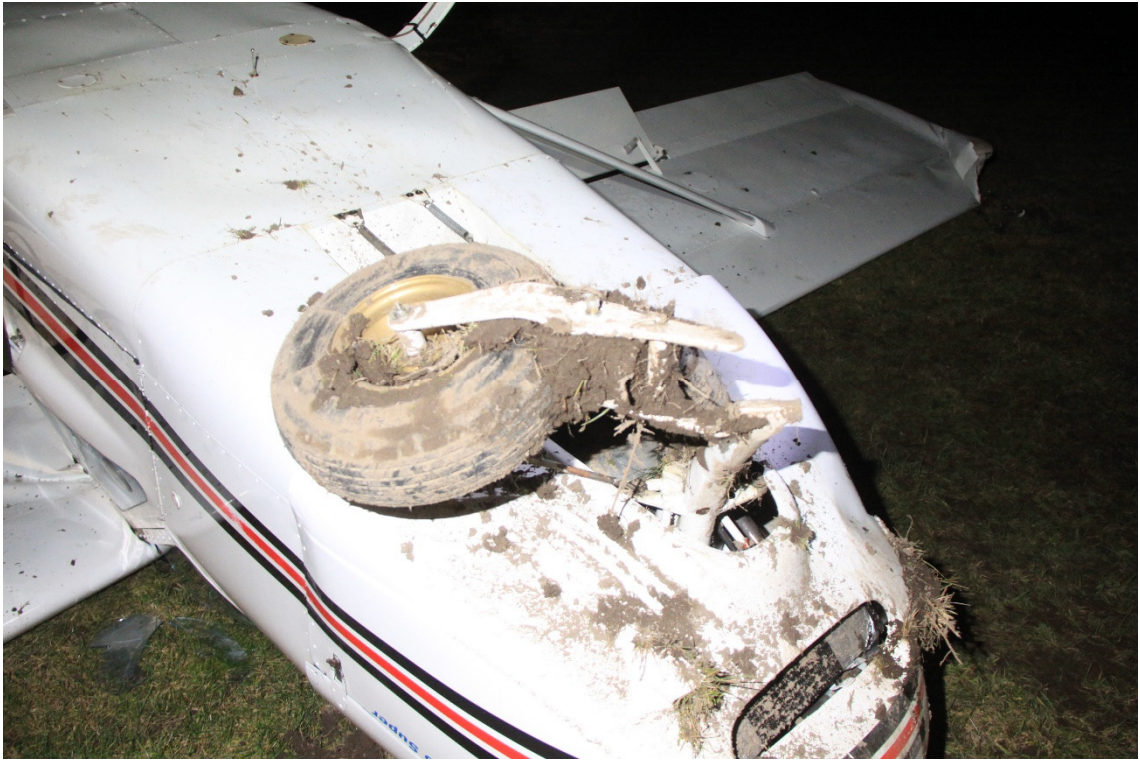
Rysunek 5. Uszkodzenie przedniej goleni podwozia [źródło: KPP w Płońsku]
