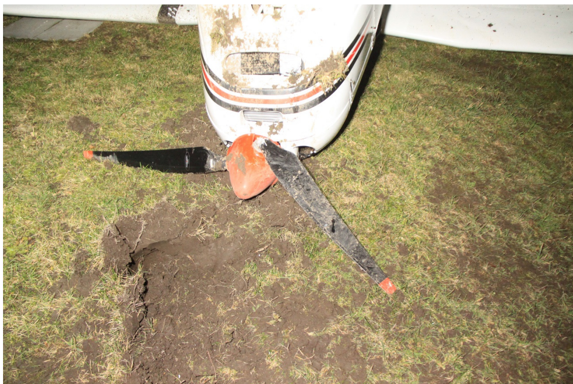
Rysunek 4. Uszkodzenia łopatek śmigła oraz punkt, w którym nastąpił kapotaż samolotu [źródło: KPP w Płońsku]
