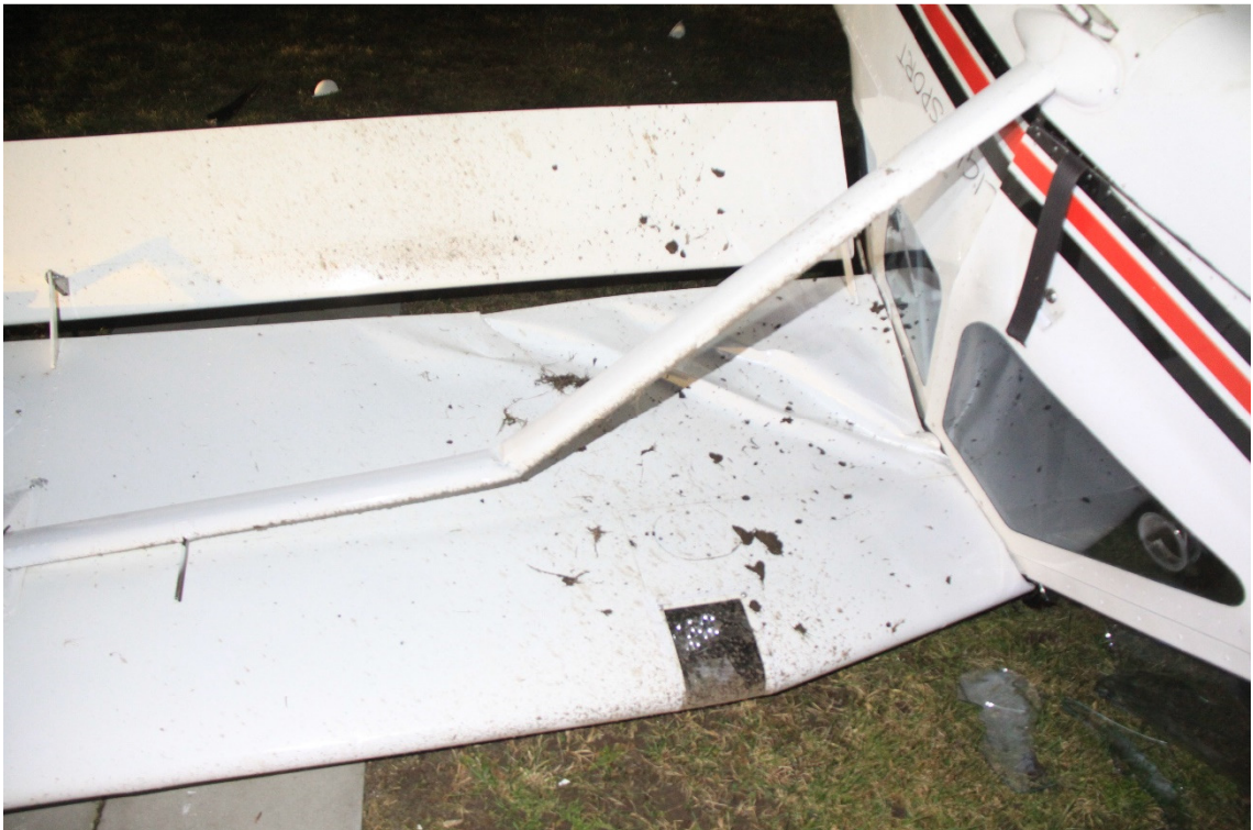
Rysunek 6. Uszkodzenie skrzydła oraz prawego zastrzału [źródło: KPP w Płońsku].
