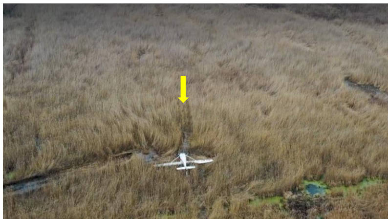
Rys. 2. Położenie samolotu po kapotażu oraz zaznaczone żółtą strzałką miejsce jego przyziemienia
