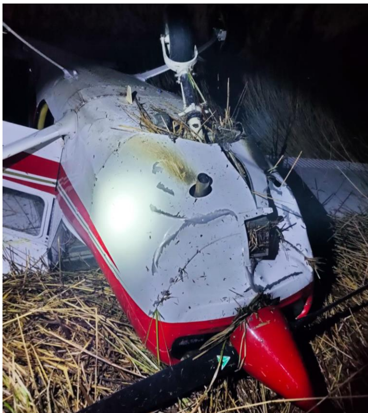
Rys. 2. Widok uszkodzeń przedniej części kadłuba
