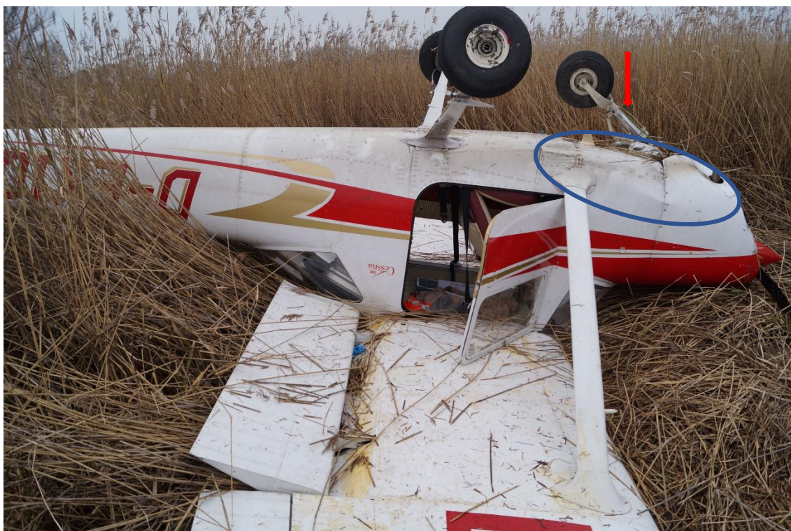
Rys. 5. Widok uszkodzeń na przedniej części kadłuba.
