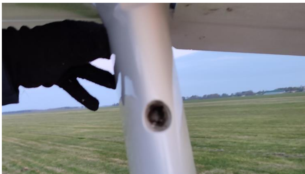
Rys. 2. Brak sworzni mocującego statecznik poziomy [źródło: Aeroklub Gdański]
