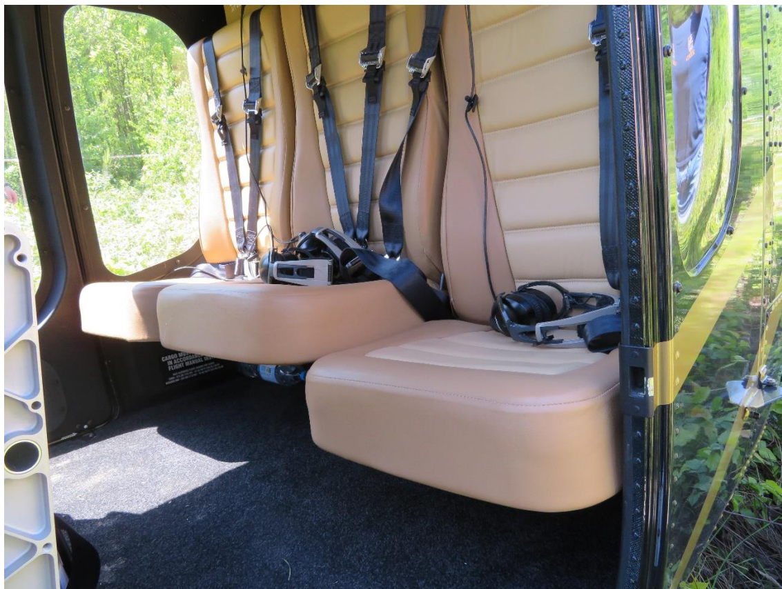
Rysunek 7. Tylny fotel pasażera po zadziałaniu systemu absorpcji energii
