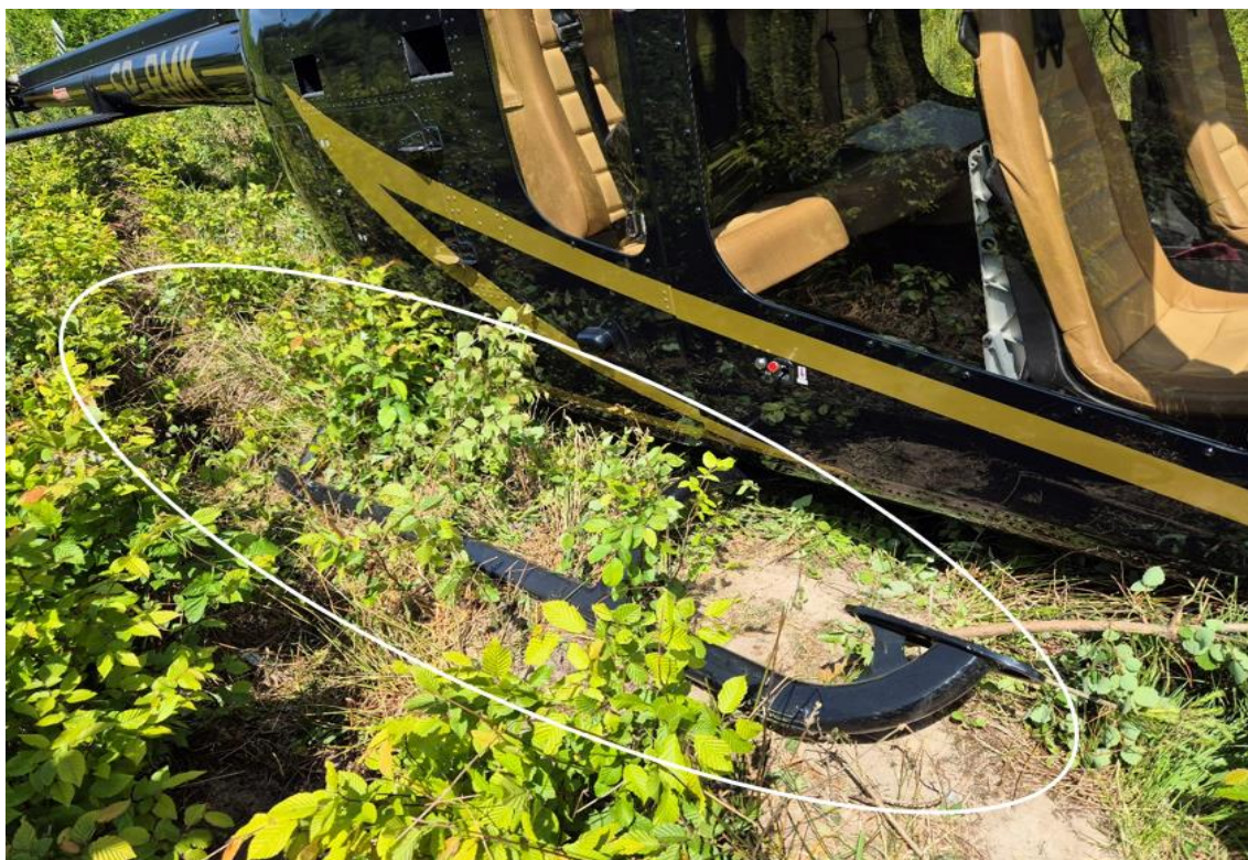
Rysunek 4. Uszkodzenie prawej płozy podwozia śmigłowca.
