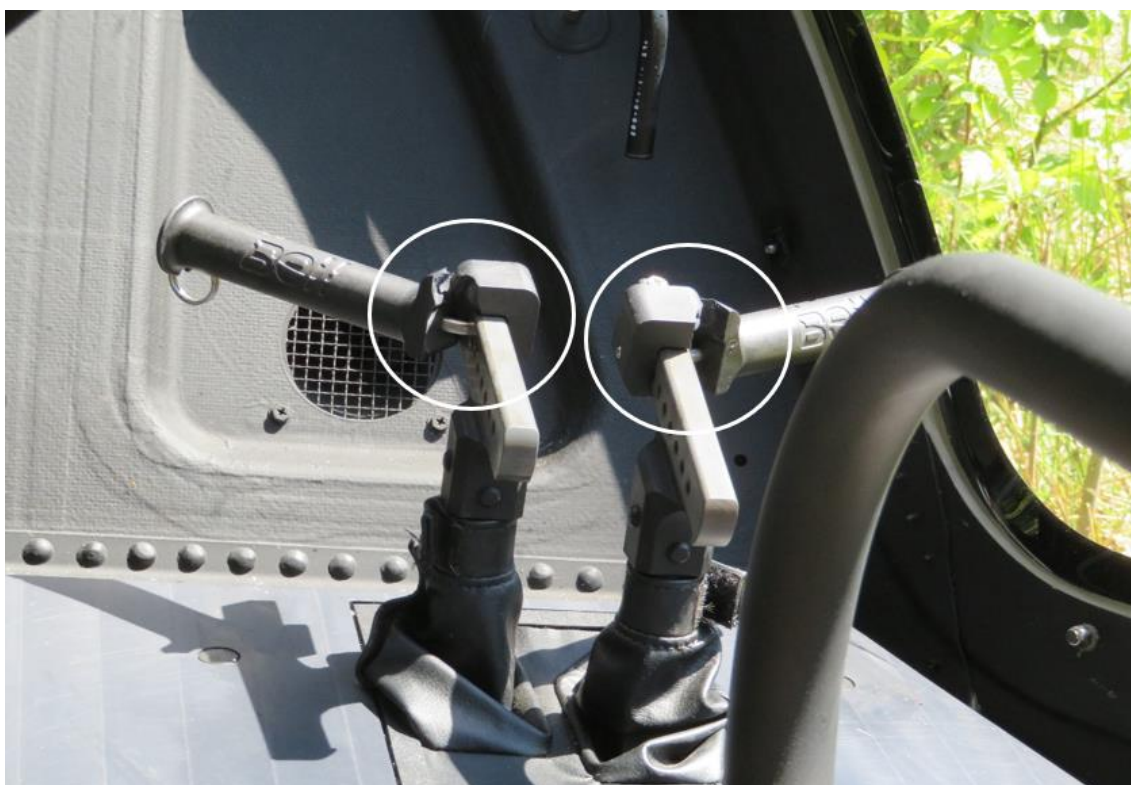
Rysunek 6. Uszkodzone pedały po stronie pilota lecącego.
