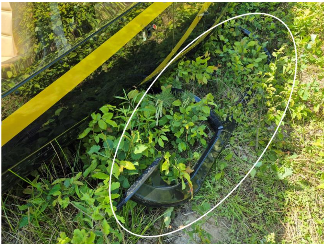
Rysunek 3. Uszkodzenie lewej płozy podwozia śmigłowca.
