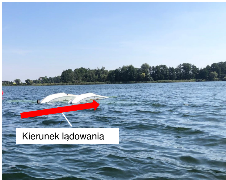
Rys.1 Samolot po kapotażu z widocznym odchyleniem w lewo
