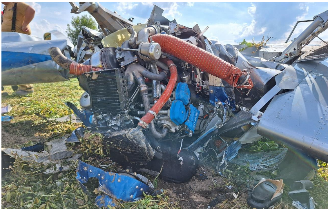
Rys. 3 Zniszczony zespół napędowy [źródło: PKBWL]
