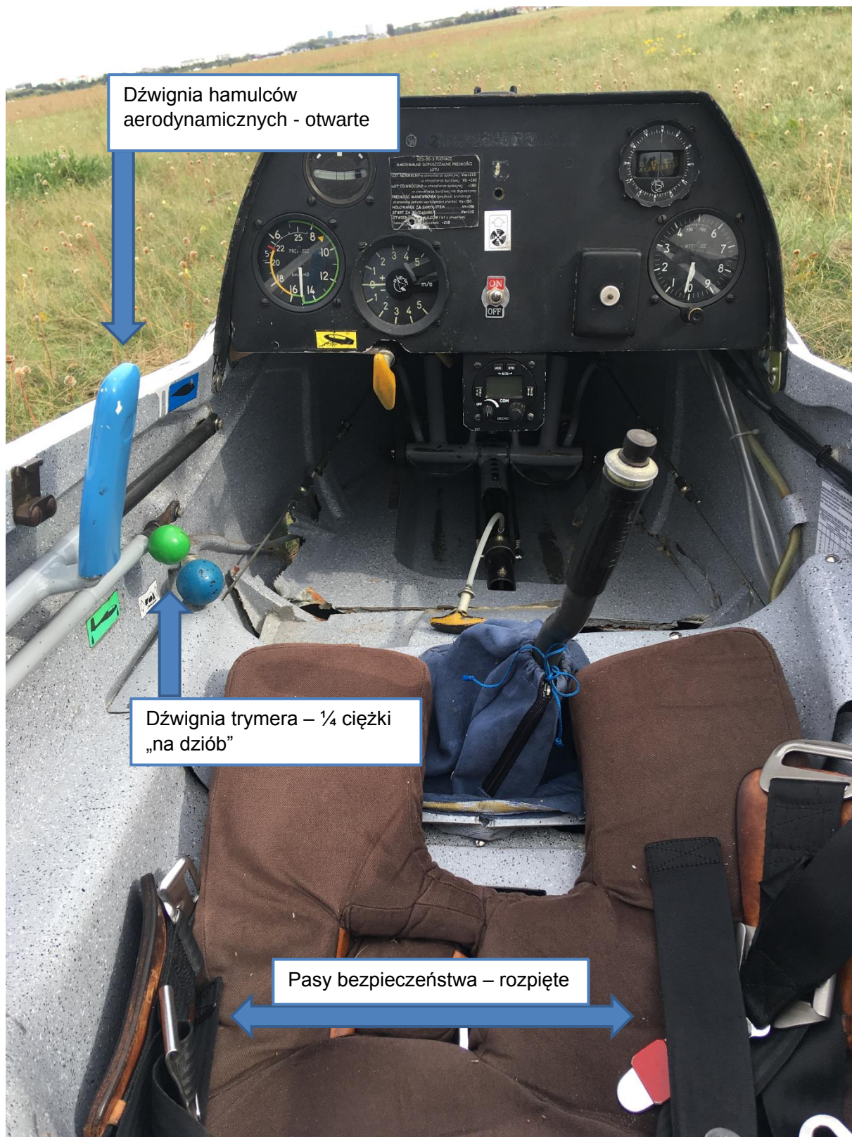
Rys. 11. Uszkodzona przednia kabina szybowca: wyłamana osłona drążka sterowego – zerwany w trakcie zdarzenia napęd połączenia lotek; ciągłość napędu steru wysokości zachowana; wyłamana przednia podłoga – w okolicy miejsca mocowania ciężarków aerodynamicznych; dźwignia hamulców aerodynamicznych – w pozycji „otwarte”, ciągłość napędu zachowana; dźwignia trymera – w pozycji ¼ ciężki na dziób, ciągłość napędu zachowana; pedały steru kierunku – bez widocznych uszkodzeń; pasy bezpieczeństwa – rozpięte, bez uszkodzeń
