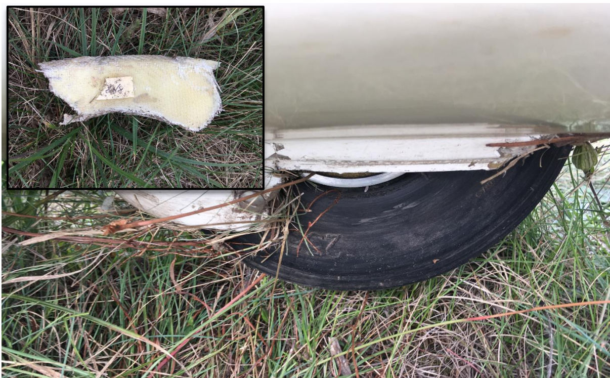
Rys. 14. Uszkodzona owiewka koła podwozia – koło tylne
