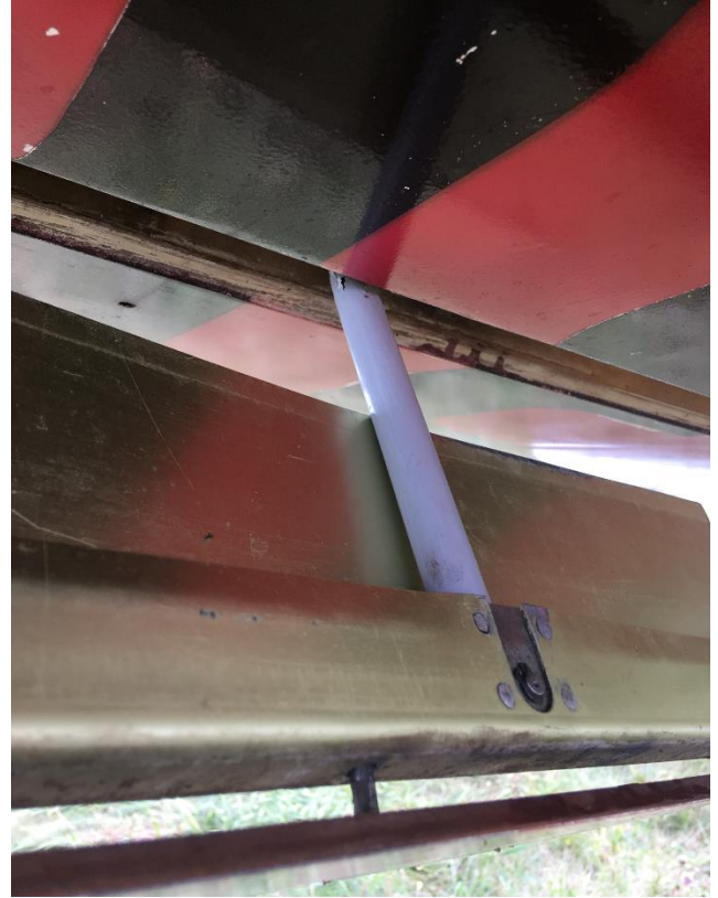
Rys. 18. Wyłamana dolna płyta hamulca aerodynamicznego lewego skrzydła – widok od tyłu, brak widocznych zanieczyszczeń
