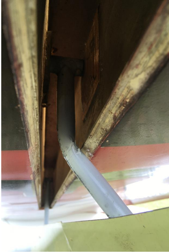
Rys. 17. Wyłamana dolna płyta hamulca aerodynamicznego lewego skrzydła – widok od dołu na skrzynkę hamulcową
