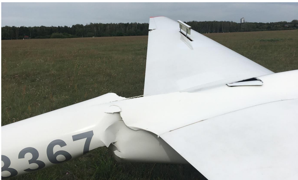
Rys. 10. Przełamany kadłub – widok od strony prawego skrzydła
