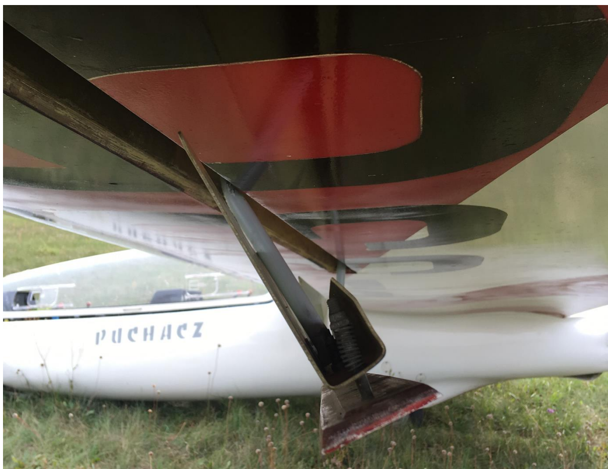
Rys. 16. Odształcone płyty hamulców na skrzydle lewym
