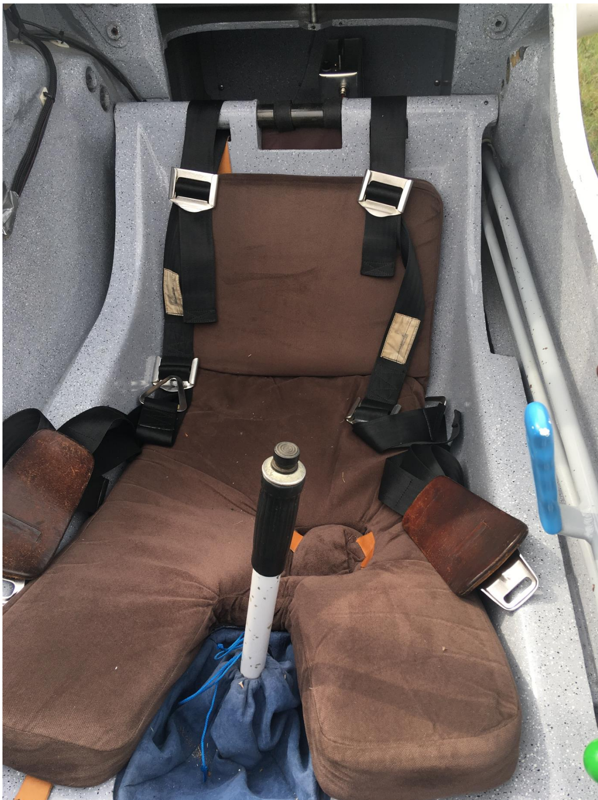
Rys. 12. Kabina tylna – ciągłość napędów zachowana, pasy bezpieczeństwa – rozpięte, bez uszkodzeń
