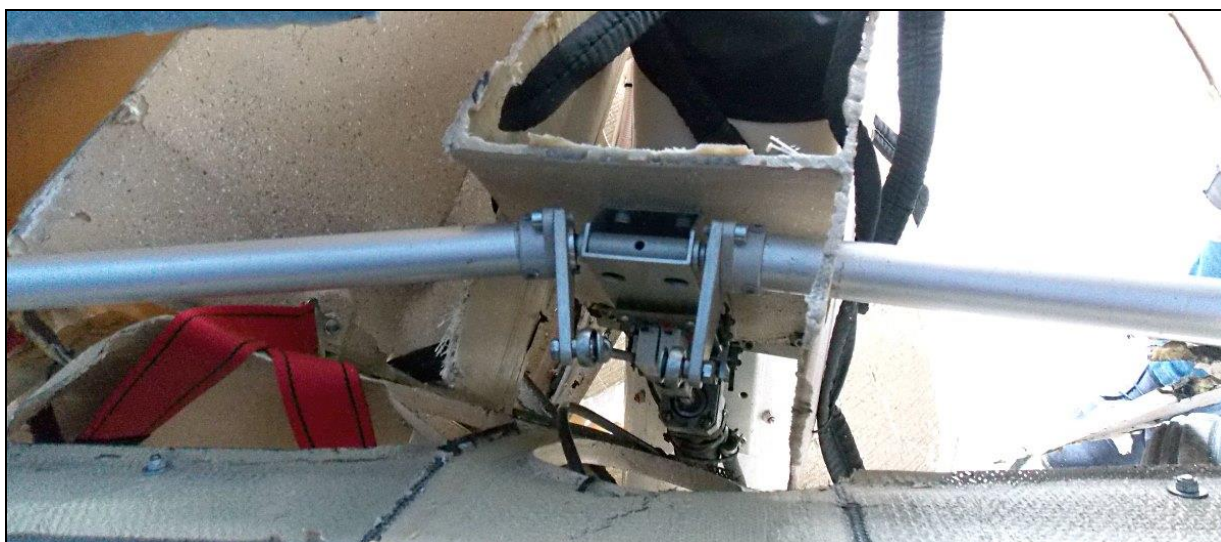
28 – Układ sterowania klapami – część centralna – widoczny elektromechanizm napędu i obie rury skrętne.
