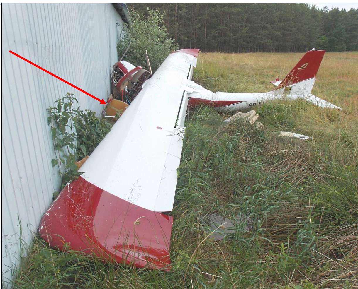
49 – Widok miejsca wypadku od strony wschodniej. Strzałka wskazuje lewy zbiornik paliwa [H], wyrwany z kadłuba.
