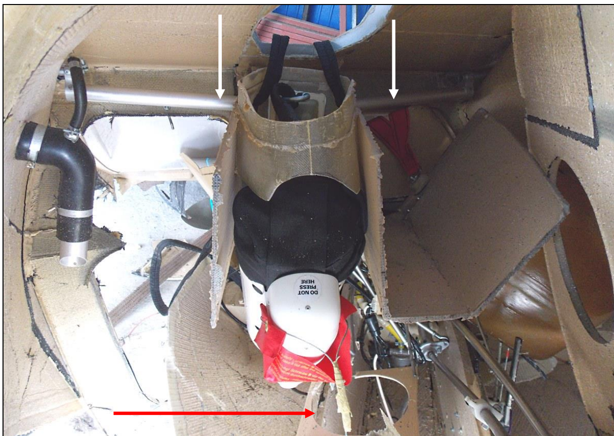
36 – Układ sterowania kłapami (białymi strzałkami zaznaczono rury skrętne) i pirotechniczny spadochronowy system ratowniczy Galaxy, widok od tyłu. Czerwoną strzałką zaznaczono wyrzół pod zasobnik spadochronu.
