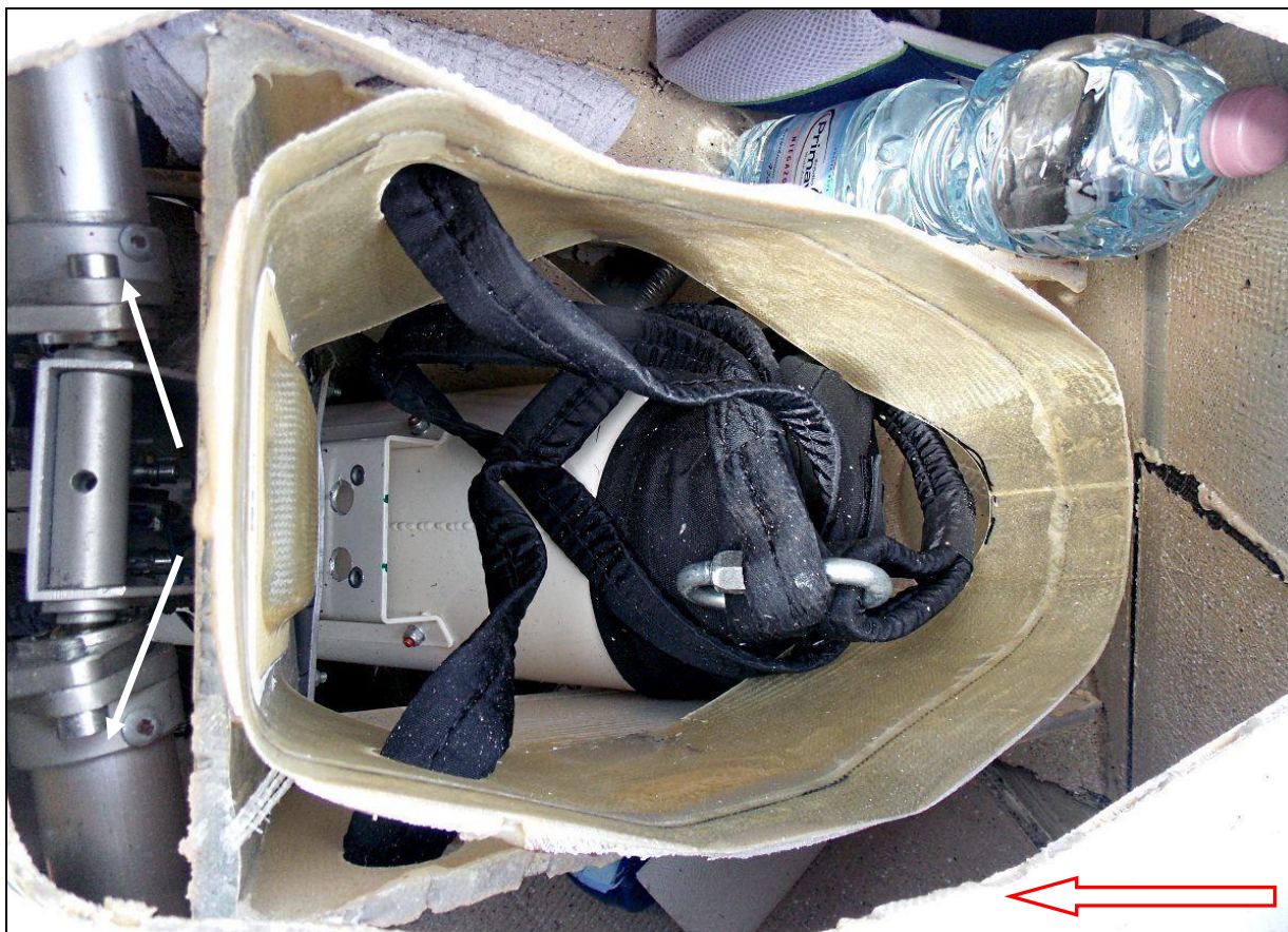
35 – Luk spadochronowego systemu ratowniczego w górnym pokryciu skrzydła i jego wnętrze. Dobrze widoczny zasobnik spadochronu ratowniczego. Czerwoną strzałką zaznaczono kierunek lotu, białymi – rury skrętne systemu sterowania kłapami.
