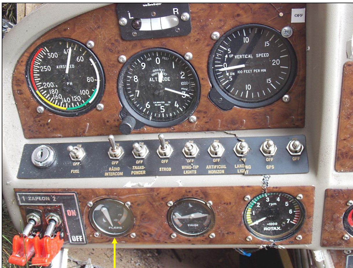
18 – Lewa część tablicy przyrządów, Widoczny wskaźnik położenia klap, pokazujący wychylenie przekraczające maksymalne.
