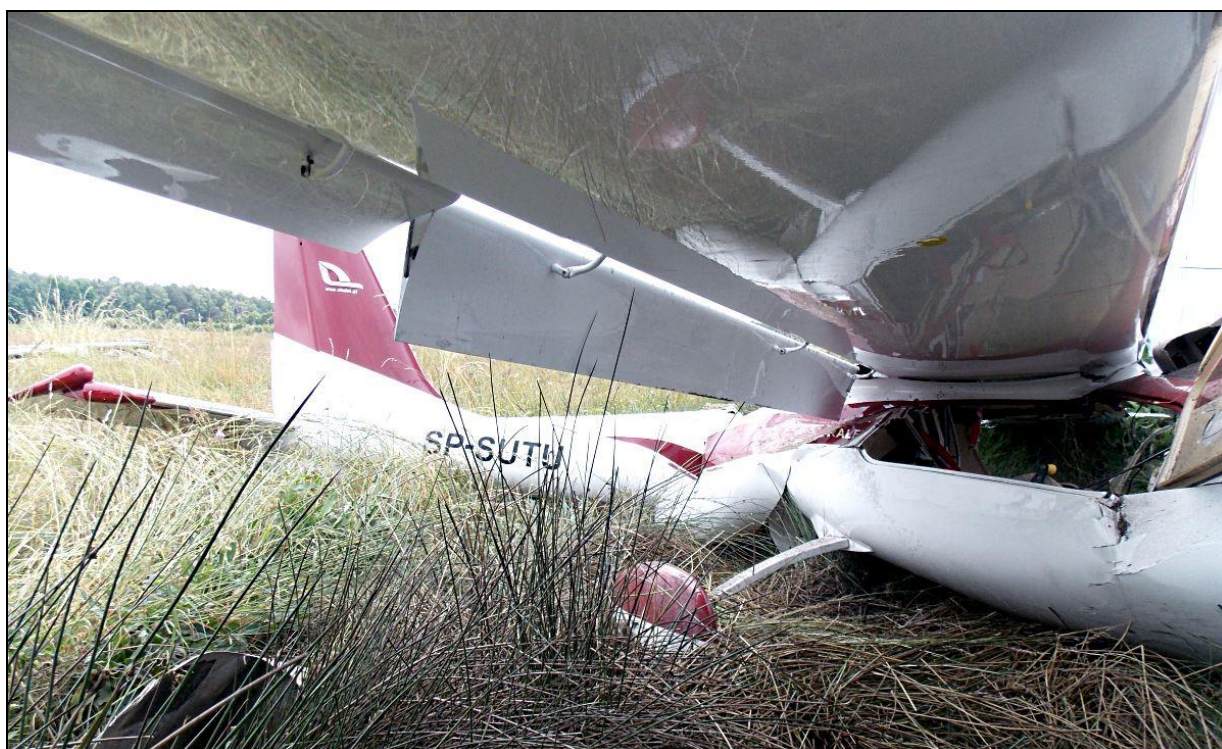
12 – Widok na kadłub spod prawego skrzydła – widoczne zniszczenia kabinowej części kadłuba i przełom belki kadłuba za skrzydłami. Zwraca uwagę kąt wychylenia kłapy skrzydłowej.
