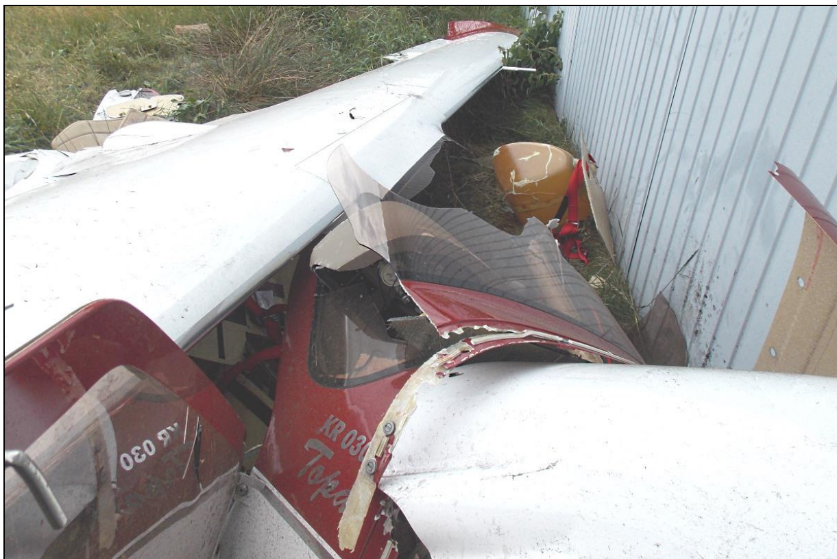
15 – Zbliżenie z prawej strony na przód zniszczonej kabinowej części kadłuba. Na dalszym planie widoczny lewy zbiornik paliwa, który został wyrwany z kadłuba.
