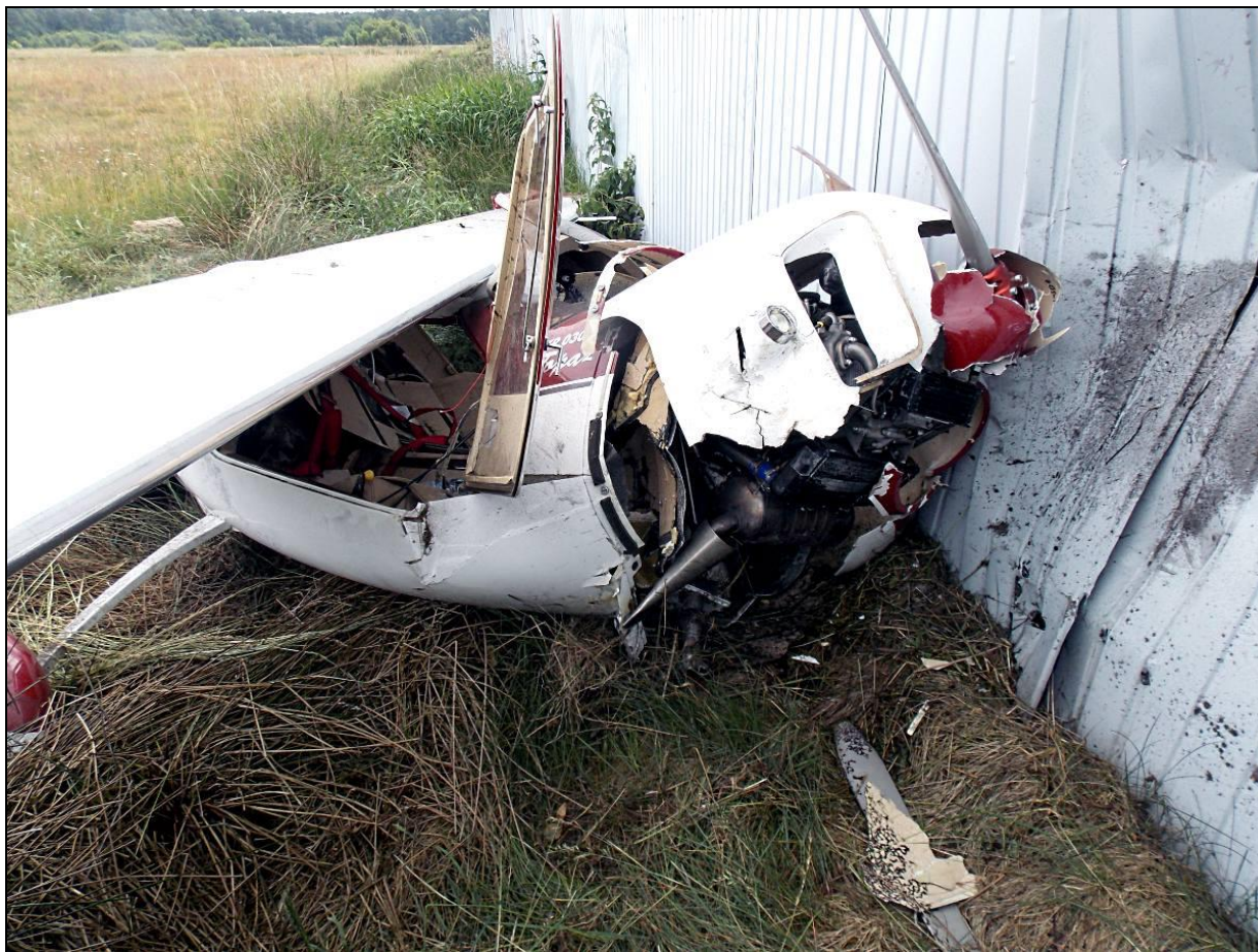
14 – Miejsce uderzenia przednią częścią kadłuba w ścianę hangaru – zbliżenie z prawej strony. Widoczne zniszczone śmigło.
