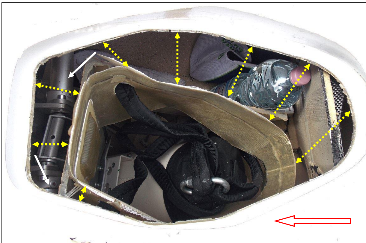
34 – Łuk spadochronowego systemu ratowniczego w górnym pokryciu skrzydła i jego wnętrzu. Strzałkami żółtymi wskazano miejsca wykonanych „na styk” sklejin elementów kompozytowych. Czerwoną strzałką zaznaczono kierunek lotu, białymi – rury skrętne sterowania klapami.
