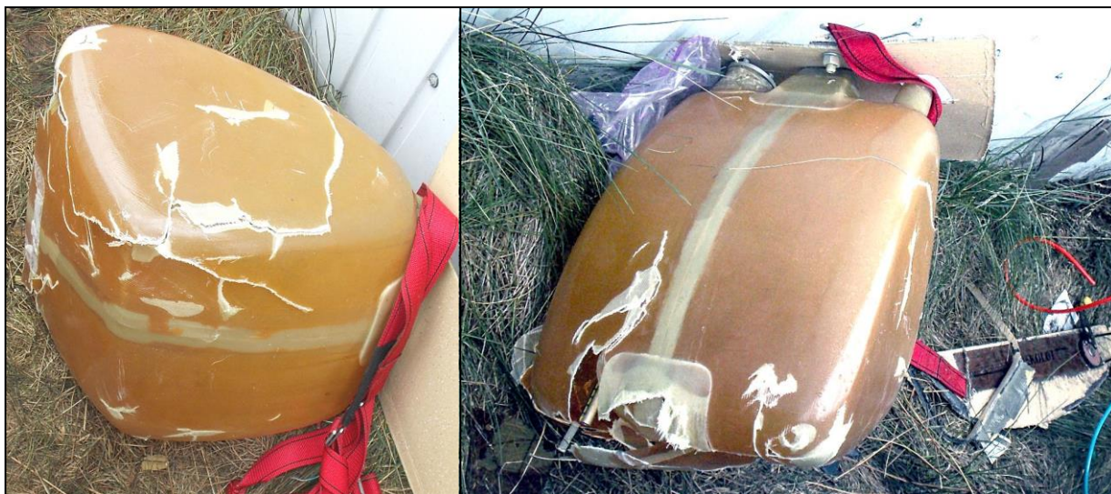
47, 48 – Lewy zbiornik paliwa [H], pęknięty i wyrwany z wnętrza kadłuba podczas zderzenia z ziemią.
