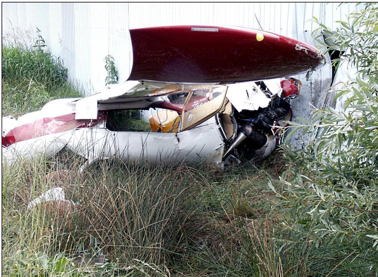
11 – Miejsce uderzenia silnikiem w ścianę hangaru – widok spod prawego skrzydła. Widoczna zniszczona kabinowa część kadłuba. Obok kadłuba z lewej strony zerwana owiewka lewego koła podwozia głównego [G].
