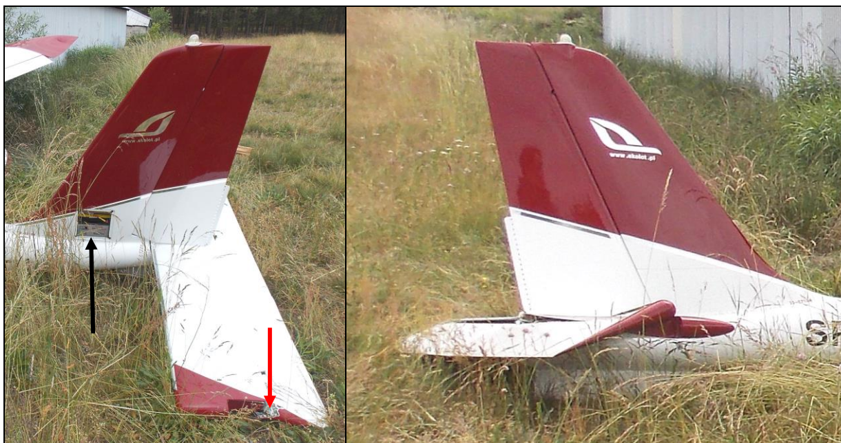
39, 40 – Usterzenie samolotu z obu stron. Widoczny luk akumulatora i urwane lewe wyważenie steru wysokości.
