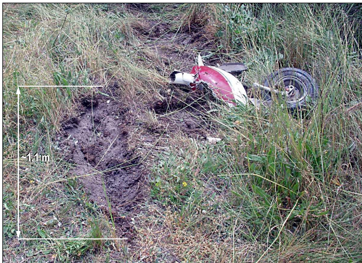
8 – Ślad łamania lewego głównego podwozia [D] o długości ok. 1,1 m oraz wyłamane przednie podwozie i jego owiewka [E].
