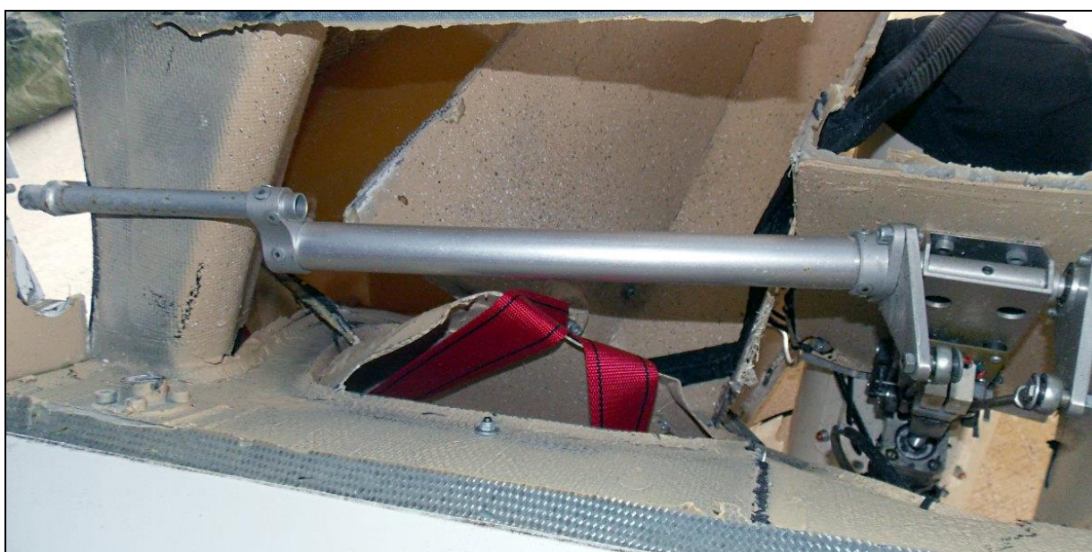
29 – Układ sterowania klapami – prawa rura skrętna.
