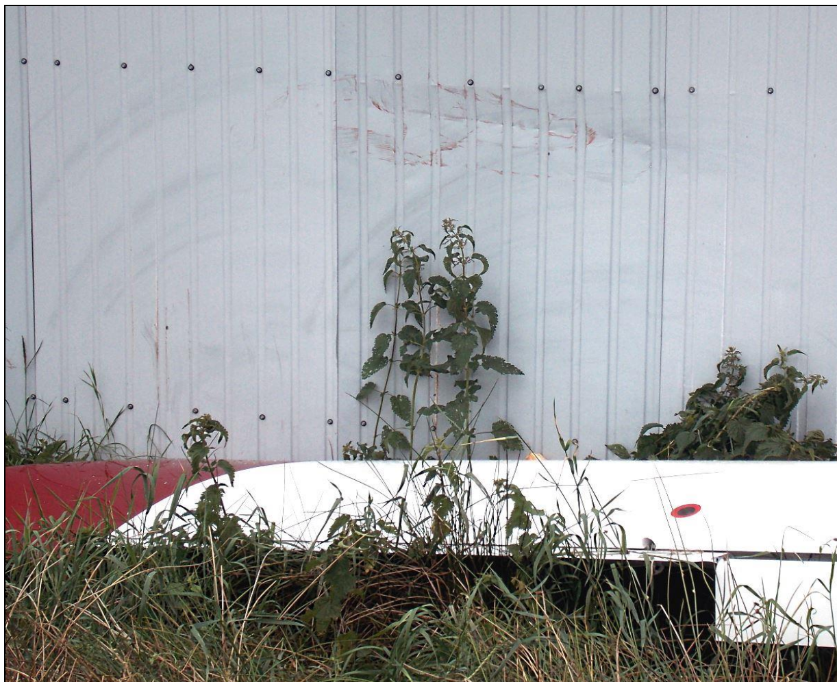
52 – Lewe skrzydło i ślad jego uderzenia na ścianie hangaru
