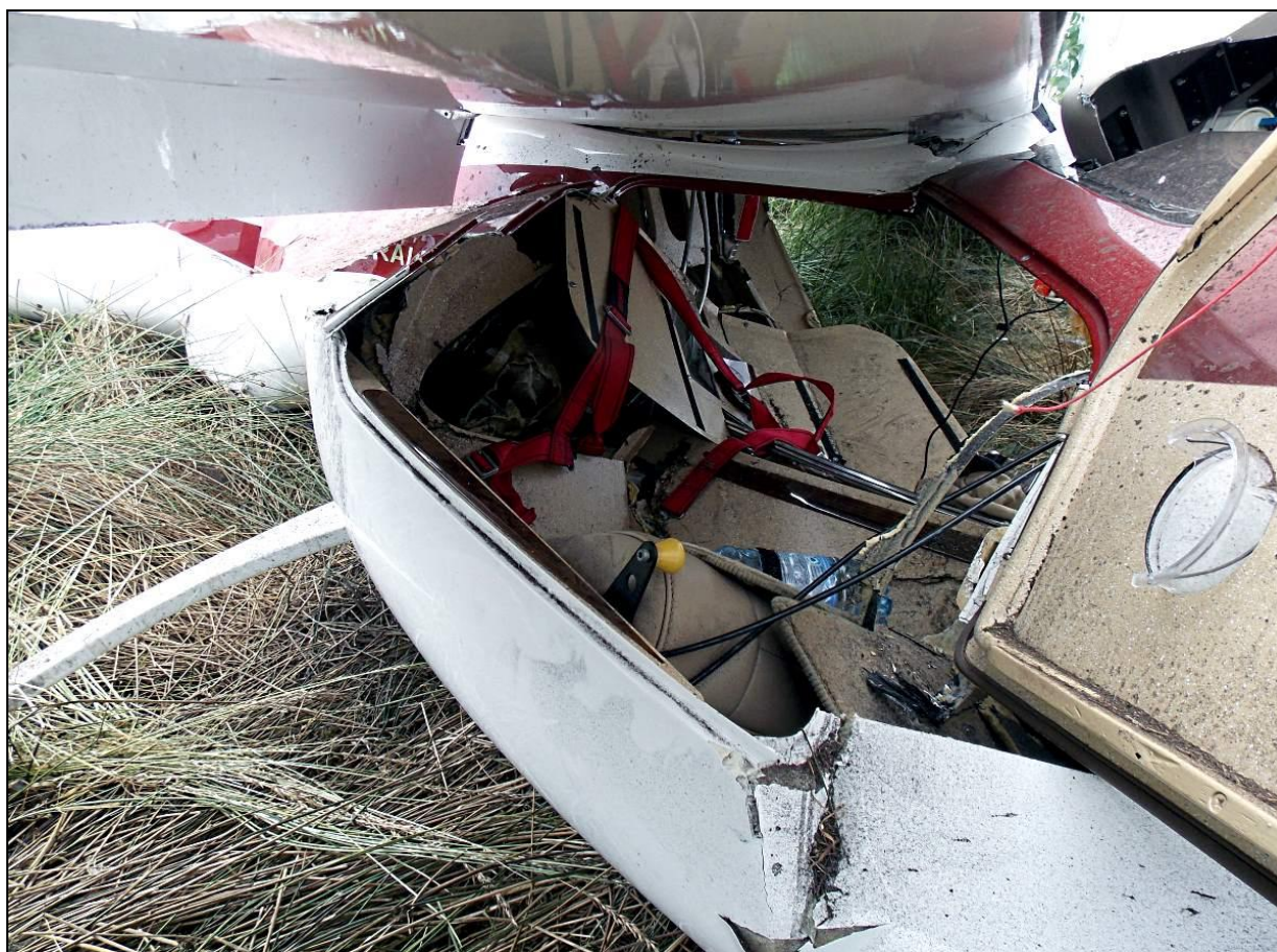
13 – Zniszczona kabinowa część kadłuba – widok ogólny wnętrza kabiny z prawej strony.
