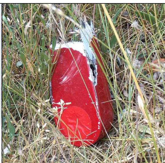
42 – Urwane lewe wyważenie steru wysokości [F].
