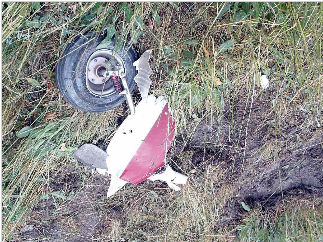
9 – Wyłamane przednie podwozie i jego zniszczona owiewka [E] – zbliżenie.
