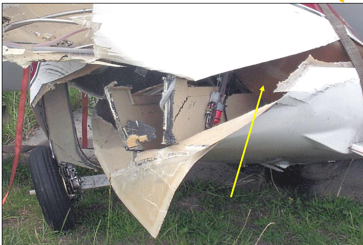
44 – Zbliżenie fragmentu fot.[37]. Strzałką zaznaczony prawy zbiornik paliwa w kadłubie.
