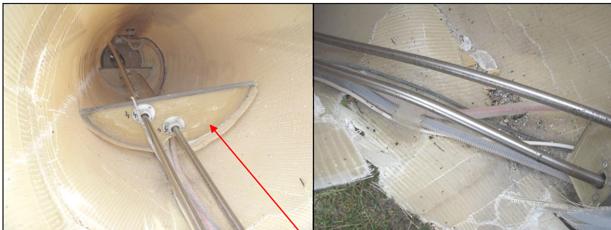
54, 55 – Wnętrze belki kadłubowej, widoczna odklejona półwrga i zniszczone, pogieęte popychacze sterowania.
