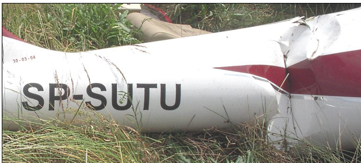
53 – Belka kadłubowa z prawej strony – dobrze widoczny przełom.
