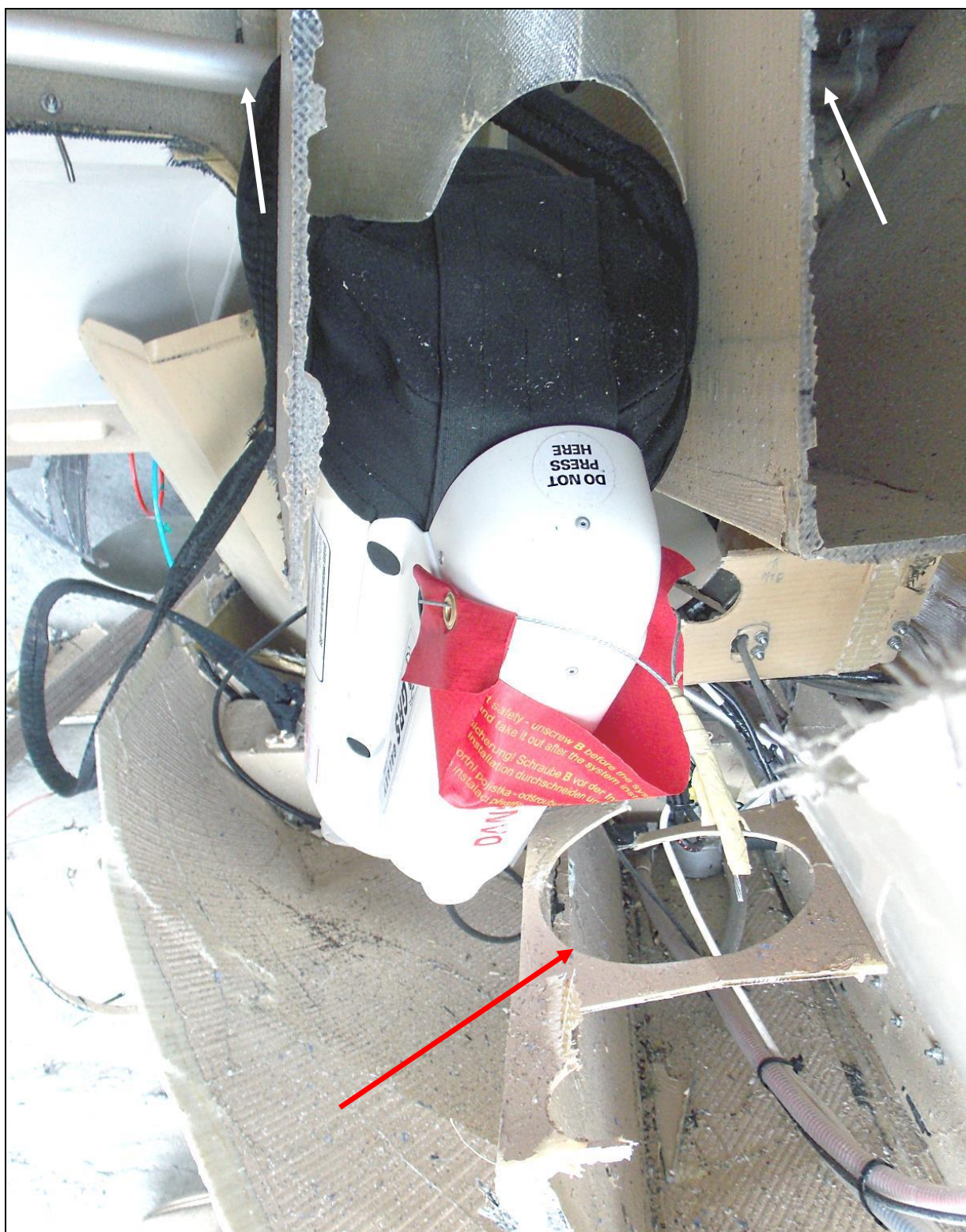
37 – Układ sterowania klapami (białymi strzałkami zaznaczono rury skrętne) i pirotechniczny spadochronowy system ratowniczy Galaxy, widok od tyłu. Czerwoną strzałką zaznaczono wykrój pod zasobnik spadochronu.
