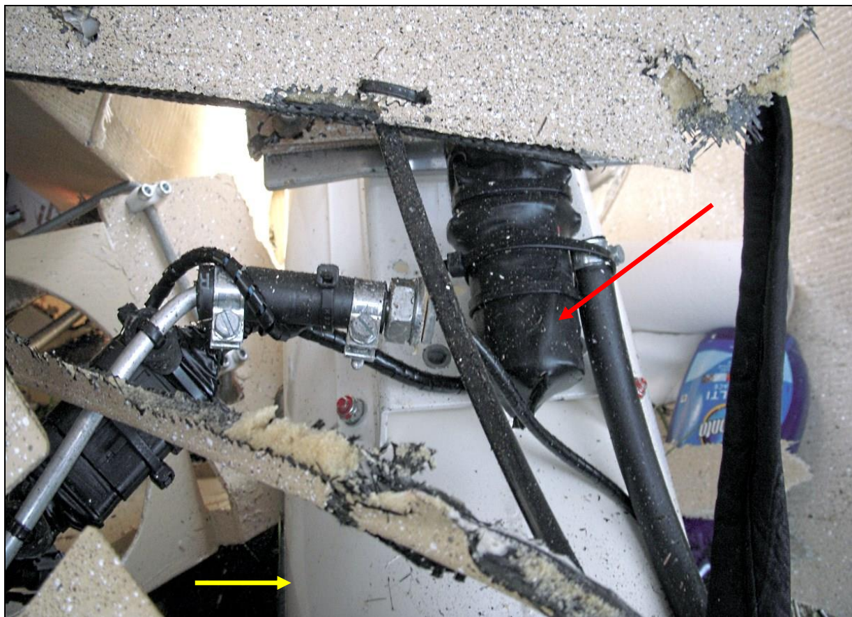
25 – Zbliżenie na elektromechanizm sterowania klapami (strzałka czerwona) i zasobnik spadochronowego systemu ratowniczego (strzałka żółta).
