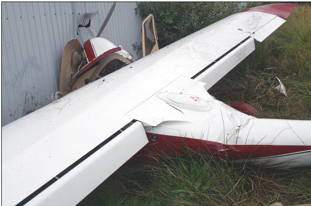
50 – Widok miejsca wypadku od strony wschodniej – zbliżenie pokazujące przełom kadłuba za skrzydłami.
