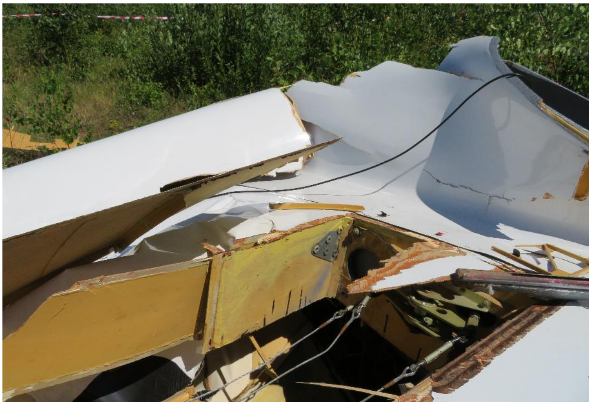
Rys. 6. Zerwane pokrycie prawego skrzydła
