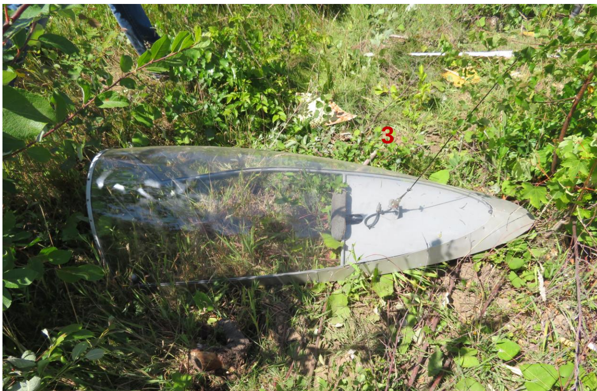
Rys. 4.2. Nieuszkodzona osłona drugiej kabiny – wyrwana w trakcie upadku
