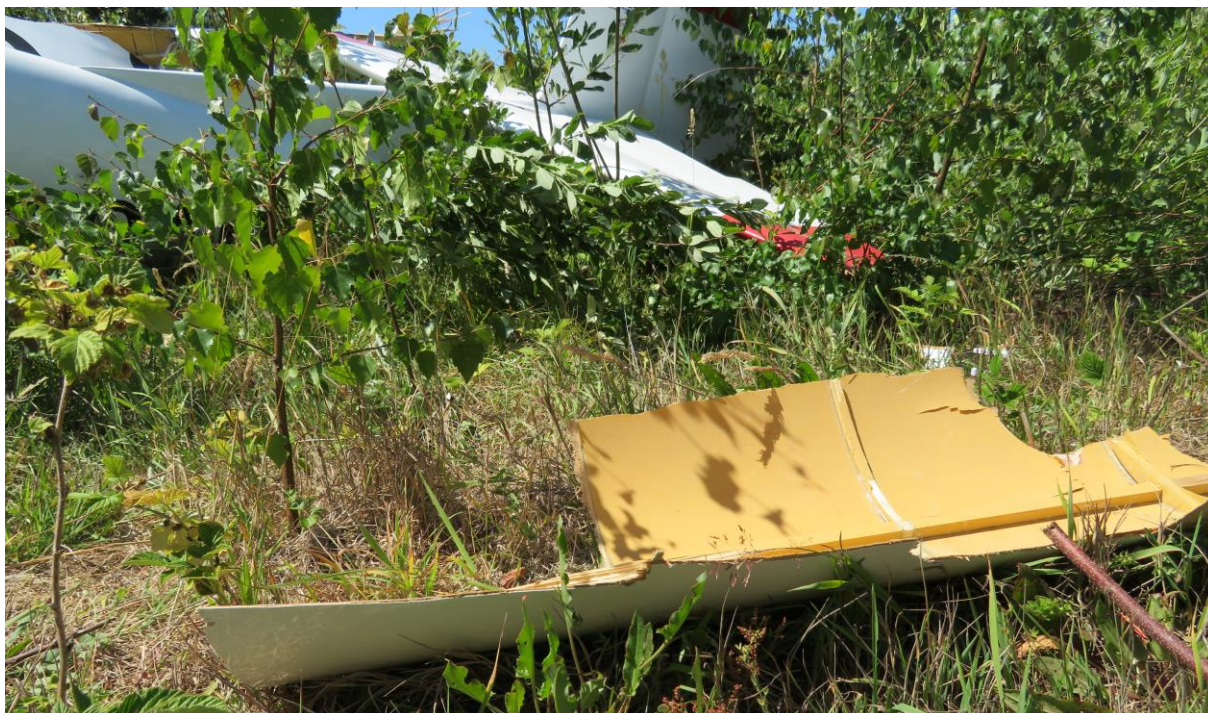
Rys. 4.5. Fragment pokrycia kadłuba
