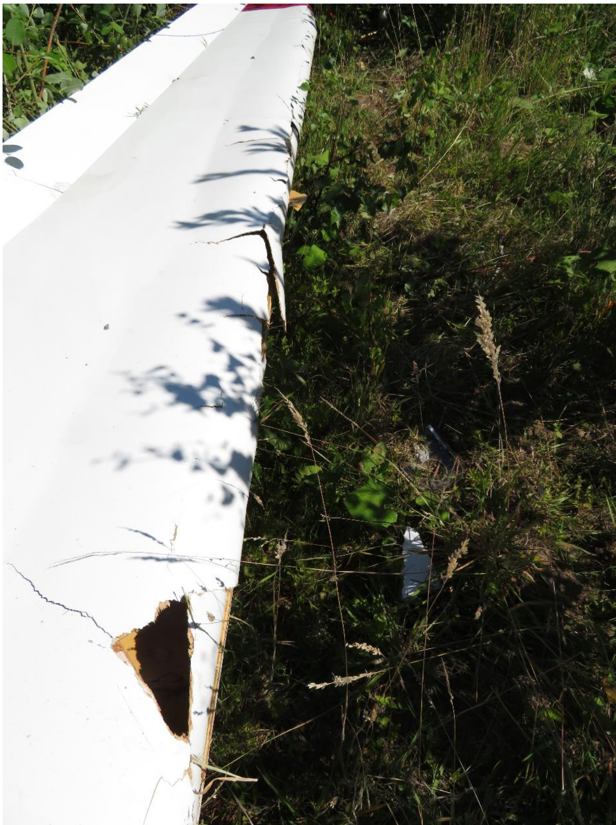
Rys. 11. Częściowo zniszczone skrzydło lewe – widok od strony przykadłubowej
