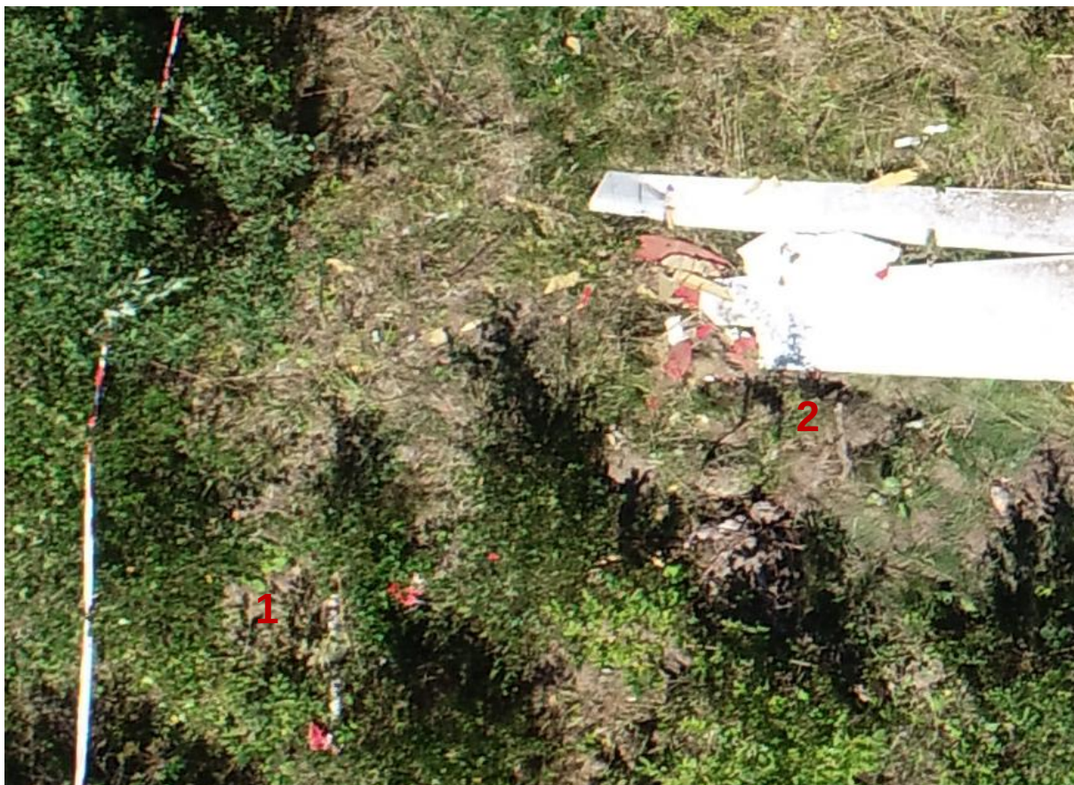
Rys. 4.1. Szczątki prawej końcówki skrzydła – rozrzucone fragmenty płóty w kolorze czerwonym
