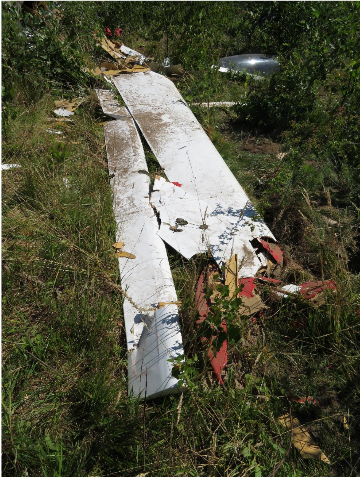
Rys. 10. Całkowicie zniszczone skrzydło prawe – widok od końcówki
