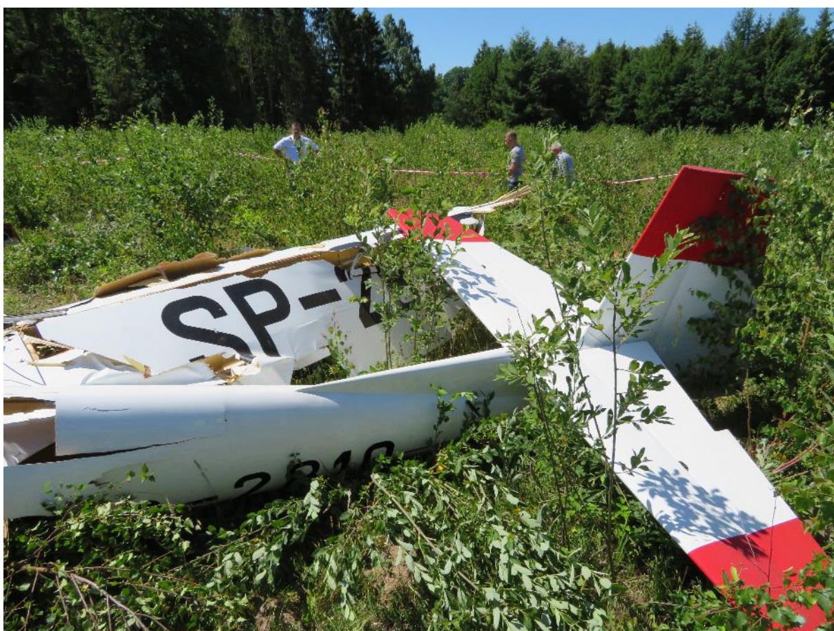
Rys. 5. Widok od tyłu – uszkodzony ogon i zniszczone skrzydło prawe
