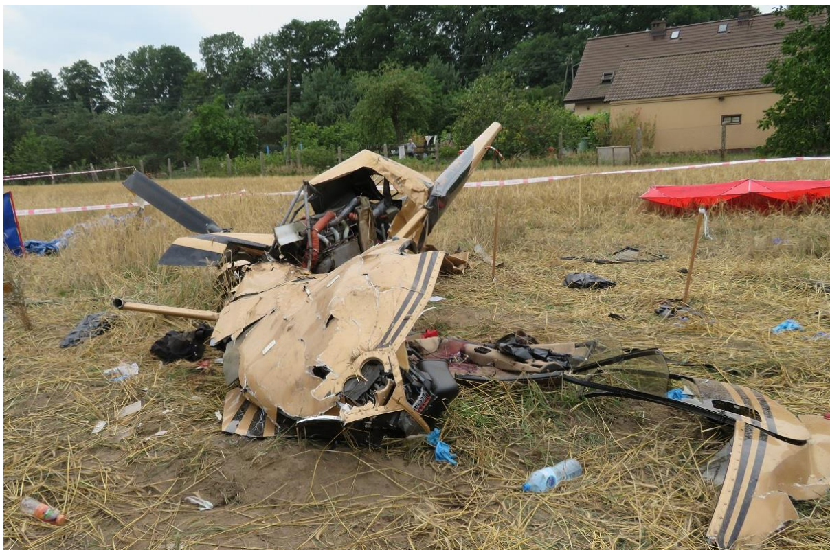
Rys. 3 Wrak śmigłowca Robinson R-44 na miejscu wypadku – widok od przodu kadłuba.
