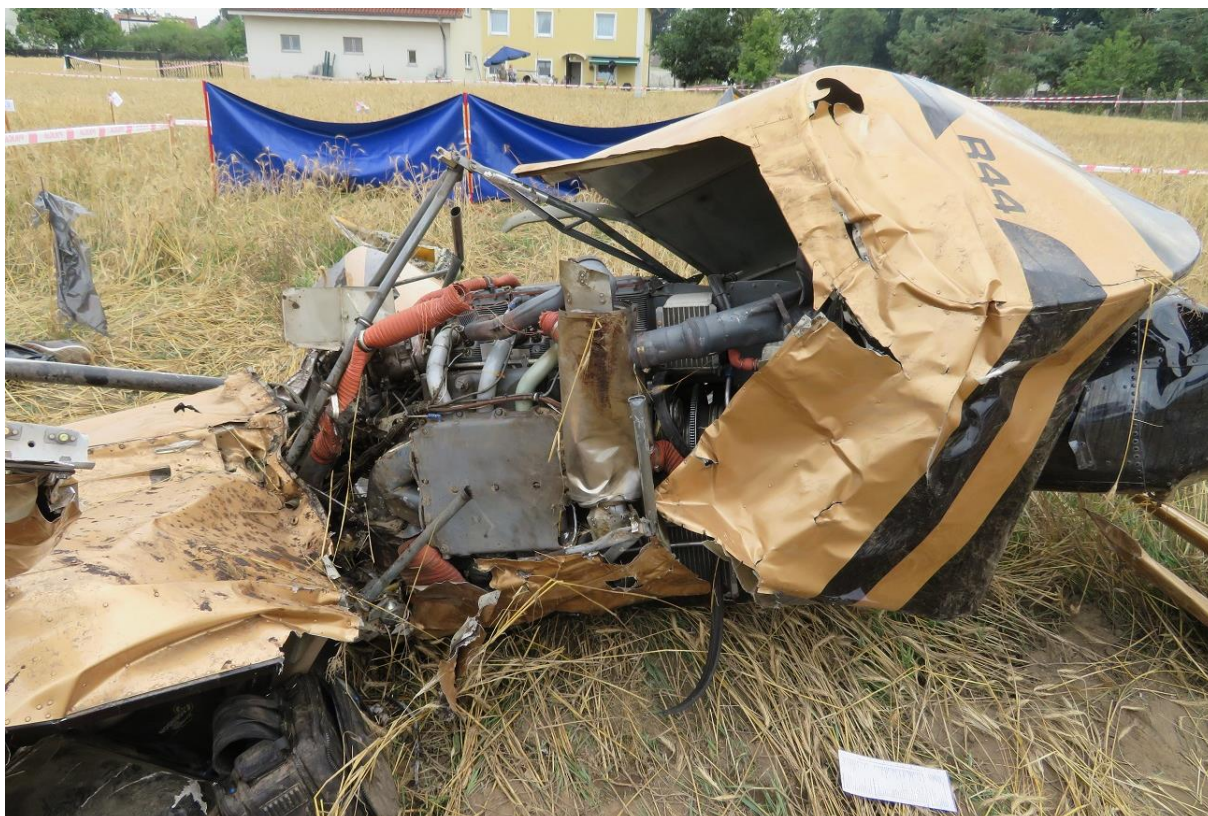
Rys. 5. Wrak śmigłowca Robinson R-44 na miejscu wypadku – widok na tylną część kadłuba.
