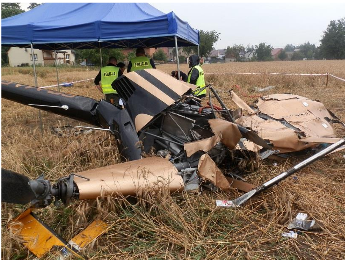
Rys. 6. Wrak śmigłowca Robinson R-44 na miejscu wypadku – widok na górną część kadłuba.
