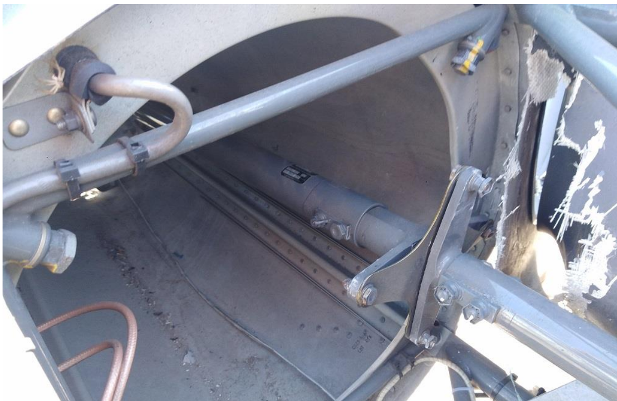
Rys. 23. Wrak śmigłowca Robinson R-44 – widoczne zachowane przeguby przednie wału napędu śmigła ogonowego.
