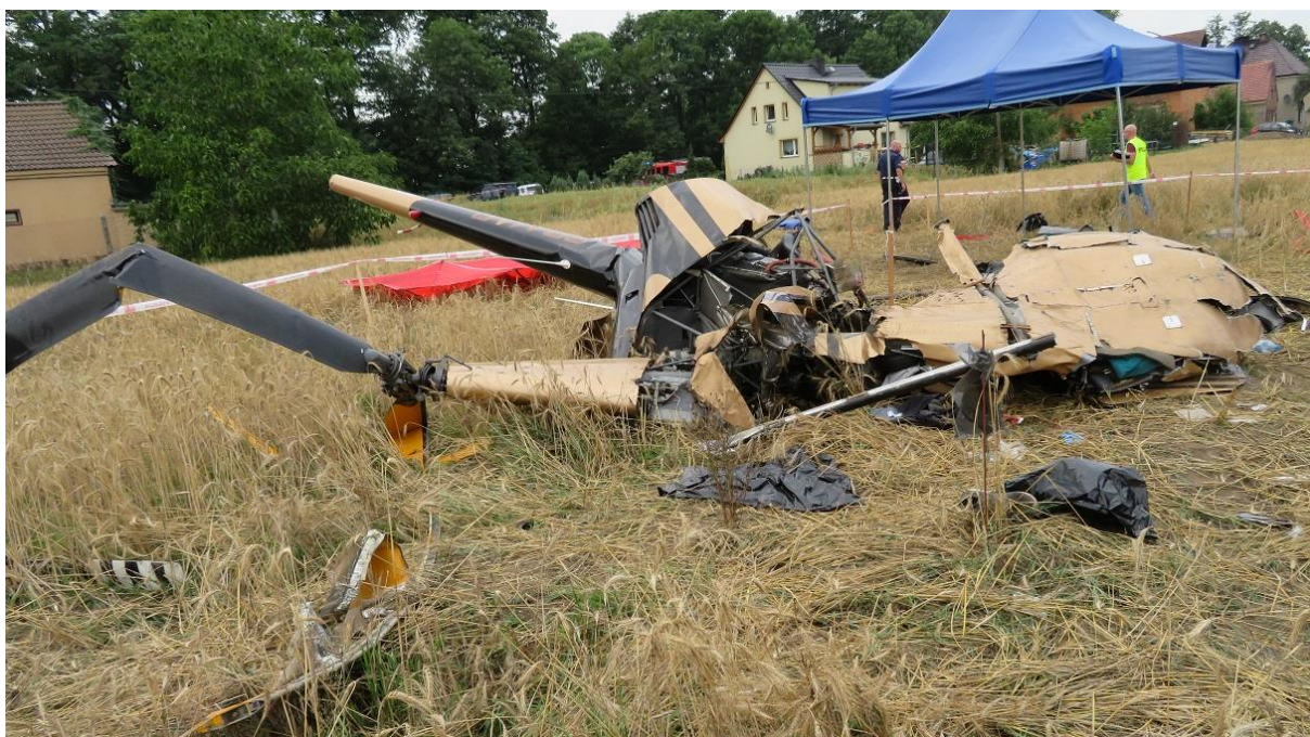
Rys. 4. Wrak śmigłowca Robinson R-44 na miejscu wypadku – widok od spodu kadłuba śmigłowca.
