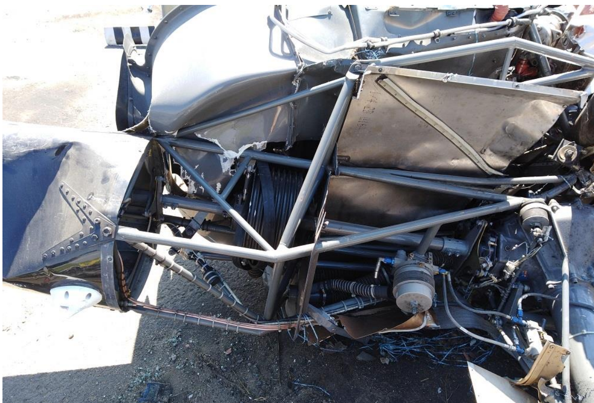
Rys. 18. Wrak śmigłowca Robinson R-44 – widoczna przekładnia pasowa układu napędowego.
