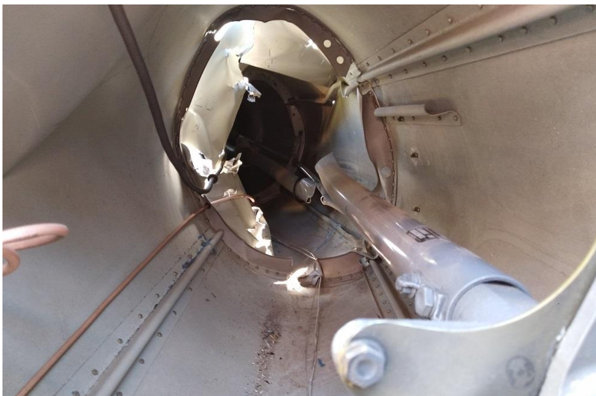
Rys. 26. Wrak śmigłowca Robinson R-44 – przełamany podczas zderzenia z ziemią wał śmigła ogonowego wewnątrz belki ogonowej śmigłowca.
