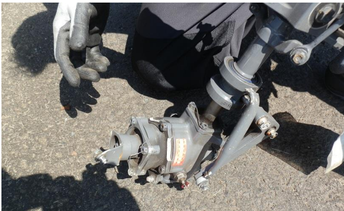
Rys. 30. Wrak śmigłowca Robinson R-44 – przekładnia kątowa śmigła ogonowego oraz układ sterownia skokiem śmigła ogonowego.
