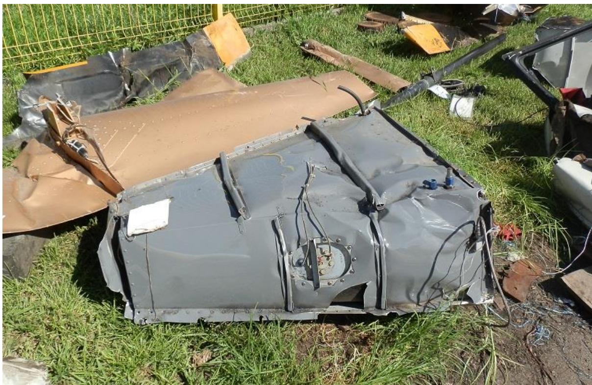
Rys. 32. Wrak śmigłowca Robinson R-44 - zbiornik paliwa z membraną uszczelniającą widoczną w miejscu jego uszkodzenia.
