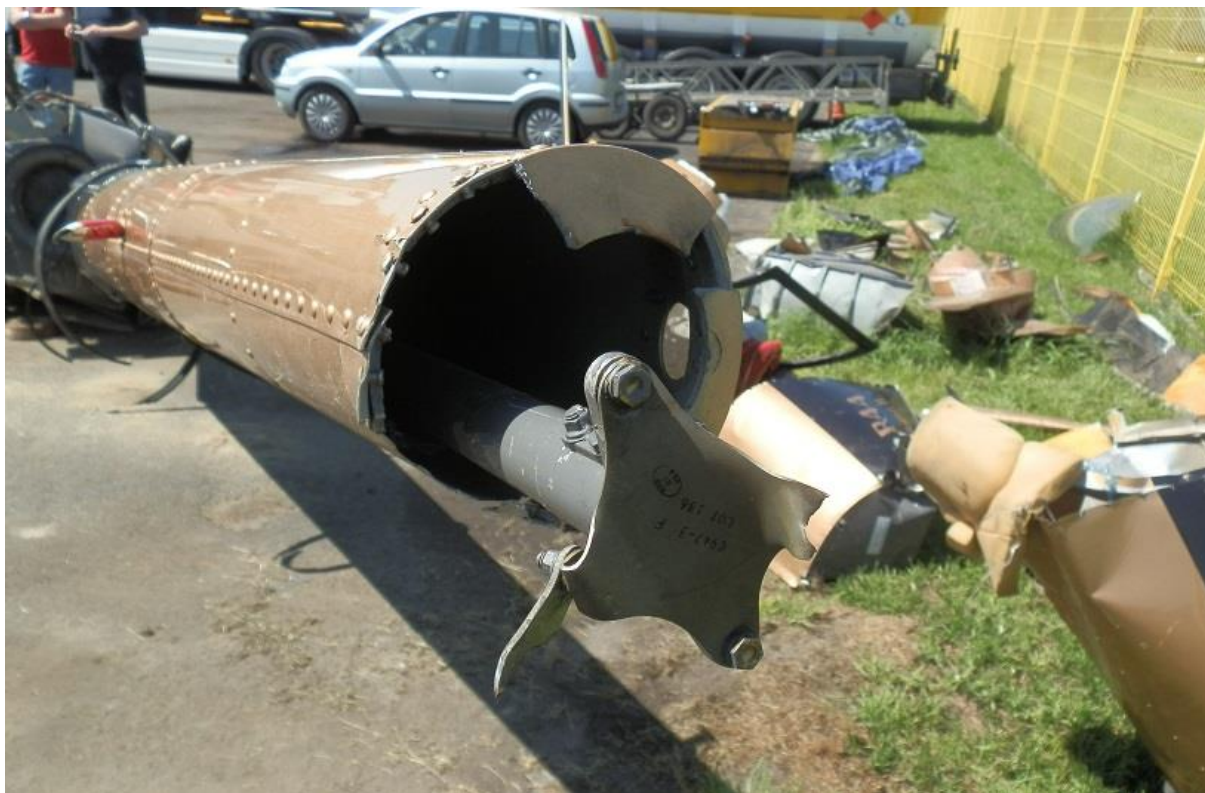
Rys. 25. Wrak śmigłowca Robinson R-44 – widoczne przełamane podczas zderzenia z ziemią przeguby tylne wału śmigła ogonowego.
