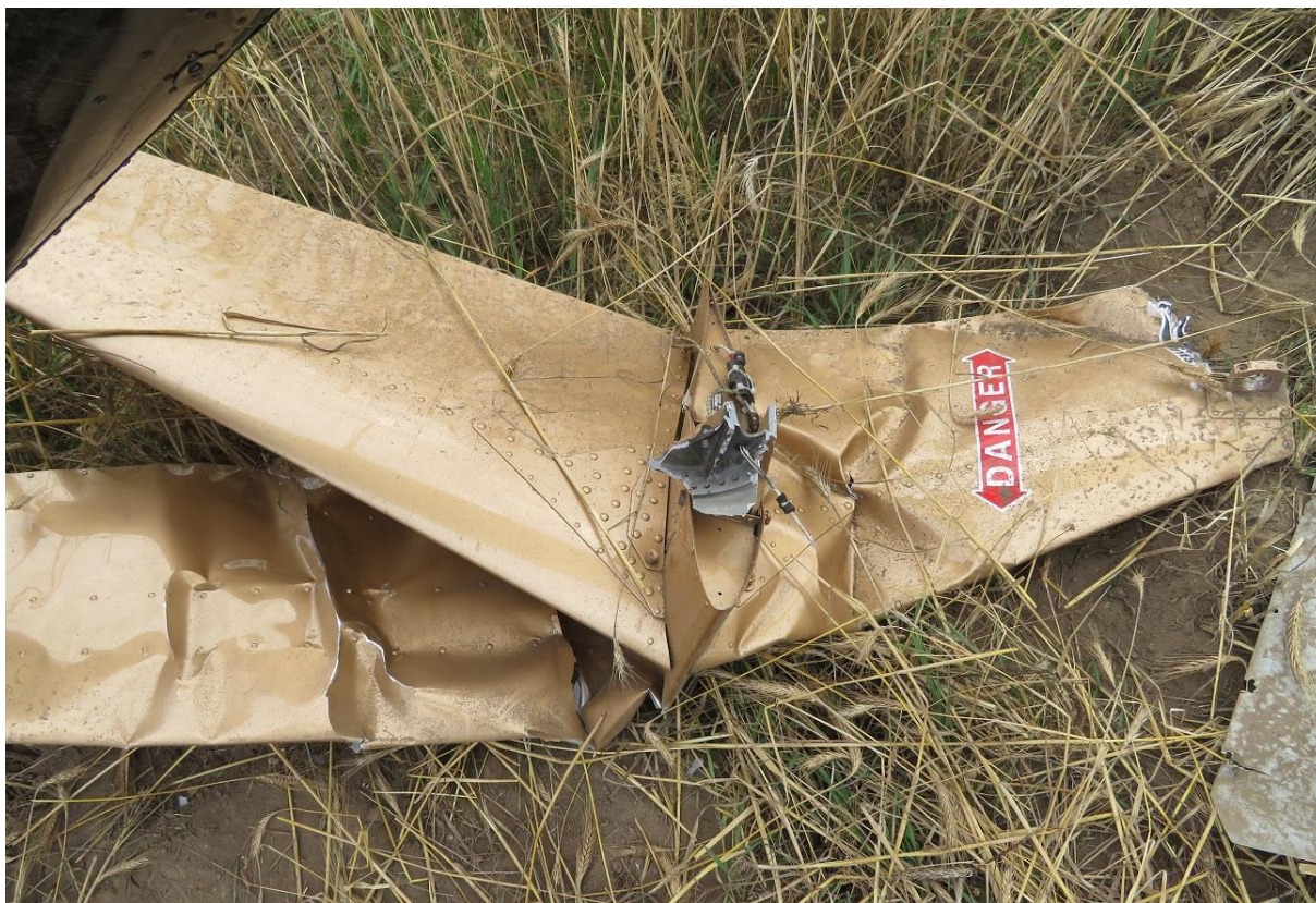
Rys. 11. Wrak śmigłowca Robinson R-44 na miejscu wypadku – oderwany statecznik belki ogonowej.
