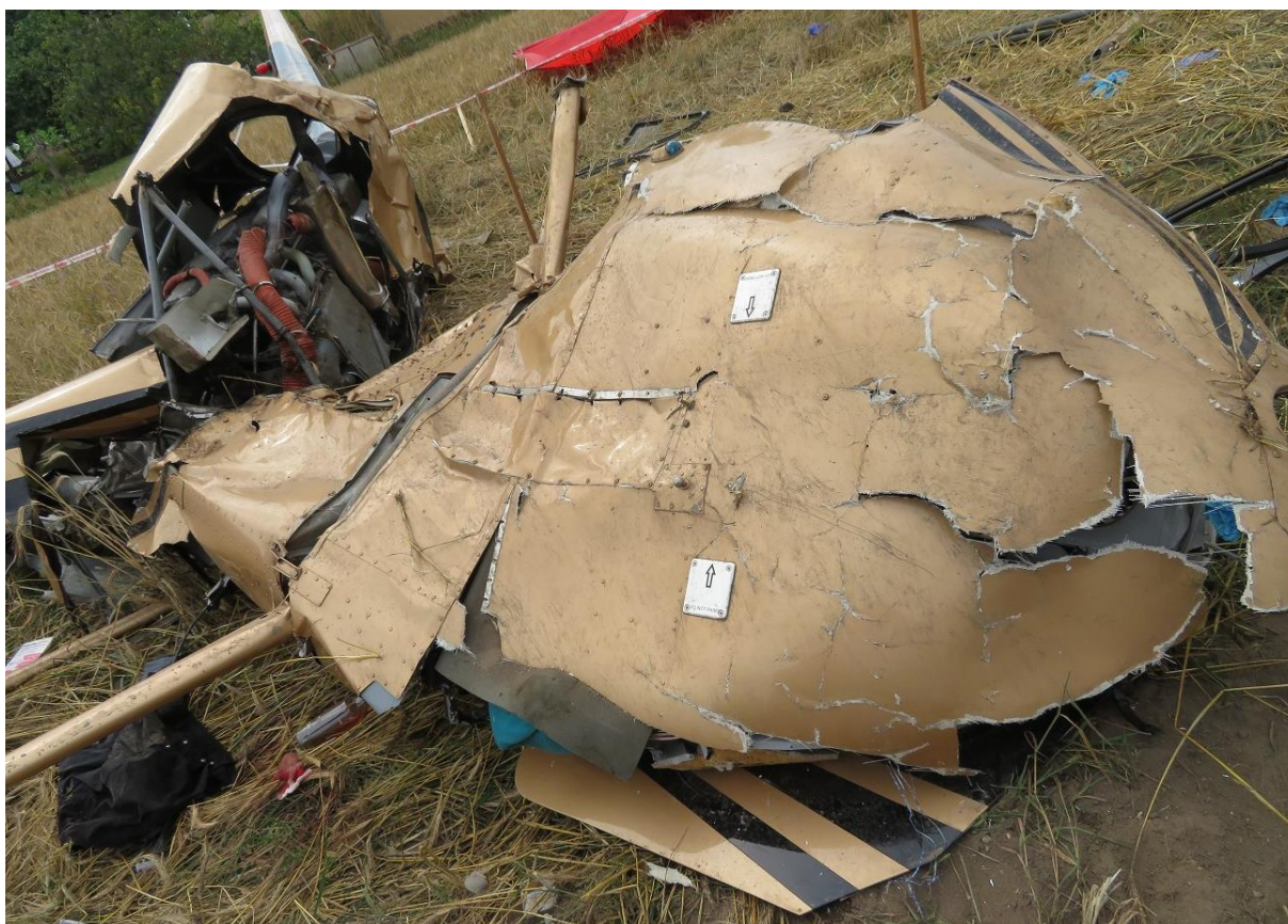
Rys. 10. Wrak śmigłowca Robinson R-44 na miejscu wypadku – widok od spodu kabiny.
