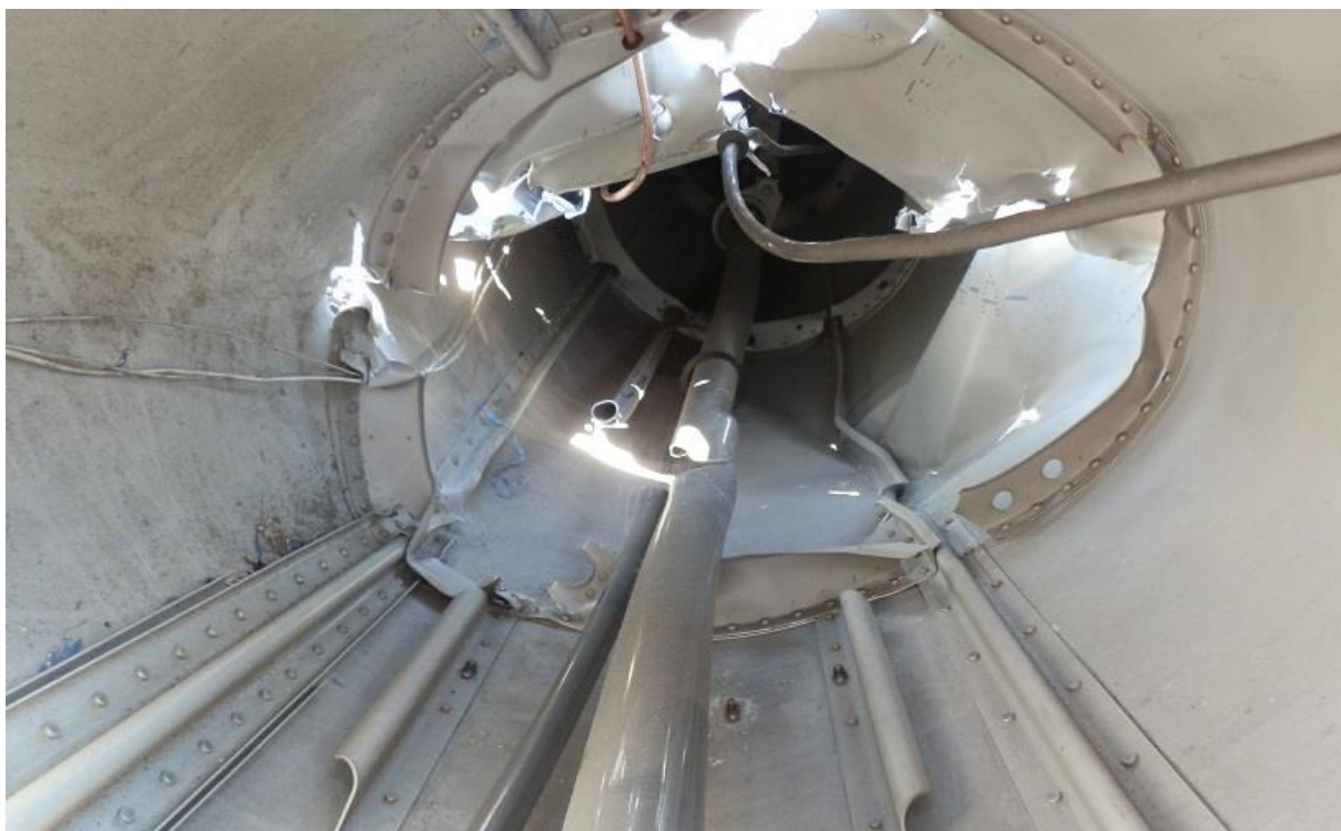
Rys. 28. Wrak śmigłowca Robinson R-44 – przełamany podczas zderzenia z ziemią wał śmigła ogonowego wewnątrz belki ogonowej śmigłowca.
