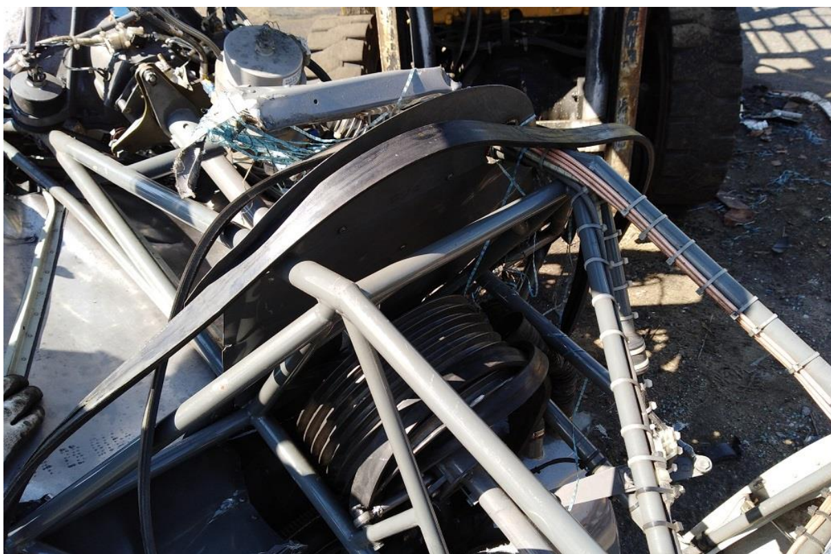
Rys. 22. Wrak śmigłowca Robinson R-44 – widoczna przekładnia pasowa śmigłowca.
