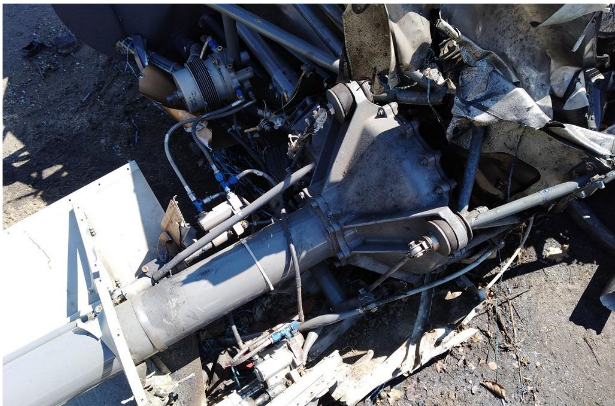
Rys. 19. Wrak śmigłowca Robinson R-44 – widoczna przekładnia główna oraz popychacze głowicy.
