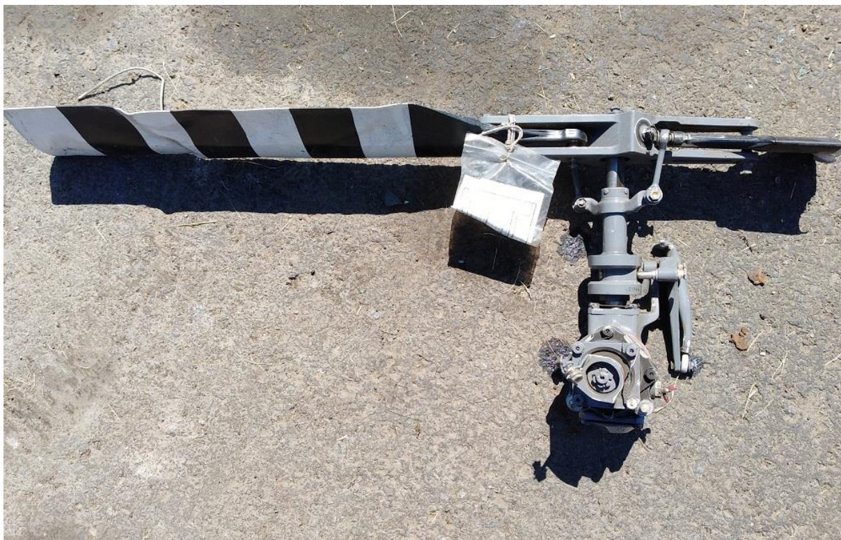
Rys. 29. Wrak śmigłowca Robinson R-44 – śmigło ogonowe wraz z przekładnią kątową.
