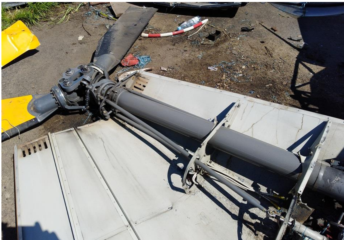
Rys. 20. Wrak śmigłowca Robinson R-44 – widok wału wirnika głównego w obudowie wraz z popychaczami głowicy wirnika głównego.
