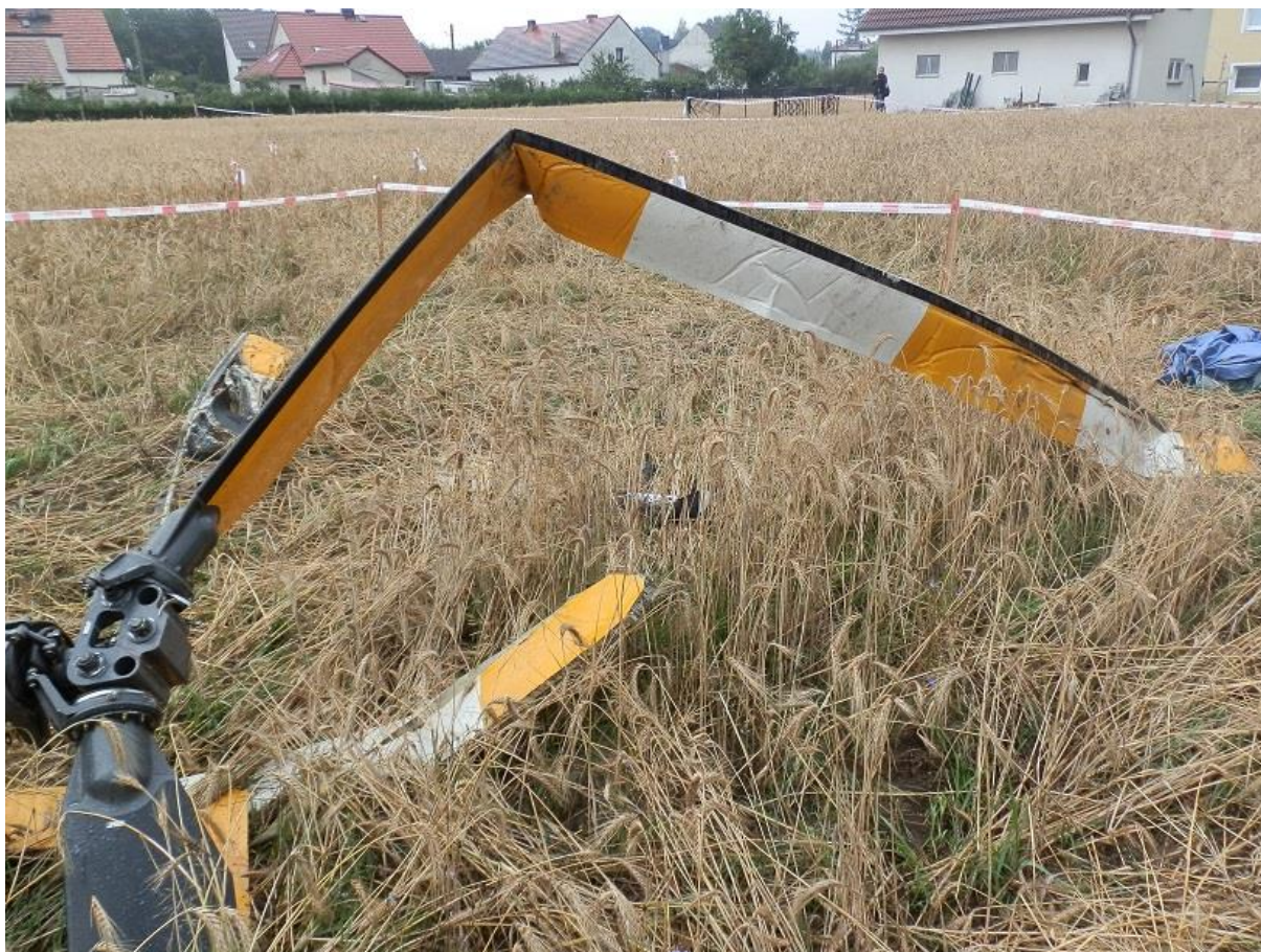
Rys 7. Wrak śmigłowca Robinson R-44 na miejscu wypadku – przełamana łopata wirnika głównego.
