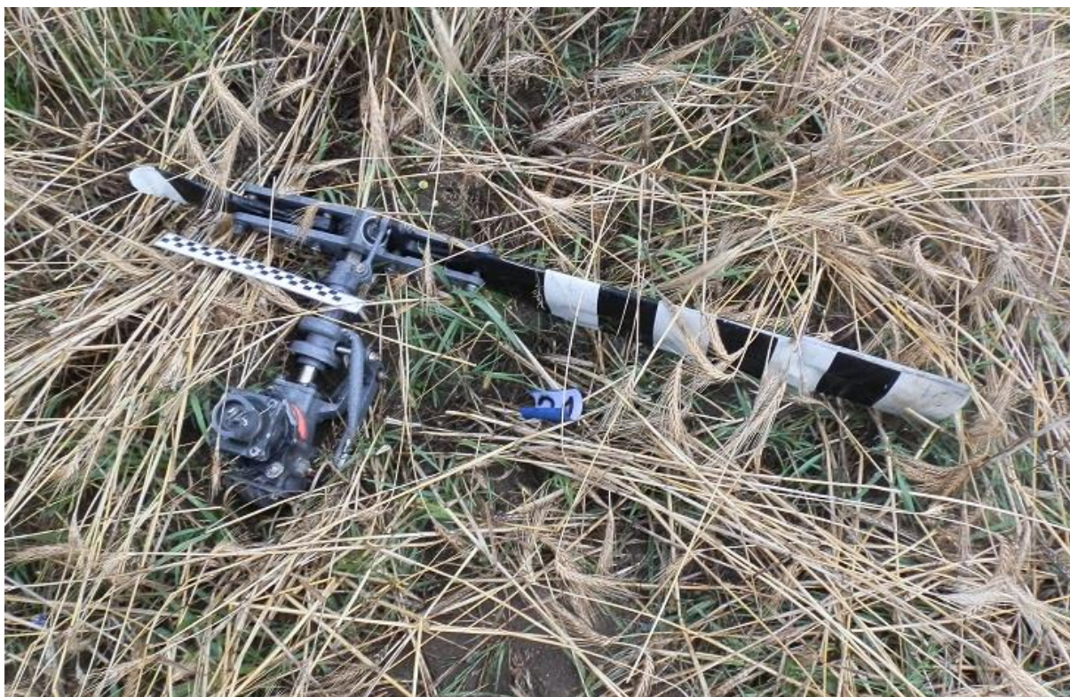
Rys. 8. Wrak śmigłowca Robinson R-44 na miejscu wypadku – śmigło ogonowe wraz z przekładnią.
