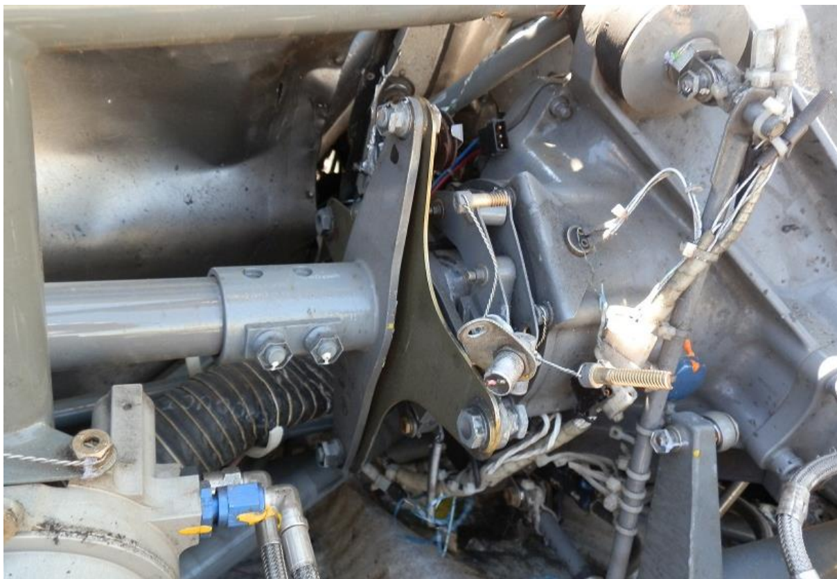
Rys. 27. Wrak śmigłowca Robinson R-44 – zachowana ciągłość kinematyki układu napędowego przy przekładni głównej.
