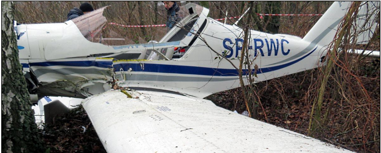
Rys.42 – Kadłub z lewej strony. Widoczne uszkodzenia lewej burty, nasady lewego skrzydła i brak oszklenia.
