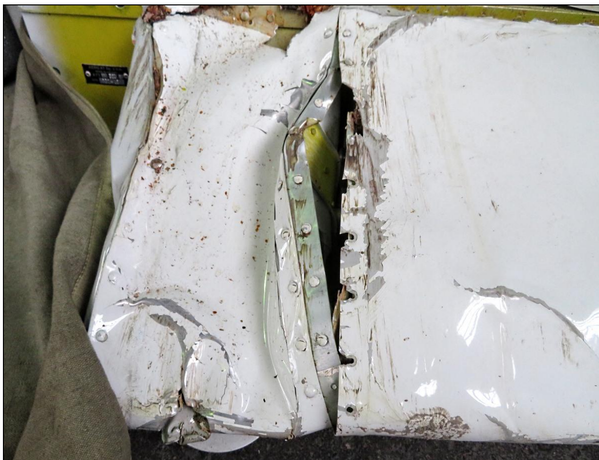
Rys.32 – Zniszczenia lewego skrzydła u nasady w rejonie noska – zbliżenie od strony noska.
