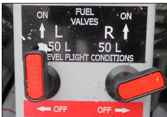
Rys.60 – Zawory instalacji paliwowej. Lewy zawór wskutek odkształceń kadłuba samolotu nie dawał się zamknąć.
