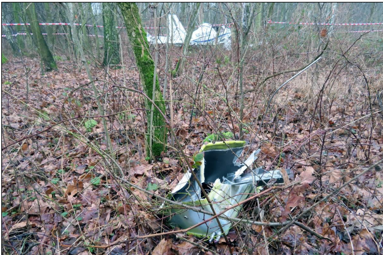
Rys.21 – Wyrwany z prawego skrzydła, zniszczony zbiornik paliwa. W tle samolot na miejscu wypadku.
