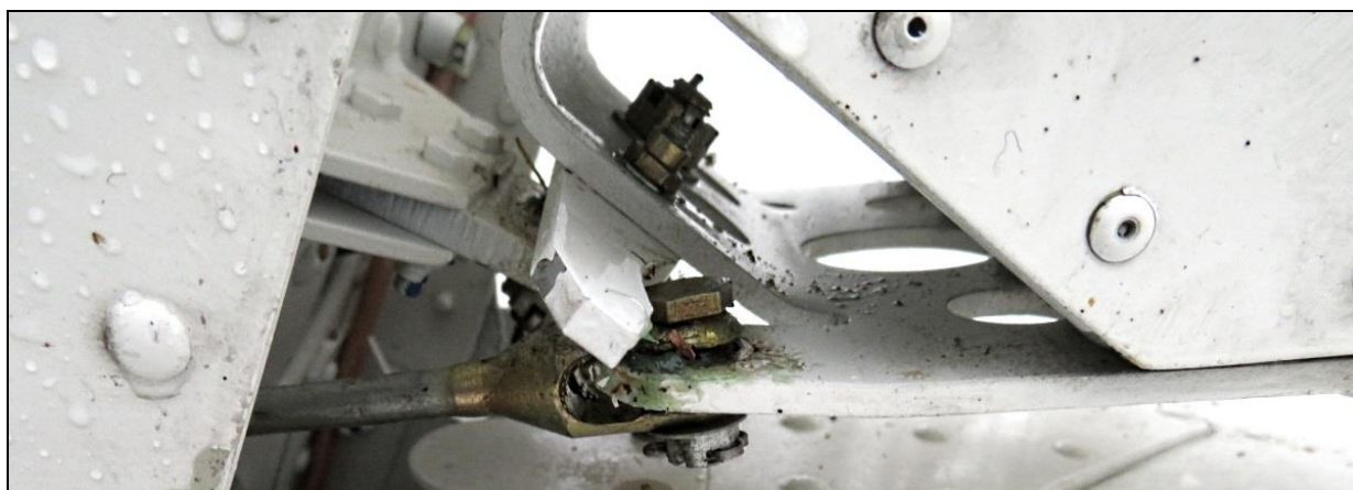
Rys.41 – Dolne zawieszenie steru kierunku. Widoczna końcówka popychacza napędu steru kierunku.
