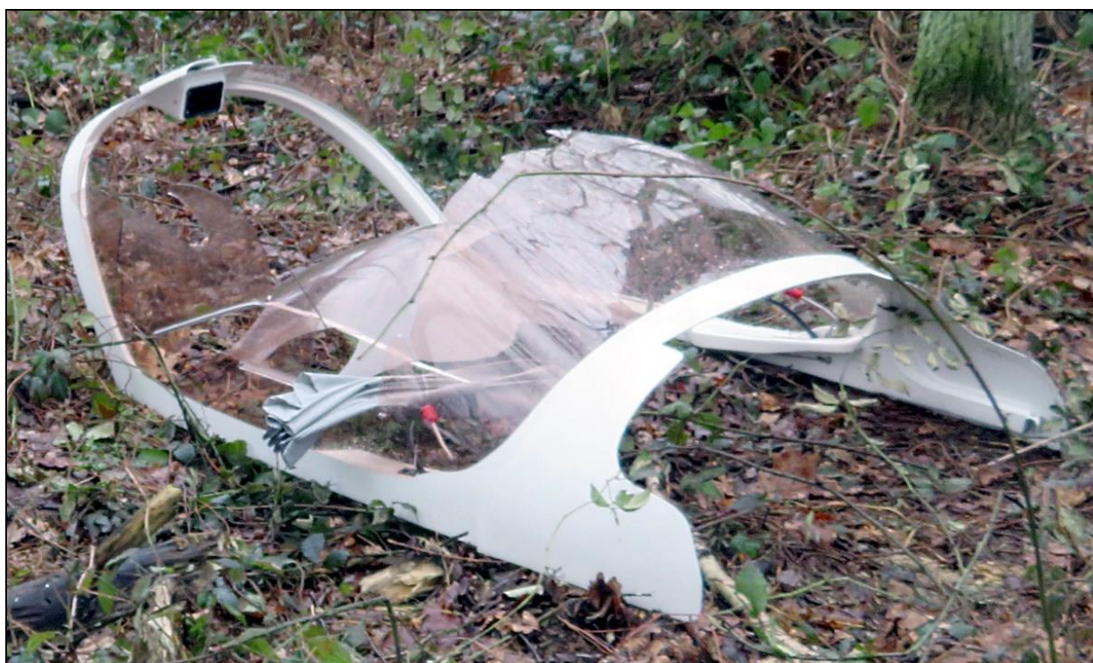
Rys.52 – Rama osłony kabiny ze zniszczonym oszkleniem.
