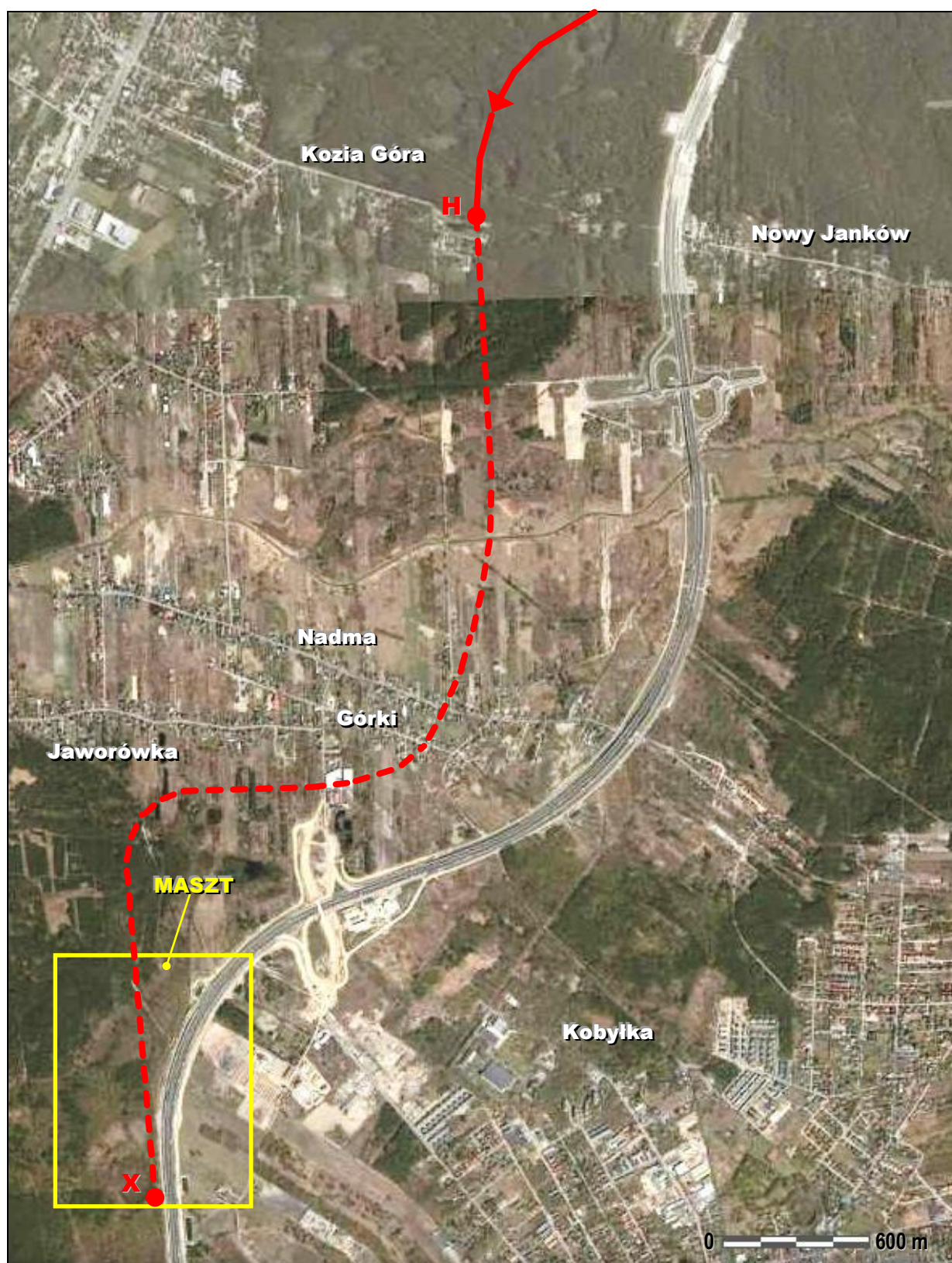
Rys.6 – Końcowa faza trasy lotu – lot po przerwaniu pracy przez silnik. Zaznaczone punkty charakterystyczne H i X zdefiniowane w Tabeli 1 w treści Raportu końcowego. Żółtą ramką zaznaczony obszar terenu pokazany na rys.7. [PKBWL, podkład: geoportal].
