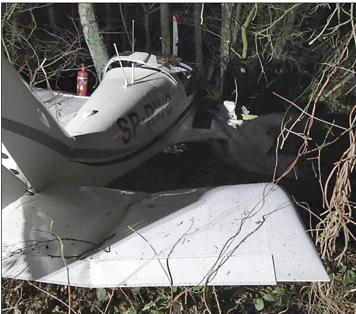
Rys.16 – Samolot na miejscu wypadku, prawa strona od tyłu. Widoczne złamanie prawej części płyty usterzenia poziomego oraz strefa oderwania prawego skrzydła i zniszczone oszklenie [foto: OSP Kobyłka].
