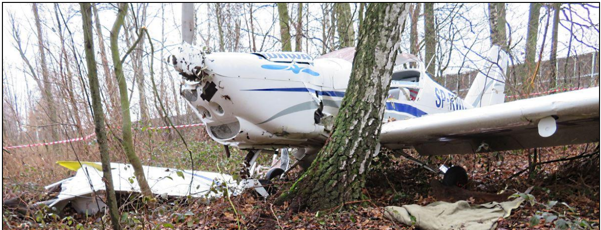
Rys.43 – Zbliżenie na przednią część kadłuba z lewej strony. Widoczne uszkodzenia nasady lewego skrzydła, lewej burty kadłuba i osłon silnika, zniszczony kołpak śmigła i brak oszklenia. Samolot stoi na praktycznie nieuszkodzonym podwoziu.
