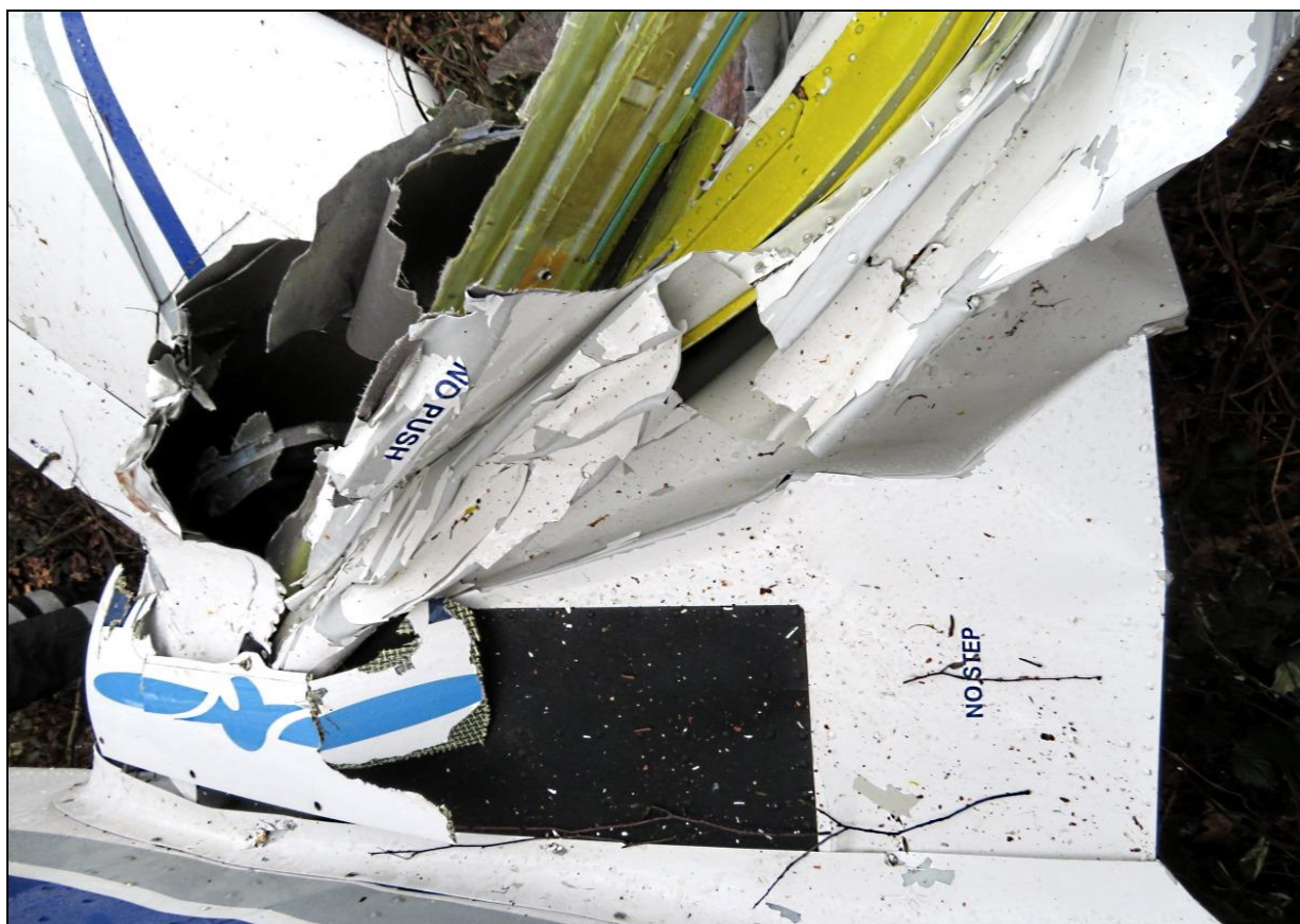
Rys.28 – Resztką struktury prawego skrzydła pozostała przy kadłubie. Wyraźnie widoczne miejsce zderzenia z drzewem „A”.
