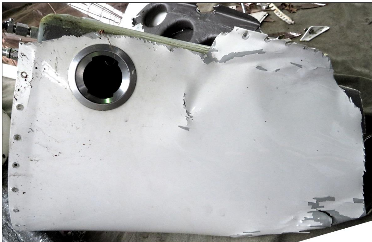
Rys.53 – Widoczny od strony wlewu prawy zbiornik paliwa, wyrwany ze skrzydła podczas zderzenia z drzewami.
