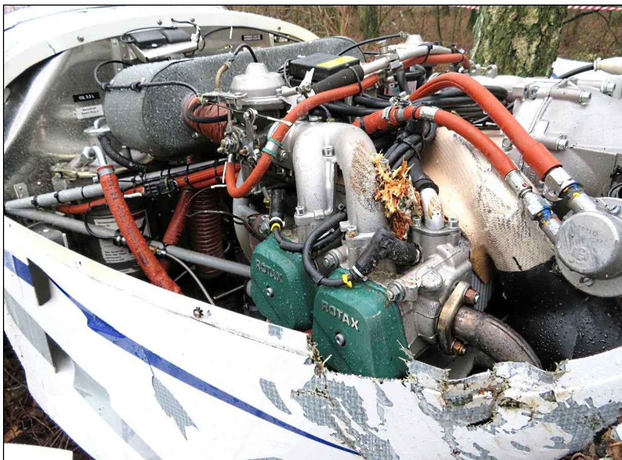
Rys.51 – Zbliżenie na silnik z prawej strony, górna osłona silnika zdjęta. Dobrze widoczne ślady po zderzeniu z drzewem „B” (resztki drzewa wbite w silnik).
