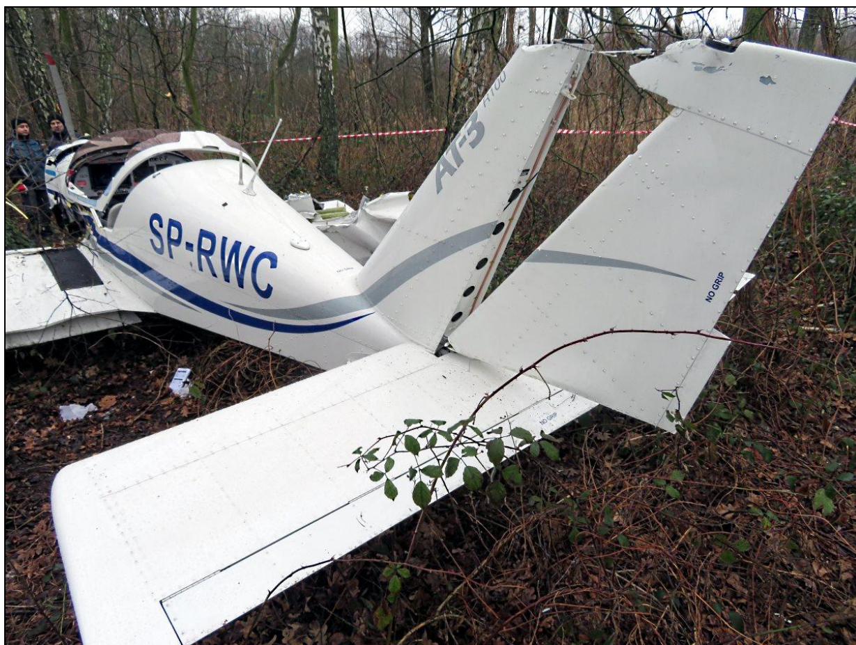
Rys.38 – Usterzenie z lewej strony od tyłu. Widoczne rozdzielenie górnego zawiasu steru kierunku i statecznika pionowego oraz zniszczona końcówka steru kierunku.
