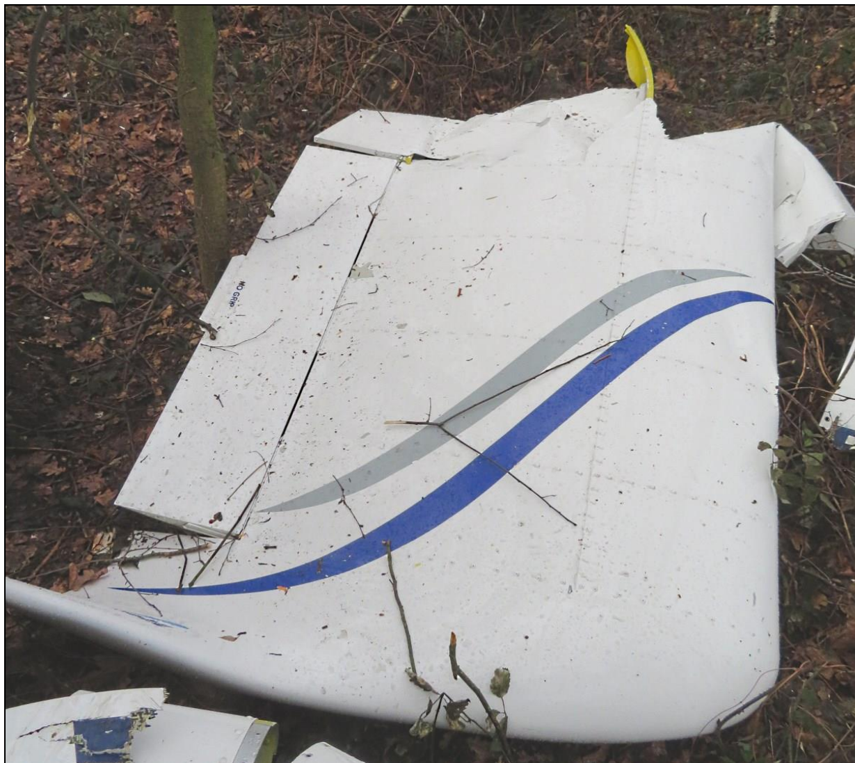
Rys.30 – Oderwana część prawego skrzydła z końcówką, lotką i fragmentem klapy.
