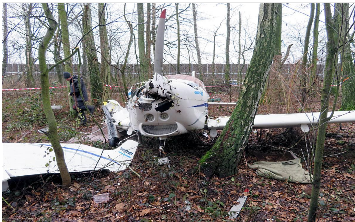
Rys.45 – Widok samolotu od przodu. Widoczna łopata śmigła pozostająca przy piaście, oderwane prawe skrzydło i odłamana łopata śmigła na ziemi.
