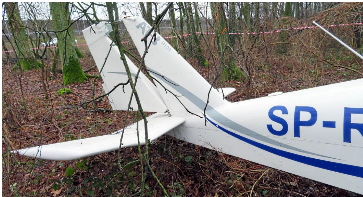
Rys.35 – Usterzenie pokazane z prawej strony. Widoczne rozdzielenie górnego zawiasu steru kierunku i statecznika pionowego oraz zniszczona końcówka steru. Zwraca uwagę złamanie prawej części płyty usterzenia poziomego
