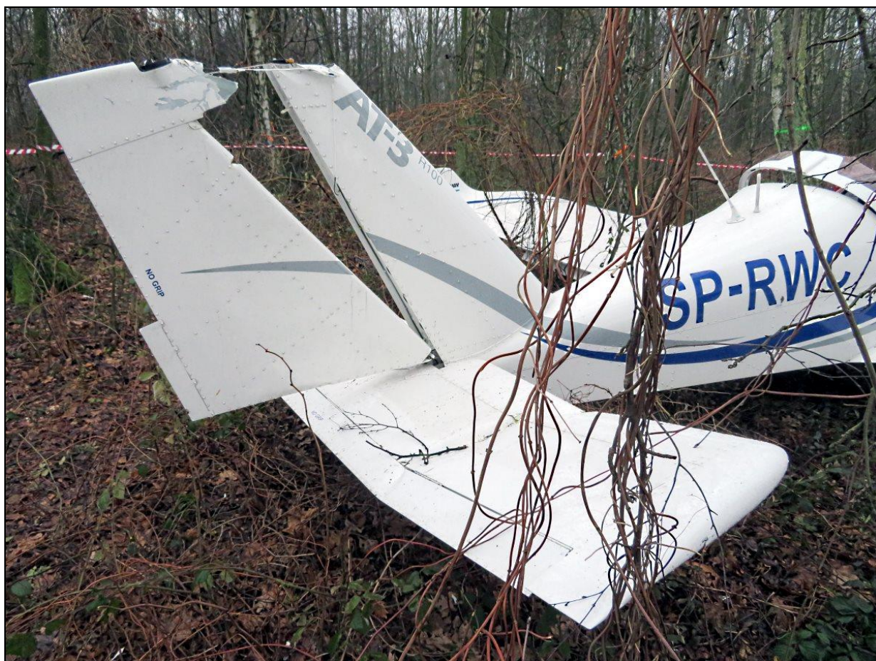
Rys.36 – Usterzenie pokazane z prawej strony od tyłu. Widoczne rozdzielenie górnego zawiasu steru kierunku i statecznika pionowego oraz zniszczona końcówka steru. Zwraca uwagę złamanie prawej części płyty usterzenia poziomego
