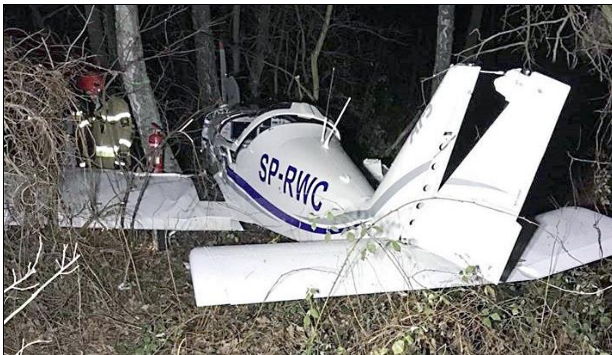
Rys.14 – Samolot na miejscu wypadku, lewa strona, widok 3/4 od tyłu. Widoczne uszkodzenia usterzenia: rozdzielenie górnego zawiasu steru kierunku oraz złamanie prawej części płyty usterzenia poziomego [foto: OSP Radzymin].
