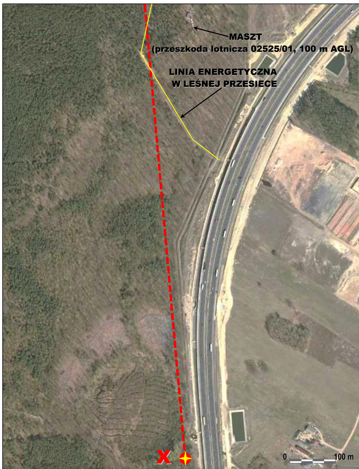
Rys.7 – Końcowy odcinek podejścia do przymusowego lądowania. Zaznaczone przeszkody terenowe. [PKBWL, podkład: geoportal]
