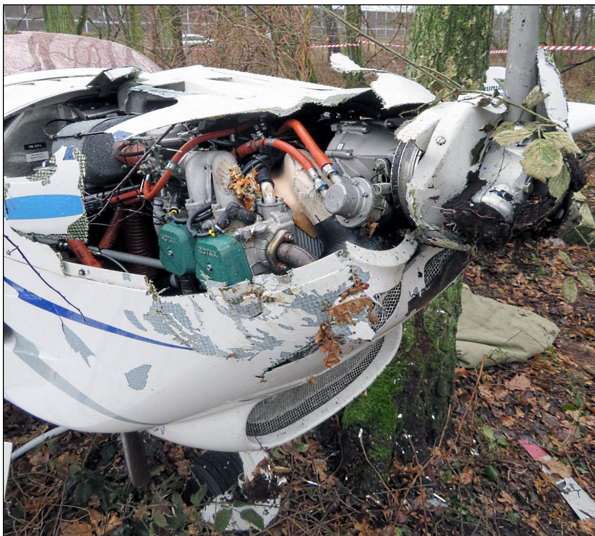
Rys.47 – Zbliżenie na silnik z prawej strony. Dobrze widoczne ślady po zderzeniu z drzewem „B”(resztki drzewa wbite w silnik) i zniszczone śmigło oraz jego kołpak. Na ziemi widoczna odłamana łopata śmigła.
