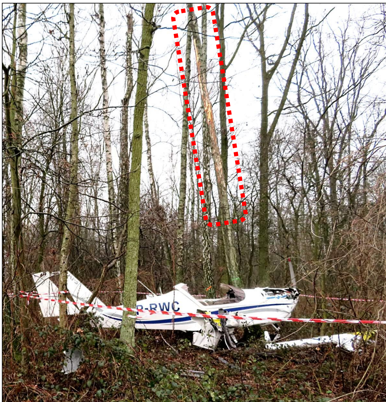
Rys.25 – Ogólny widok samolotu na miejscu wypadku. Zaznaczone drzewo „B”, po którym samolot osuwał się na ziemię.
