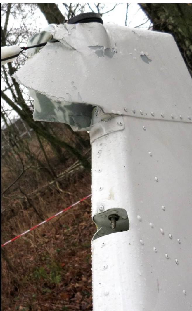
Rys.40 – Górny zawias steru kierunku, oddzielony od statecznika pionowego. Widoczna zniszczona końcówka steru kierunku.
