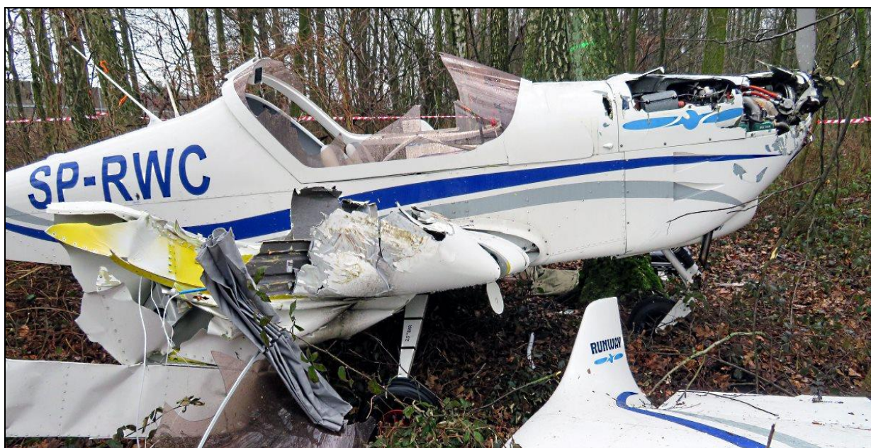
Rys.33 – Przednia część kadłuba z prawej strony. Widoczne zniszczenia u nasady prawego skrzydła, rozbite oszklenie i zniszczona górna osłona silnika. Na ziemi oderwany fragment prawego skrzydła.
