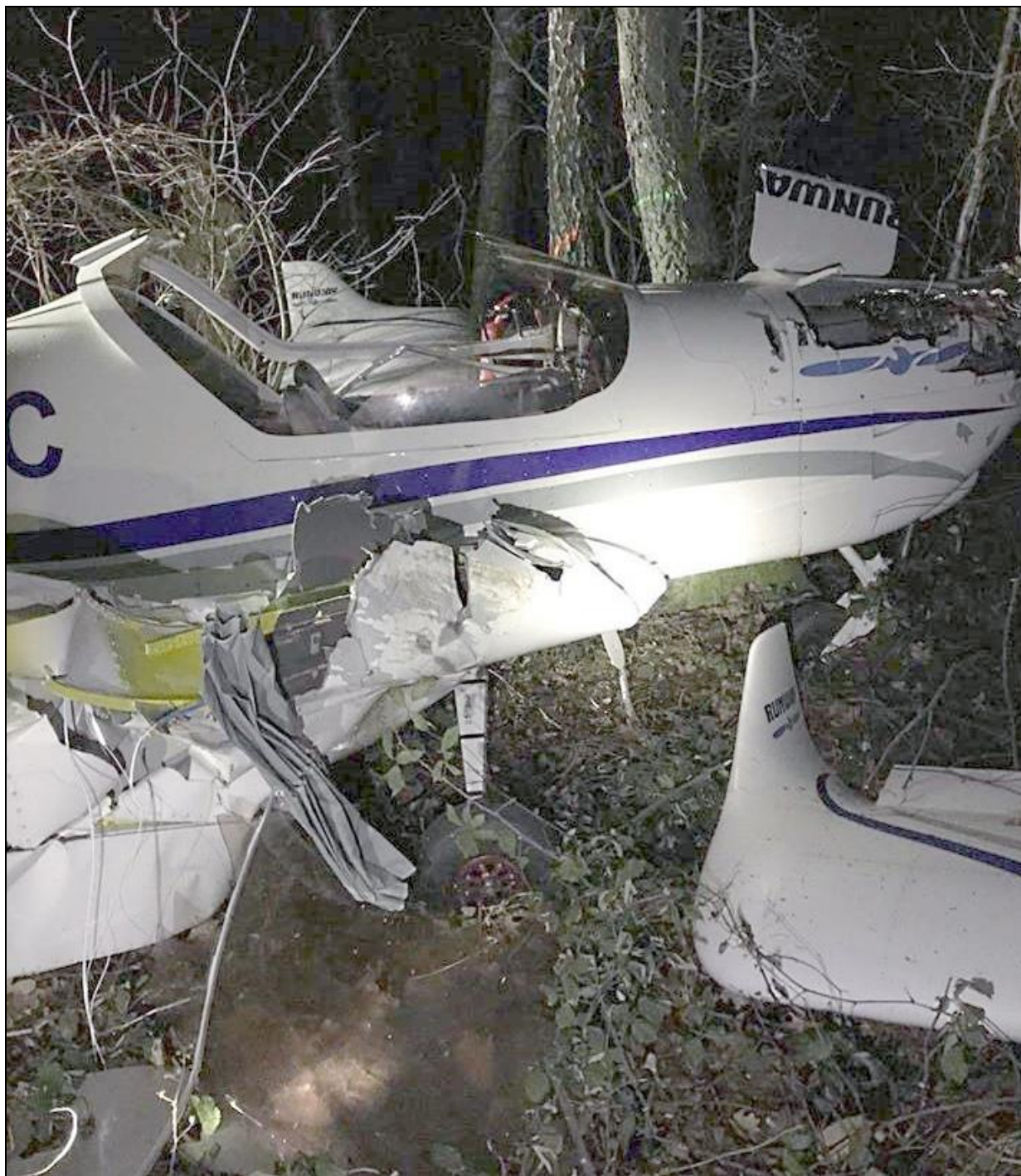
Rys.17 – Przednia część kadłuba z prawej strony. Widoczne uszkodzenia górnej osłony silnika i strefa zniszczenia prawego skrzydła przy kadłubie w wyniku oderwania oraz zniszczone oszklenie osłony kabiny i owiewka koła przedniego podwozia. Obok widoczna końcówka oderwanego prawego skrzydła [foto: OSP Radzymin].
