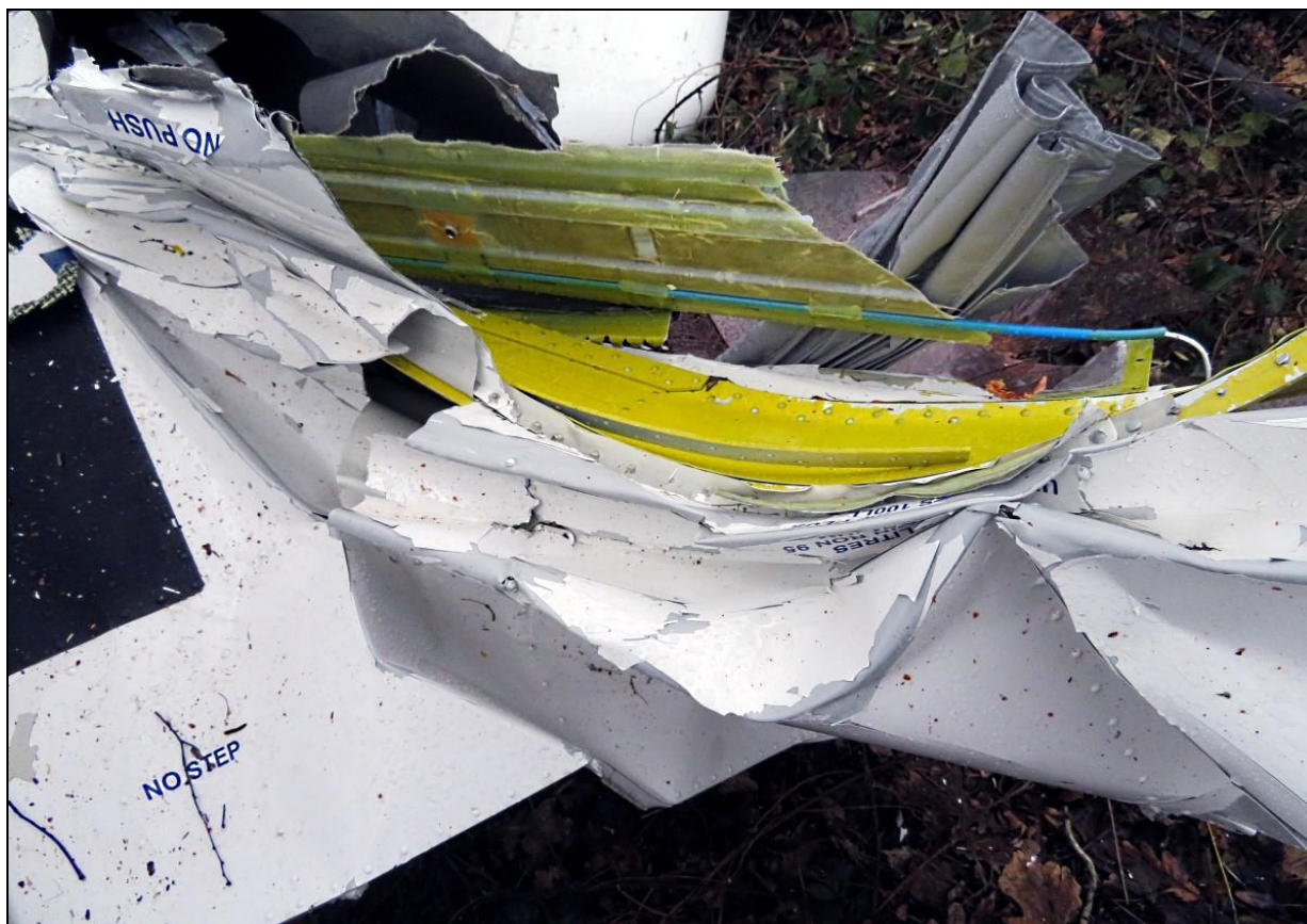
Rys.29 – Resztką struktury prawego skrzydła pozostała przy kadłubie. Wyraźnie widoczne miejsce zderzenia z drzewem „A”.
