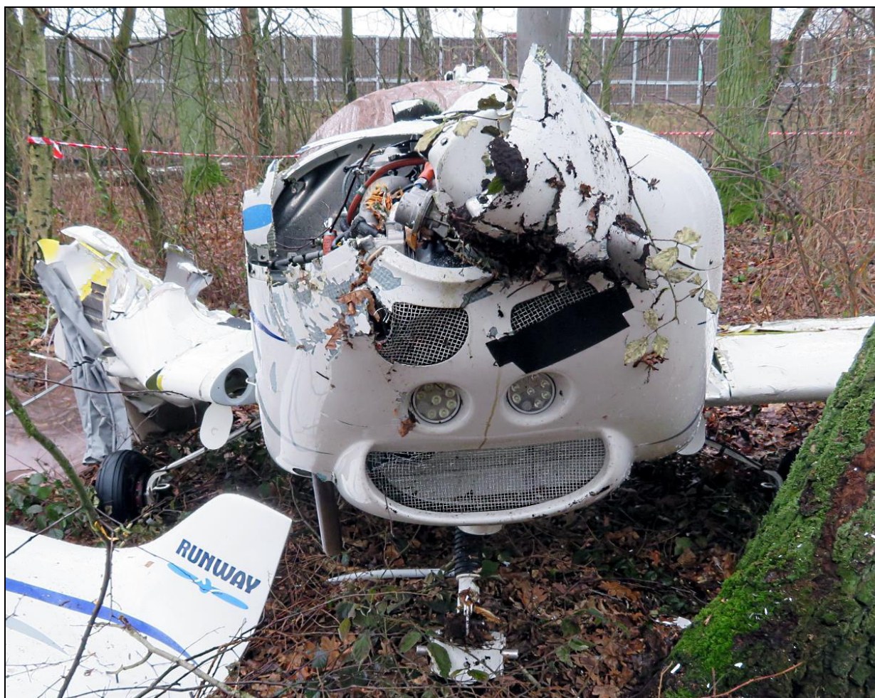
Rys.46 – Widok samolotu od przodu – zbliżenie. Dobrze widoczne zniszczenia osłon silnika i kołpaka śmigła.
