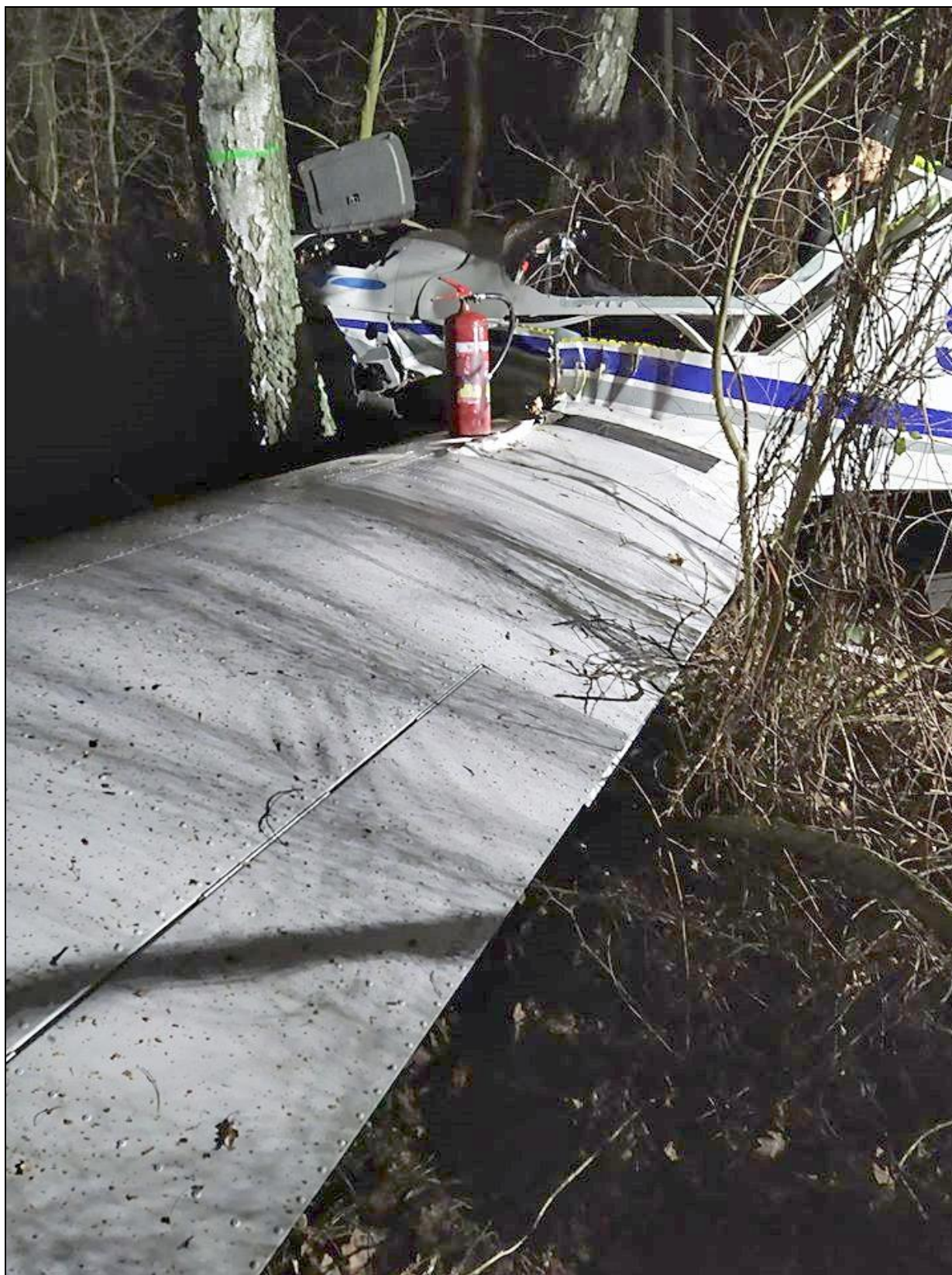
Rys.18 – Widok na uszkodzone przy kadłubie górne pokrycie lewego skrzydła i kabinowa część kadłuba z lewej strony. Zauważalne uszkodzenia i pofalowanie pokrycia lewej burty kadłuba w strefie kabiny – to odkształcenie spowodowało lekkie obrażenia lewej ręki ucznia-pilota [foto: OSP Kobyłka].
