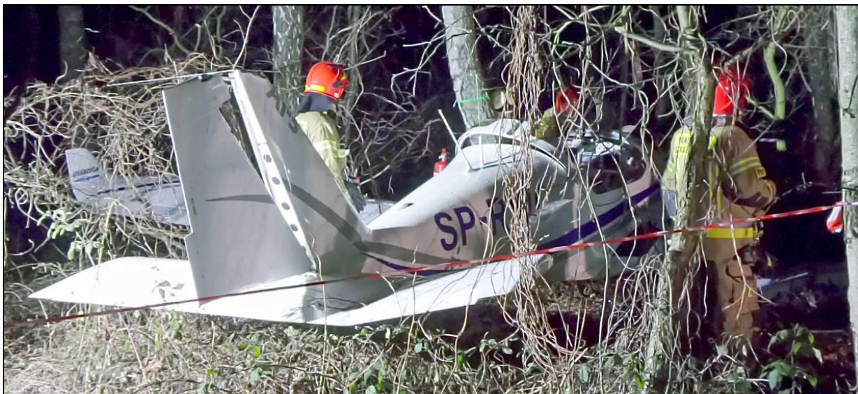
Rys.15 – Samolot na miejscu wypadku, prawa strona, widok \frac{3}{4} od tyłu. Widoczne uszkodzenia usterzenia: rozdzielenie górnego zawiasu steru kierunku oraz złamanie prawej części płyty usterzenia poziomego [foto: TVN24].
