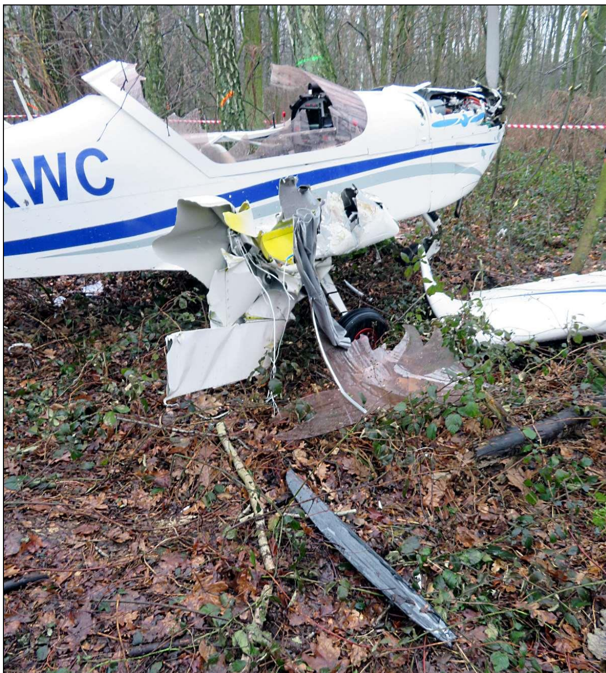
Rys.34 – Przednia część kadłuba z prawej strony. Widoczne zniszczenia u nasady prawego skrzydła, rozbite oszklenie i zniszczona górna osłona silnika. Na ziemi odłamana łopata śmigła i oderwany fragment prawego skrzydła.
