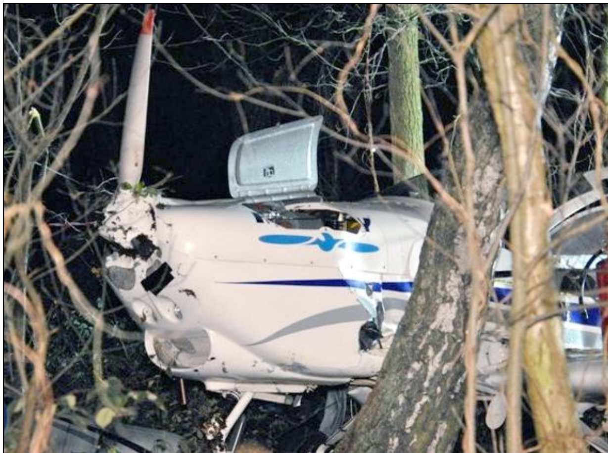
Rys.13 – Samolot na miejscu wypadku, uszkodzenia osłon silnika z lewej strony. Widoczna nieuszkodzona łopata śmigła, ustawiona pionowo [foto: Wawa-Hot-News-24].
