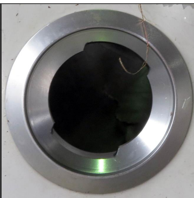
Rys.55 – Wlew prawego zbiornika paliwa. Wypadnięcie (wyssanie) korka tego wlewu wskutek jego niedomknięcia to zasadnicza przyczyna wypadku.
