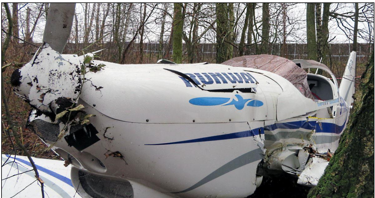
Rys.44 – Zbliżenie na przednią część kadłuba z lewej strony. Widoczne uszkodzenia nasady lewego skrzydła, lewej burty kadłuba i osłon silnika, zniszczony kołpak śmigła i brak oszklenia.
