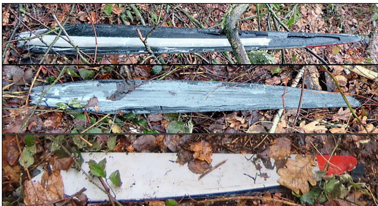
Rys.48, 49, 50 – Odłamane i rozszczerzone łopaty śmigła.
