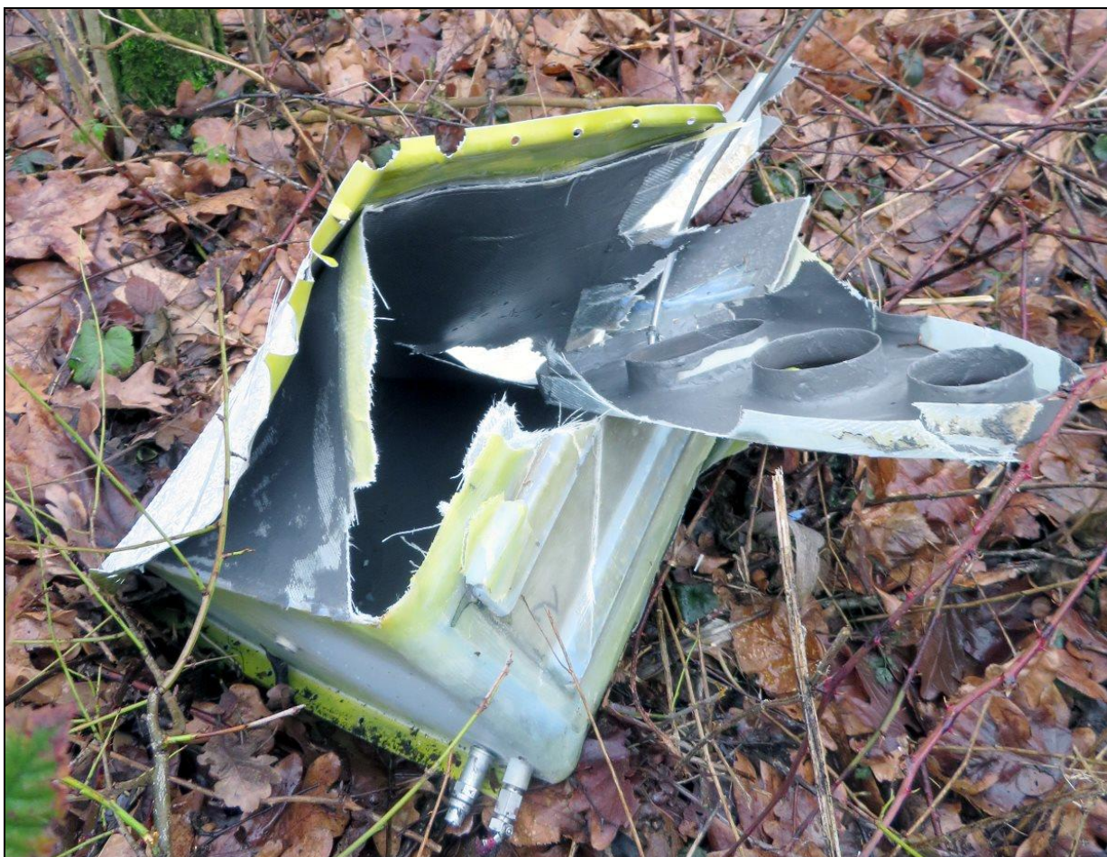
Rys.22 – Wyrwany z prawego skrzydła, zniszczony zbiornik paliwa.
