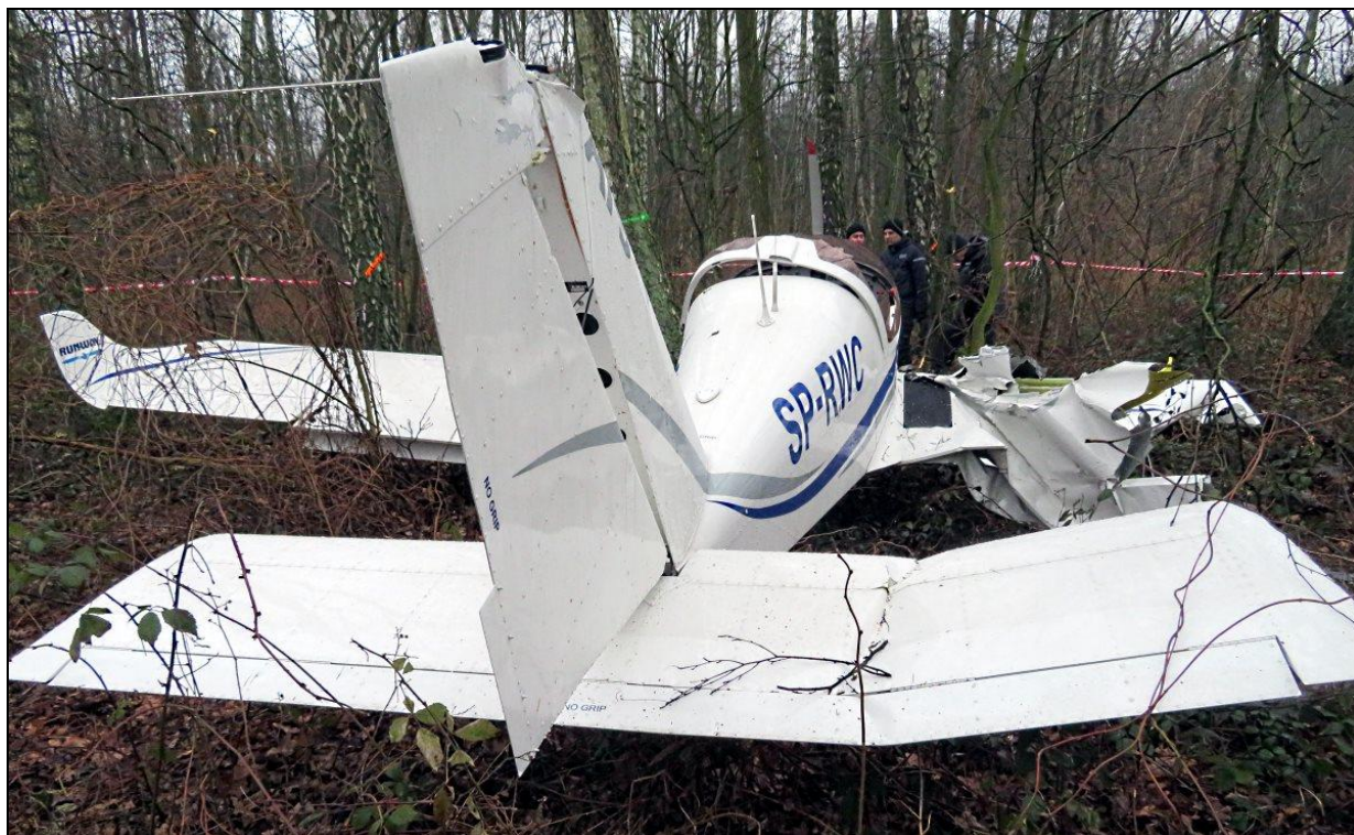
Rys.37 – Usterzenie pokazane od tyłu. Widoczne rozdzielenie górnego zawiasu steru kierunku i statecznika pionowego oraz zniszczona końcówka steru. Zwraca uwagę złamanie prawej części płyty usterzenia poziomego.
