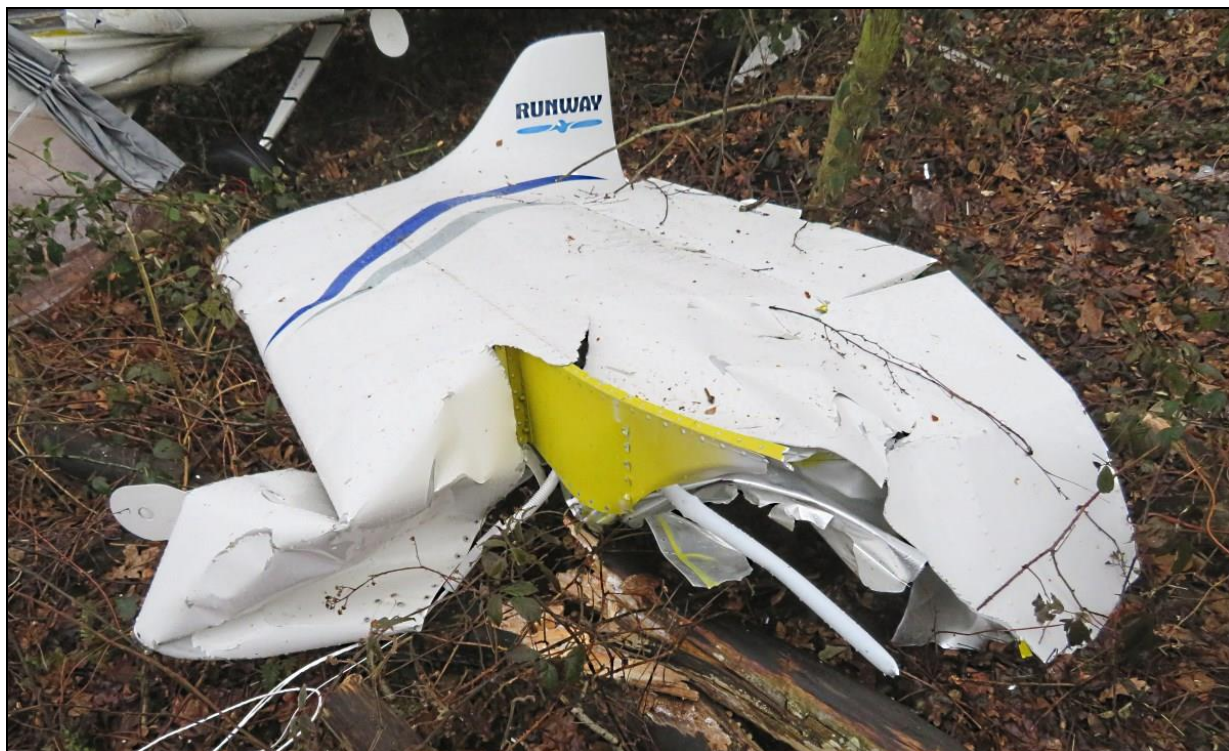
Rys.27 – Oderwana część prawego skrzydła z końcówką, lotką i fragmentem klapy. Widoczny popychacz sterowania lotką i zerwany dźwigar główny.
