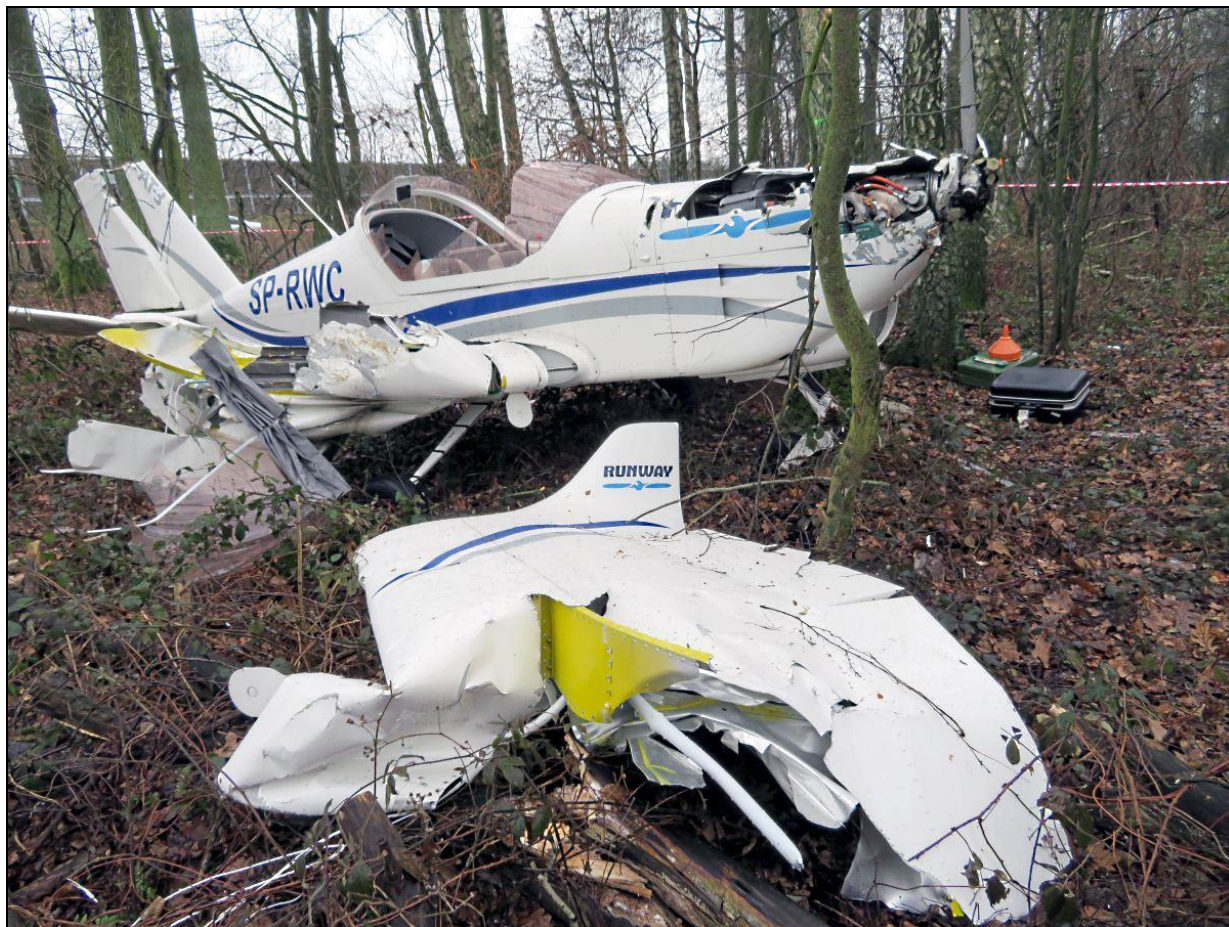
Rys.26 – kadłub samolotu z prawej strony od przodu oraz leżąca przed nim oderwana część prawego skrzydła z końcówką, lotką i fragmentem klapy. Widoczny popychacz sterowania lotką i zerwany dźwigar główny.
