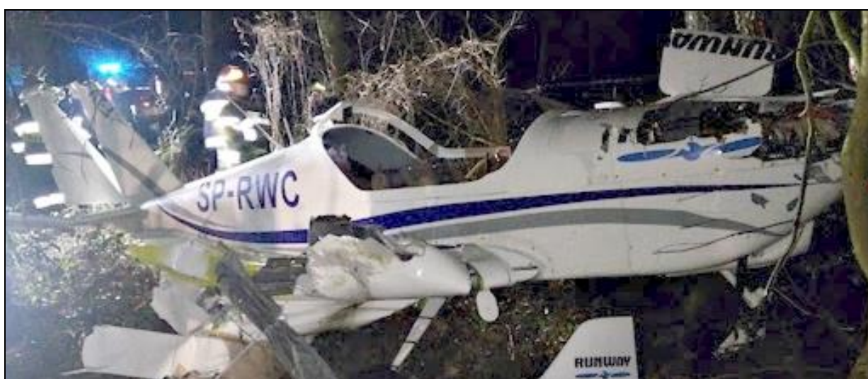
Rys.12 – Samolot na miejscu wypadku, prawa strona. Widoczne uszkodzenia w miejscu oderwanego prawego skrzydła oraz uszkodzenia górnej osłony silnika [foto: OSP Radzymin].
