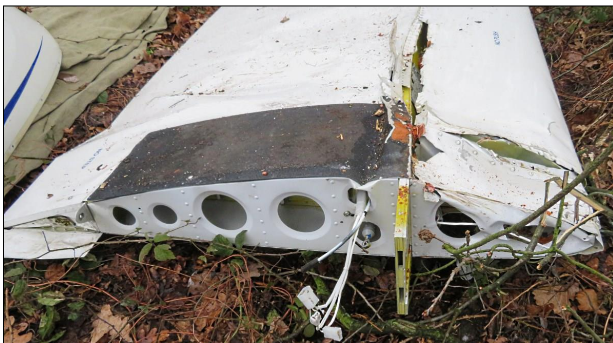
Rys.31 – Zniszczenia lewego skrzydła u nasady w rejonie noska, skrzydło zdemontowane z samolotu.
