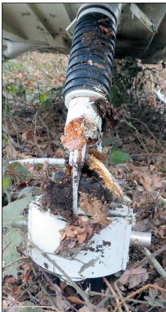
Rys.39 – Pozbawione zniszczonych owiewek przednie podwozie z wyraźnymi śladami zderzenia z drzewem.
