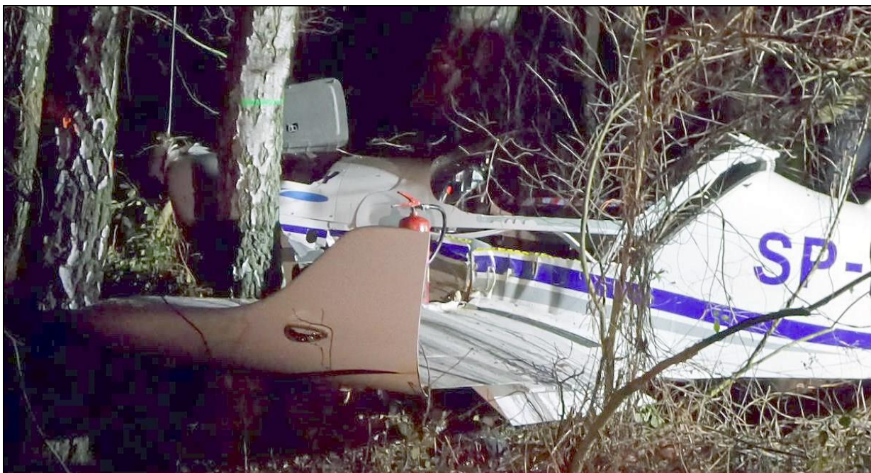
Rys.19 – Lewa strona samolotu, widoczna wychylona kłapa skrzydłowa i zniszczone oszklenie osłony kabiny. Zauważalne uszkodzenia i pofalowanie pokrycia lewej burty kadłuba w strefie kabiny – to odkształcenie spowodowało lekkie obrażenia lewej ręki ucznia-pilota [foto: TVN24].
