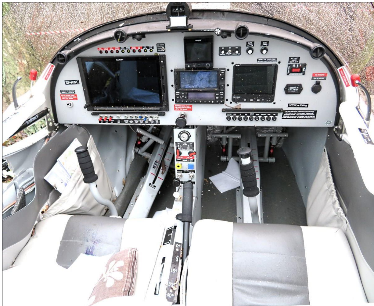
Rys.59 – Wnętrze kabiny. Widoczna wyrwana z zamocowań lewa sterownica nożna i zniszczenia lewej burty kadłuba. Brak widocznych uszkodzeń awioniki.
