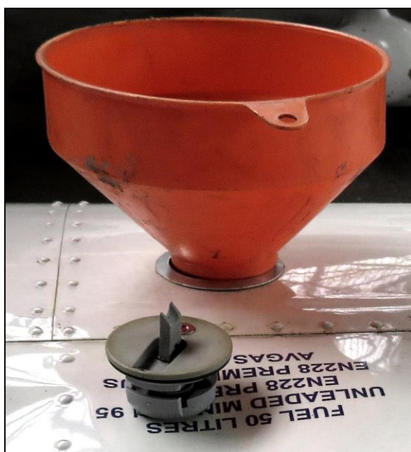
Rys.54 – Lewy zbiornik na samolocie – wlew paliwa z lejkiem i korek wlewu.
