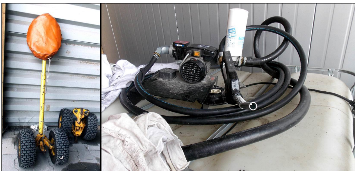
71, 72 – Kółka pod płozy śmigłowca i zbiornik paliwa z urządzeniem do tankowania.
