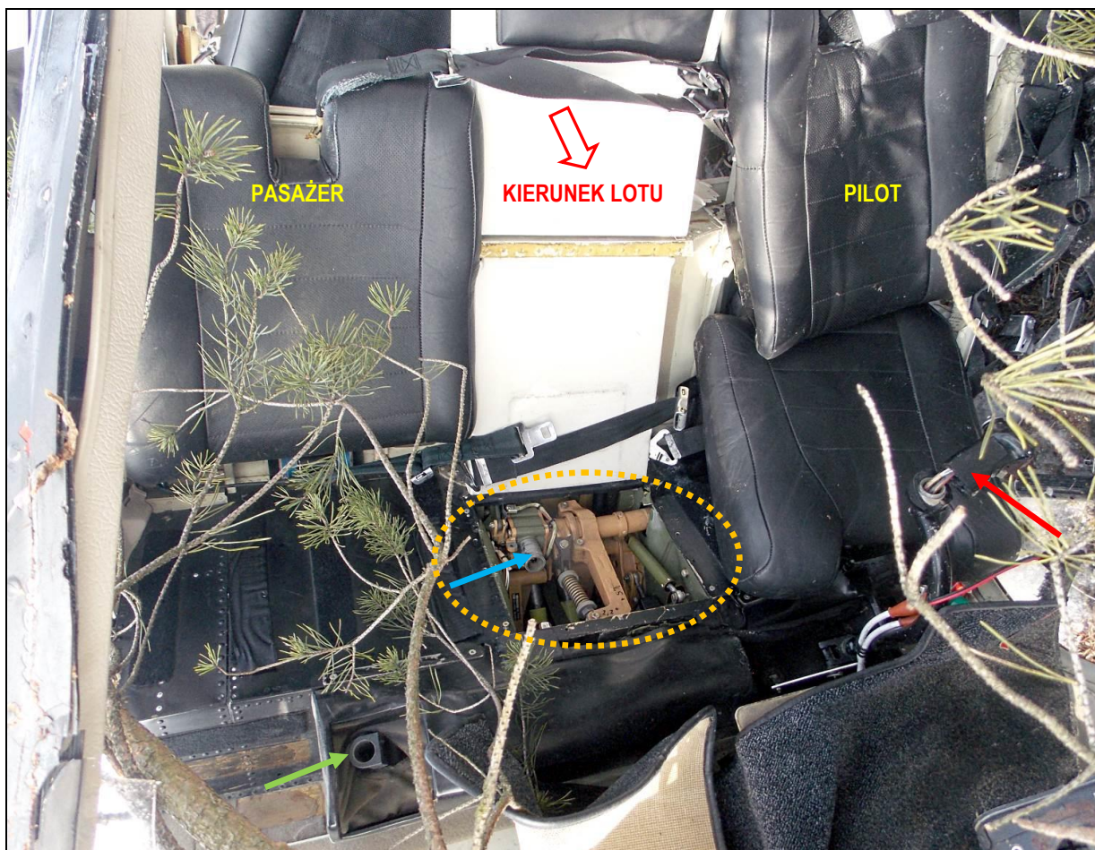
63 – Fotel pilota i fotel pasażera. Zaznaczona złamana rękojeść drążka sterowego pilota (czerwona strzałka). Po stronie pasażera widoczna obsada zdemontowanego drążka sterowego (strzałka zielona) oraz zdemontowanej dźwigni skoku i mocy (strzałka niebieska). Zwraca uwagę zespół sterowania w kabinie, odsłonięty po odpadnięciu niezamocowanego siedziska środkowego fotela.
