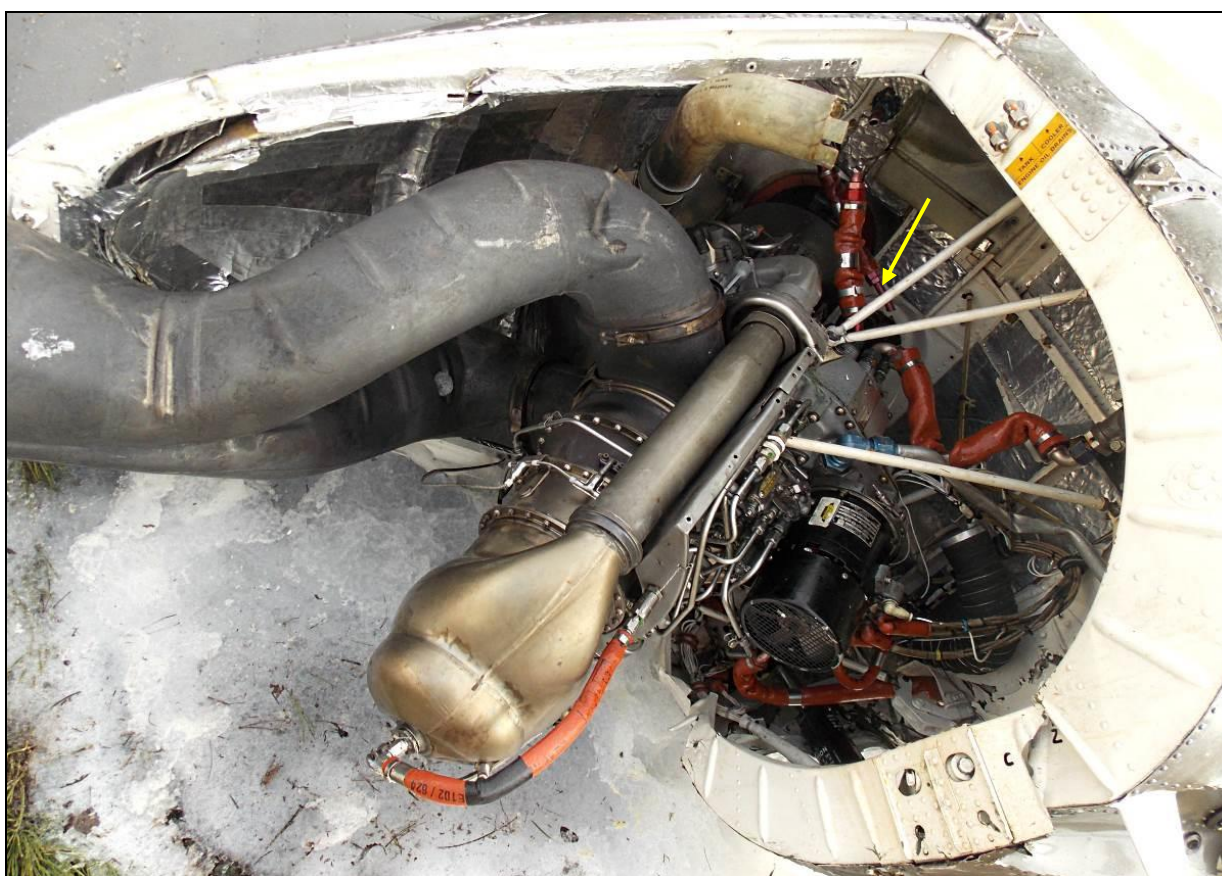
16 – Wnętrze przedziału silnika, widoczny przewód paliwowy zerwany przy upadku śmigłowca.
