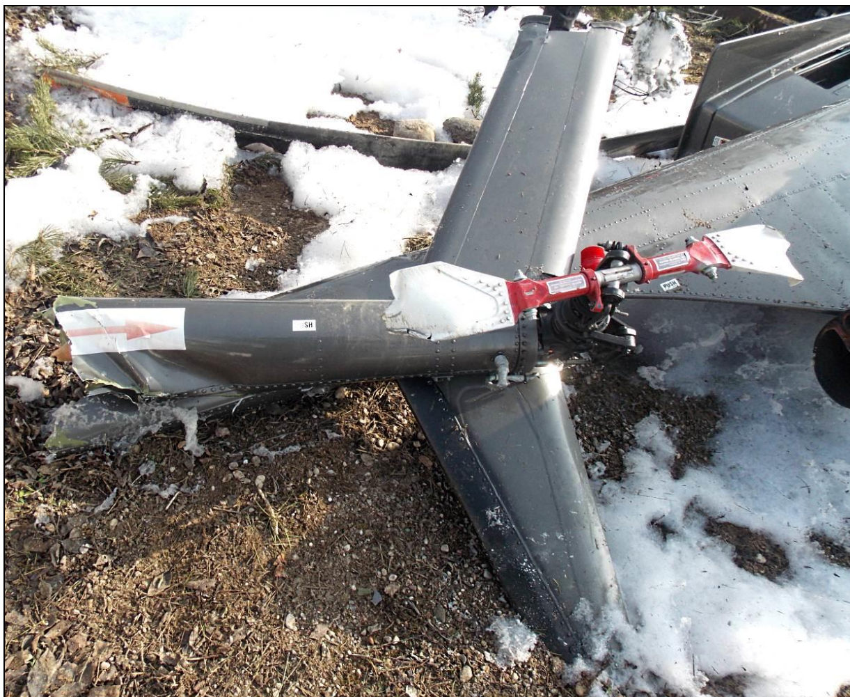
21 – Odlamany fragment belki ogonowej z usterzeniem pionowym i śmigielkiem ogonowym z oderwanymi łopatkami.
