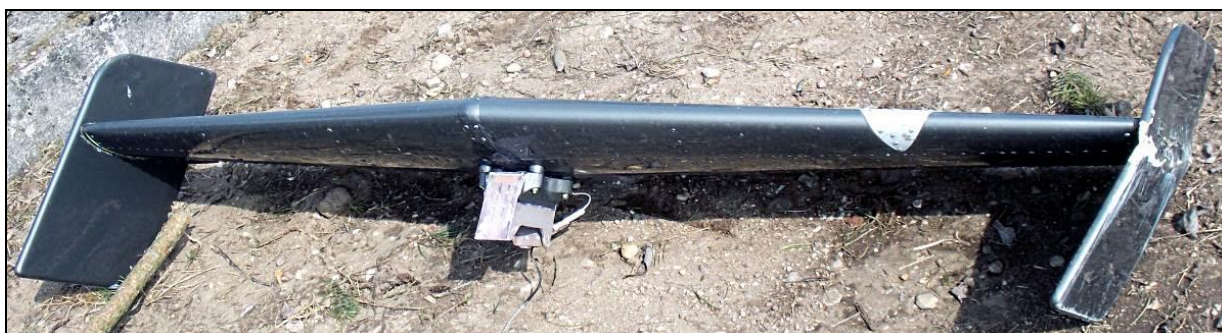
36 – Statecznik poziomy – widok od przodu. Widoczna łąta na nosku po prawej stronie.
