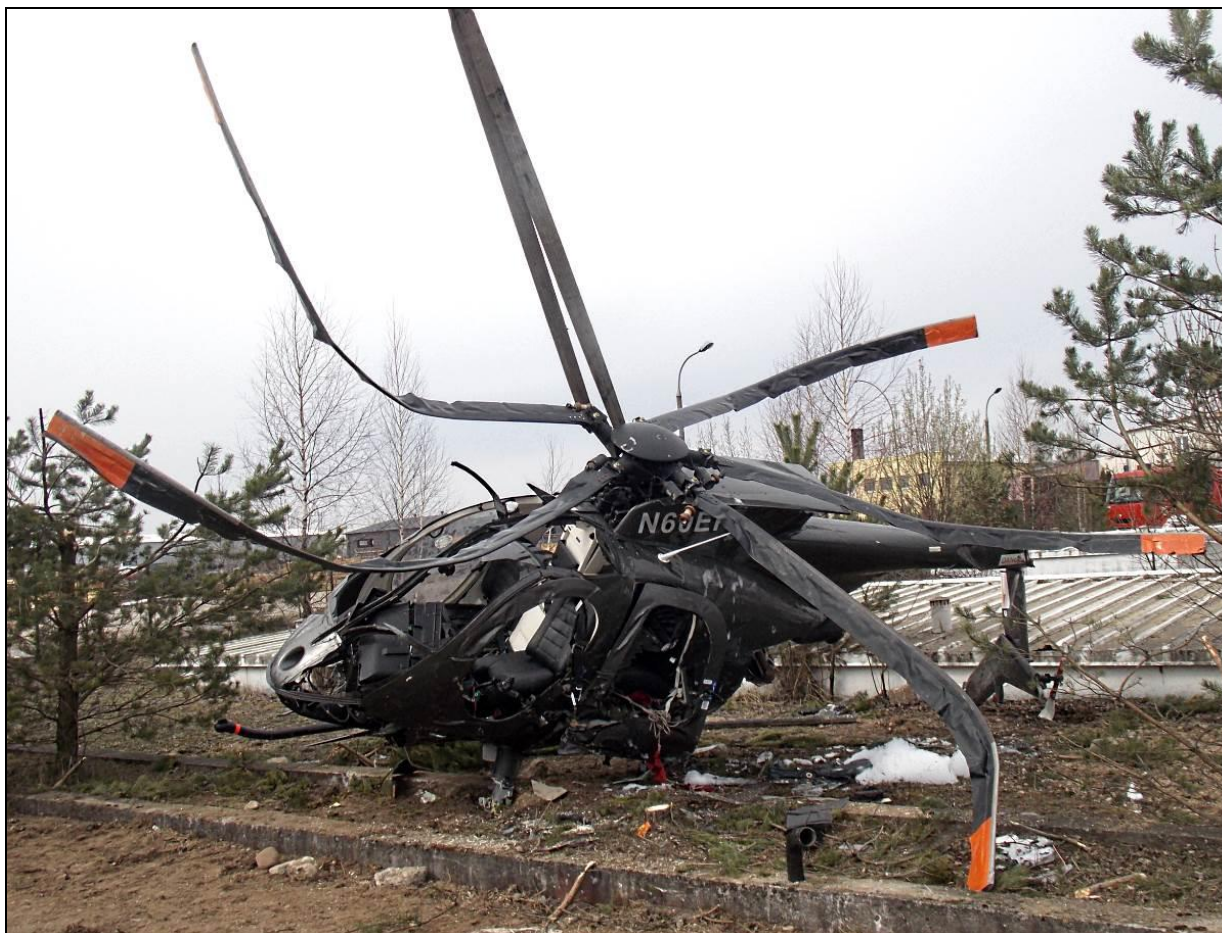
52 – Wrak śmigłowca unoszony dźwigiem, widoczne uszkodzenia lewej strony kadłuba.
