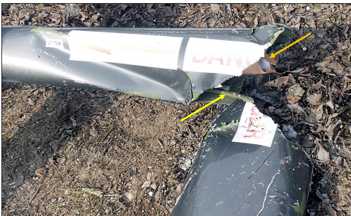
22 – Przełom belki ogonowej. Żółtą strzałką zaznaczony zgięty popychacz sterowania śmigielkiem ogonowym, pomarańczową – ścięty wał napędu śmigielka ogonowego.
