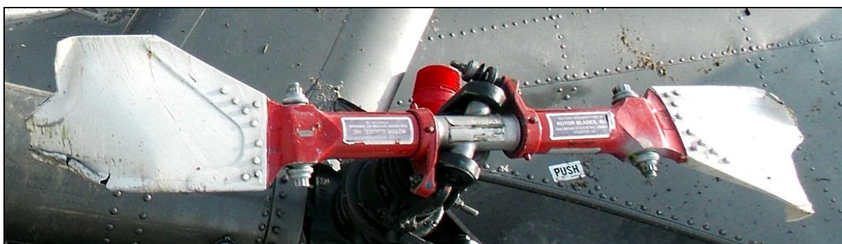
43 – Śmigielko ogonowe z odłamanymi zewnętrznymi częściami łopat.
