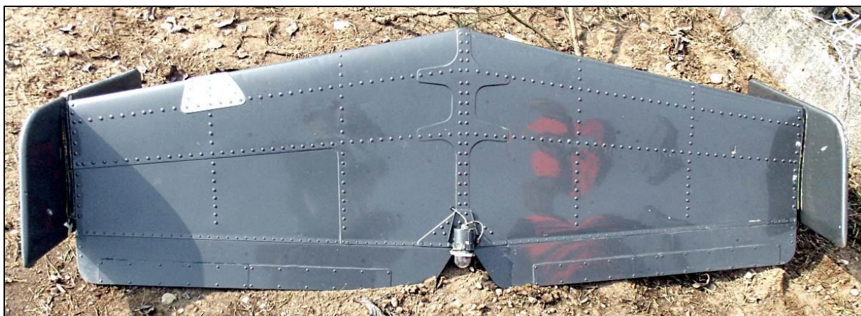
33 – Statecznik poziomy – widok od góry. Widoczna łąta na nosku po lewej stronie.
