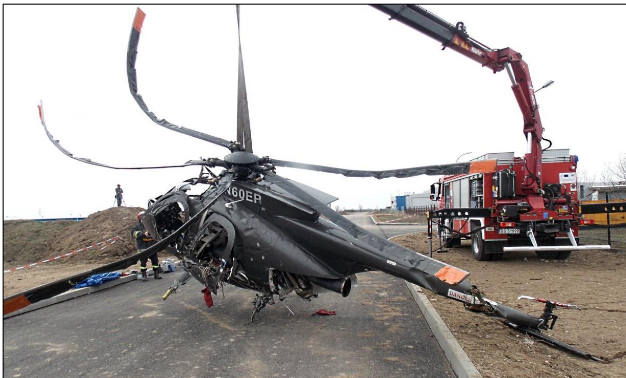
54 – Wrak śmigłowca unoszony dźwigiem, widoczne uszkodzenia lewej strony kadłuba i wirnika głównego.
