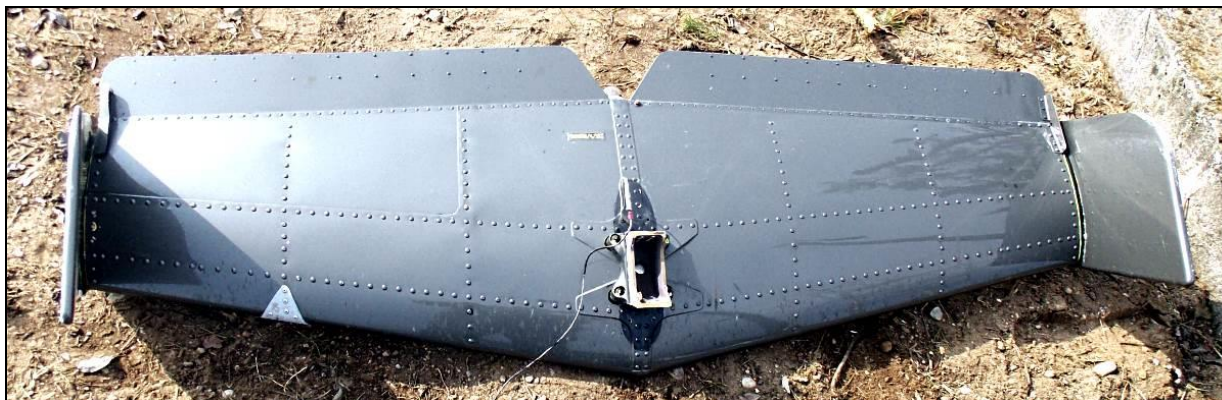
34 – Statecznik poziomy – widok od dołu. Widoczna łąta na nosku po lewej stronie.
