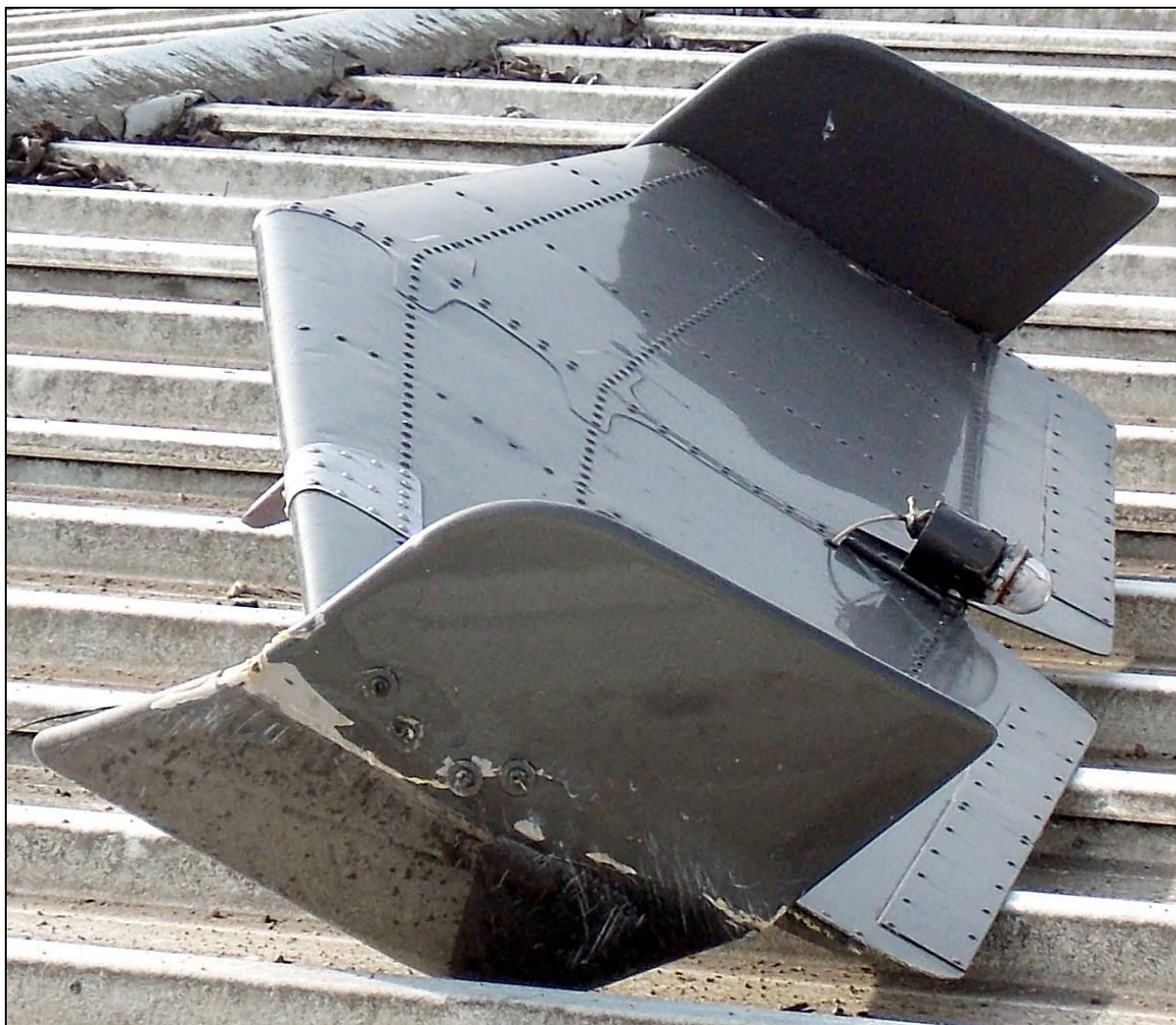
32 – Oderwany statecznik poziomy na dachu zbiornika wody.
