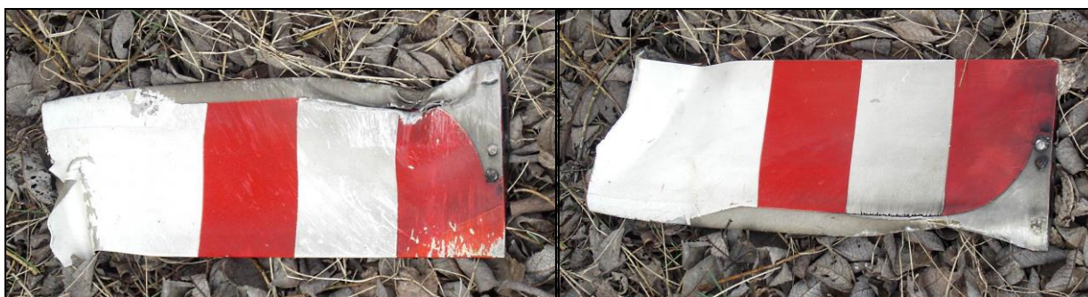
39, 40 – Odłamana łopata śmigielka ogonowego, pokazana z obu stron.
