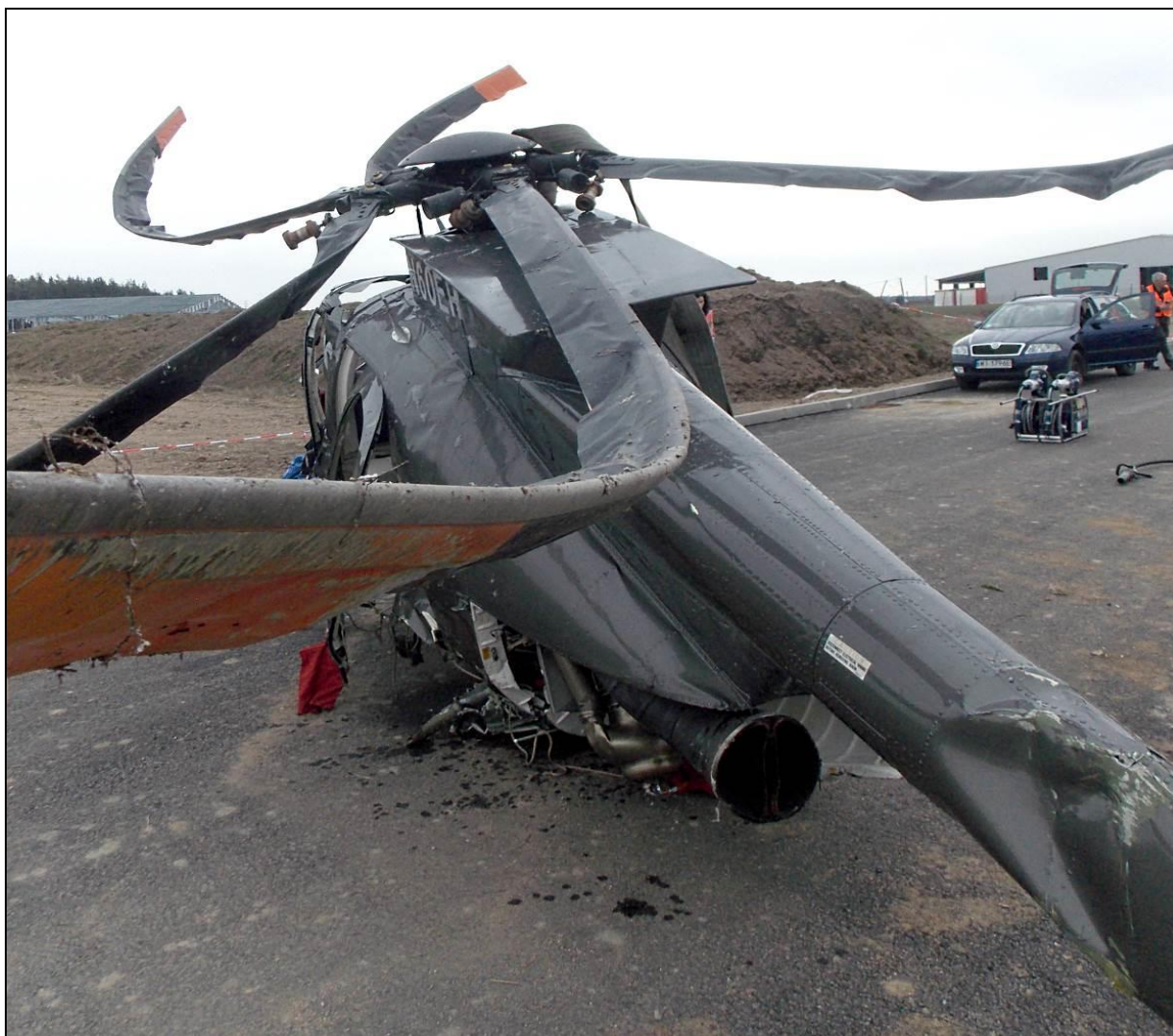
55 – Wrak śmigłowca unoszony dźwigiem, widoczne uszkodzenia lewej strony kadłuba i wirnika głównego.
