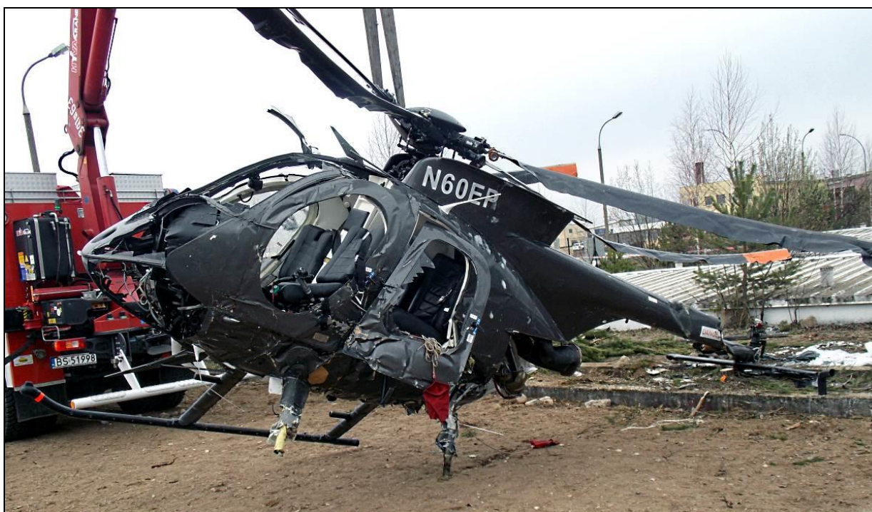
53 – Wrak śmigłowca unoszony dźwigiem, widoczne uszkodzenia lewej strony kadłuba.
