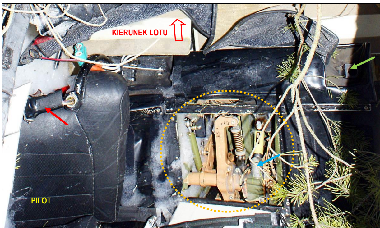
64 – Zespół sterowania w kabinie, odsłonięty po odpadnięciu niezamocowanego siedziska środkowego fotela (oznaczenia strzałkami jak wyżej) [foto: KMP Suwałki].
