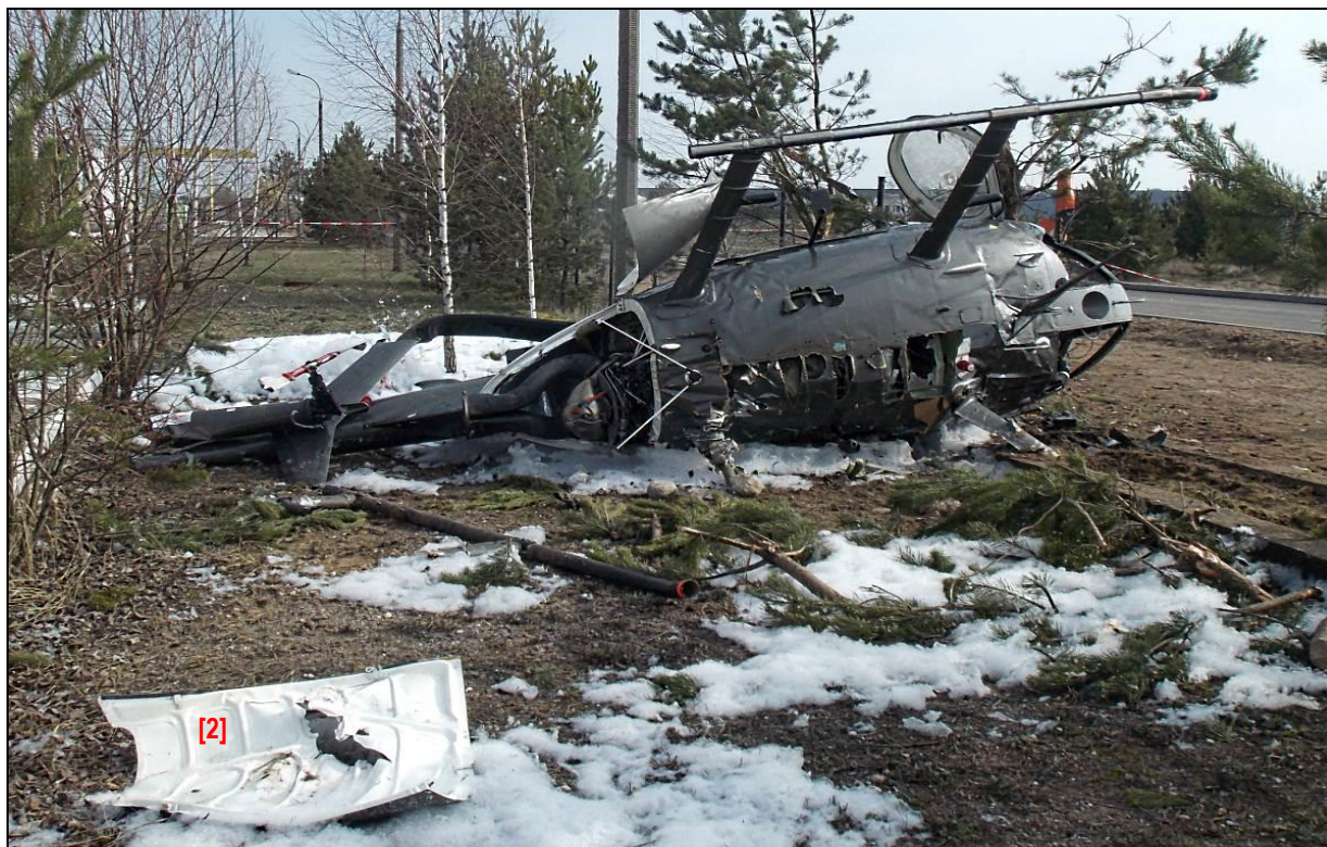
9 – Rozbity śmigłowiec, widok ogólny od spodu. Na pierwszym planie pokrywa silnika [2], przemieszczona po wypadku na miejsce widoczne na zdjęciu.
