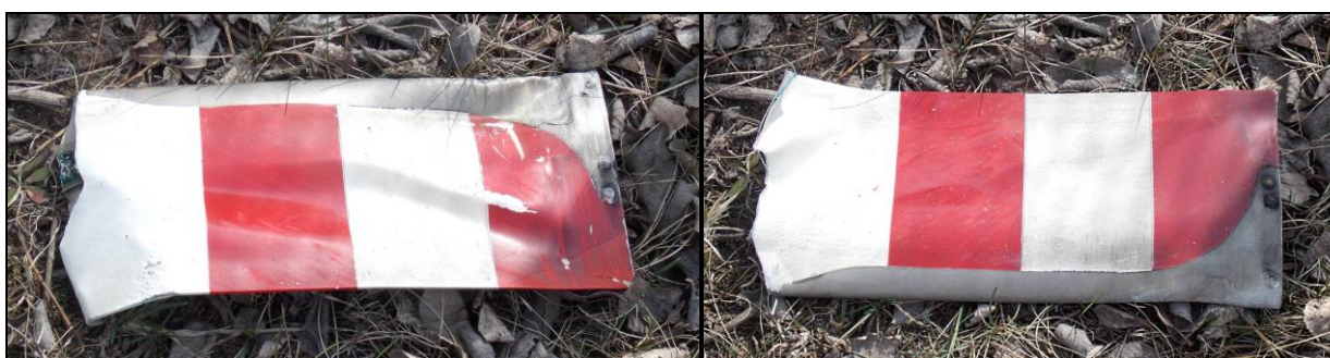
41, 42 – Odłamana łopata śmigielka ogonowego, pokazana z obu stron.
