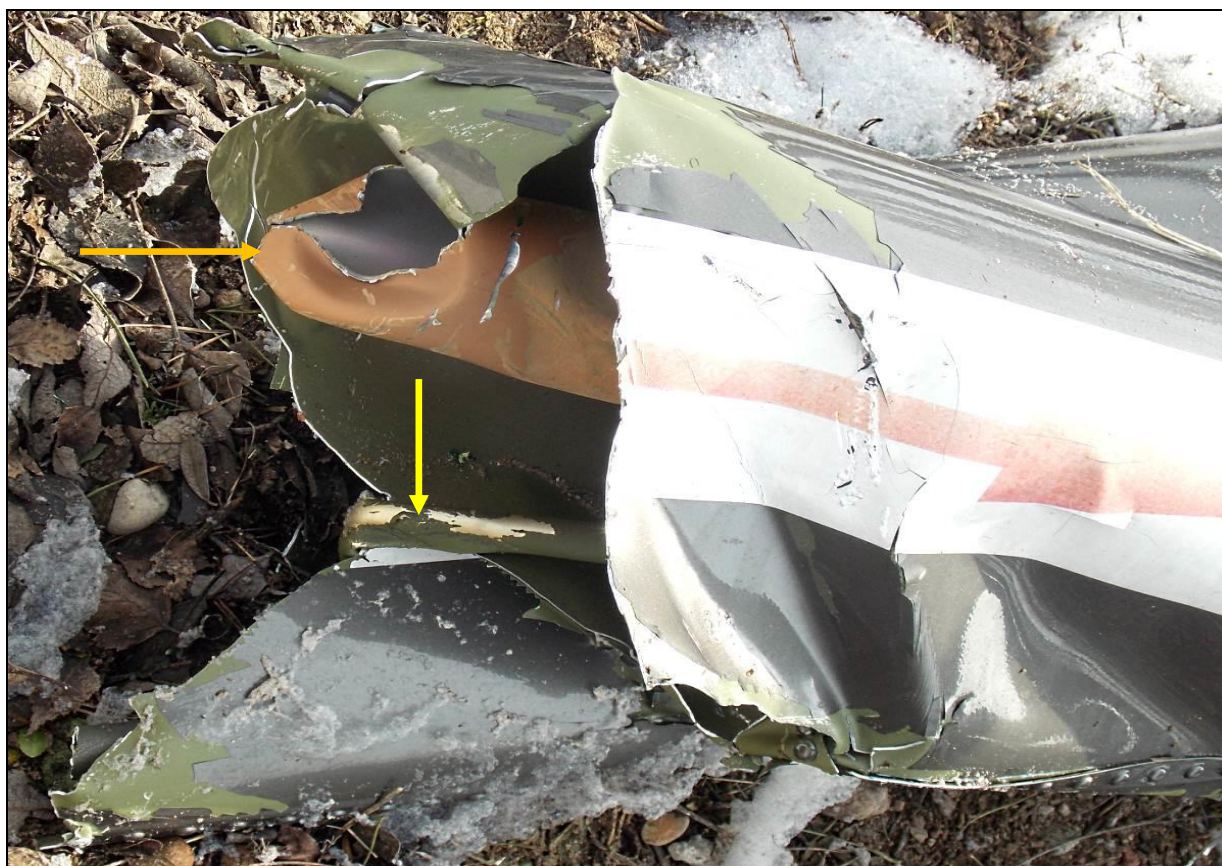
24 – Przełom belki ogonowej w zbliżeniu. Żółtą strzałką zaznaczony zgięty i zerwany popychacz sterowania śmigłem ogonowym, pomarańczową – ścięty wał napędu śmigła ogonowego.
