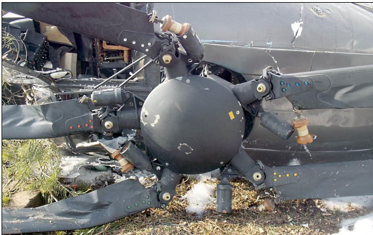
30 – Głowica wirnika głównego od góry.
