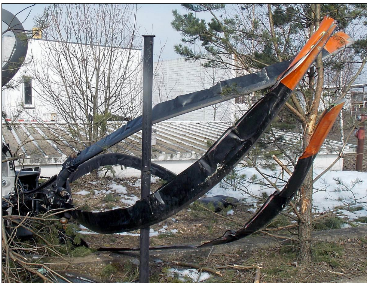
12 – Zniszczone łopaty wirnika głównego, charakterystycznie zgięte „w tulipan”.
