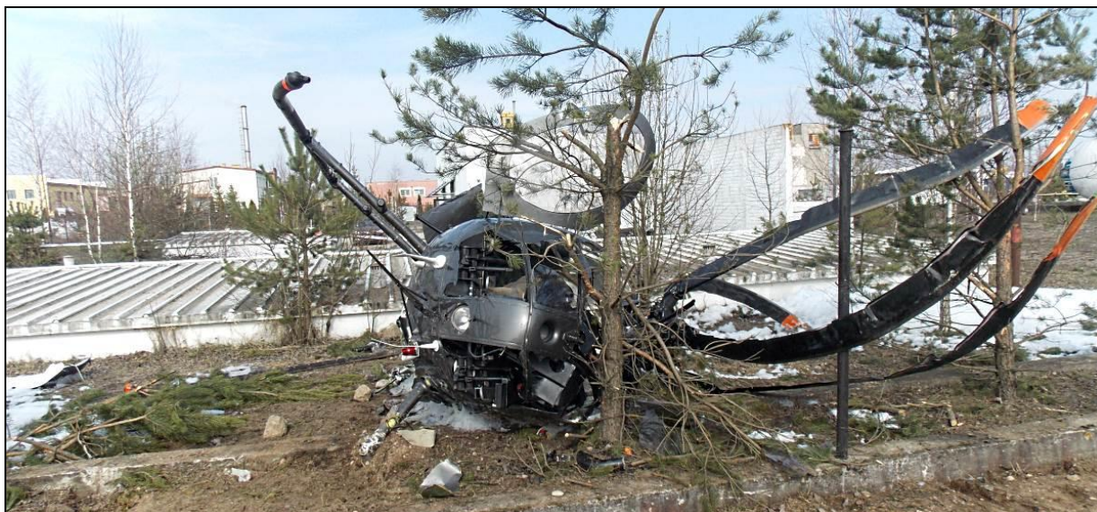
11 – Rozbity śmigłowiec, widok ogólny od przodu. Zwraca uwagę sposób zniszczenia łopat wirnika głównego.
