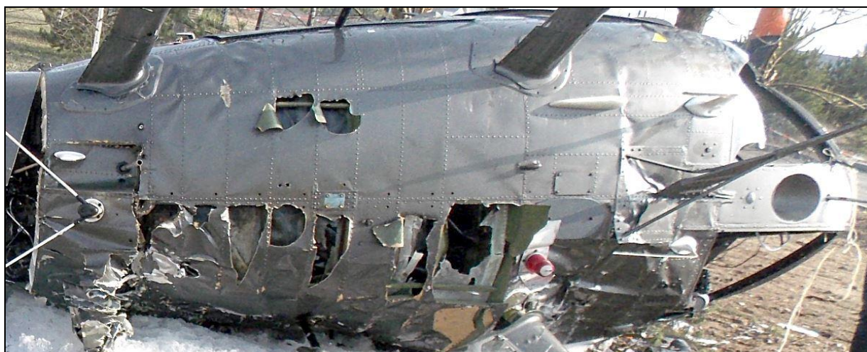
10 – Uszkodzenia dolnych pokryć kadłuba.
