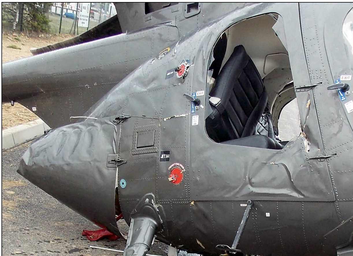
50 – Uszkodzenia prawej strony kadłuba – zbliżenie.
