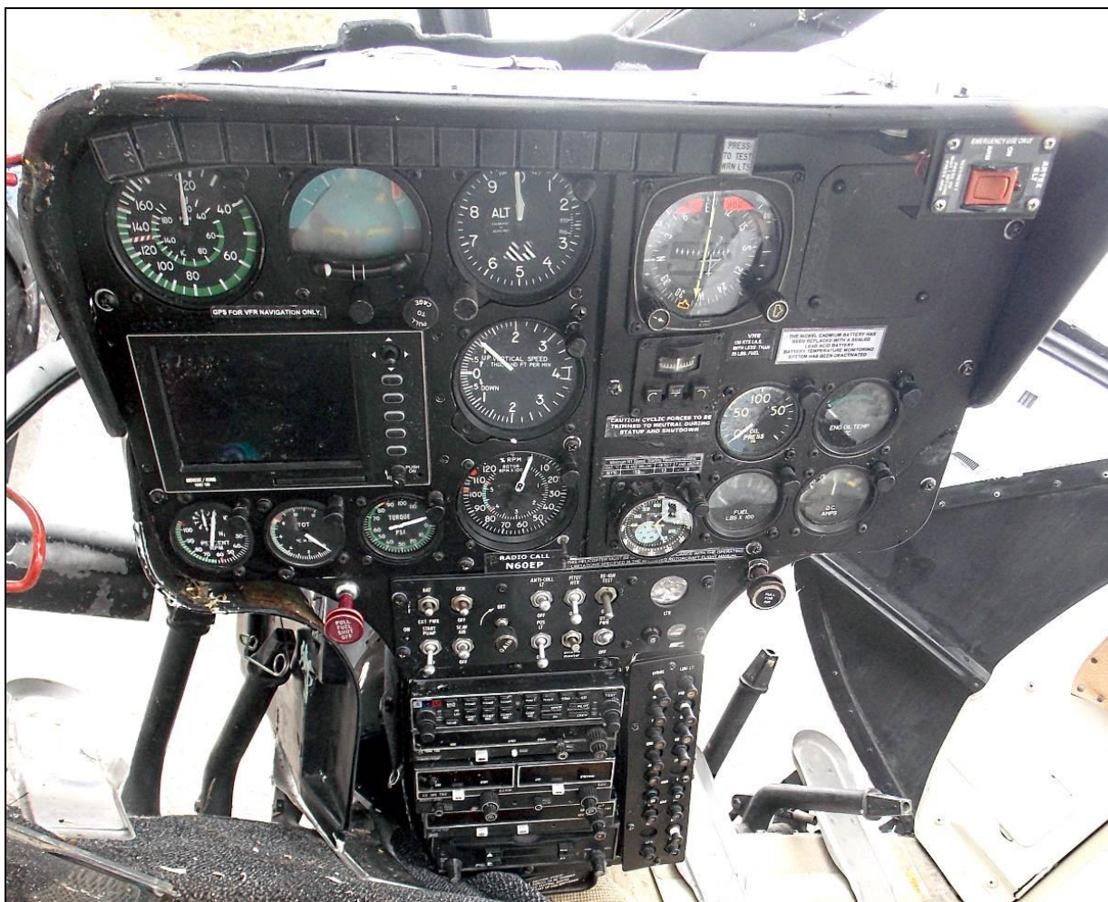
61 – Tablica przyrządów oraz pulpit radiostacji i wyposażenia radionawigacyjnego.
