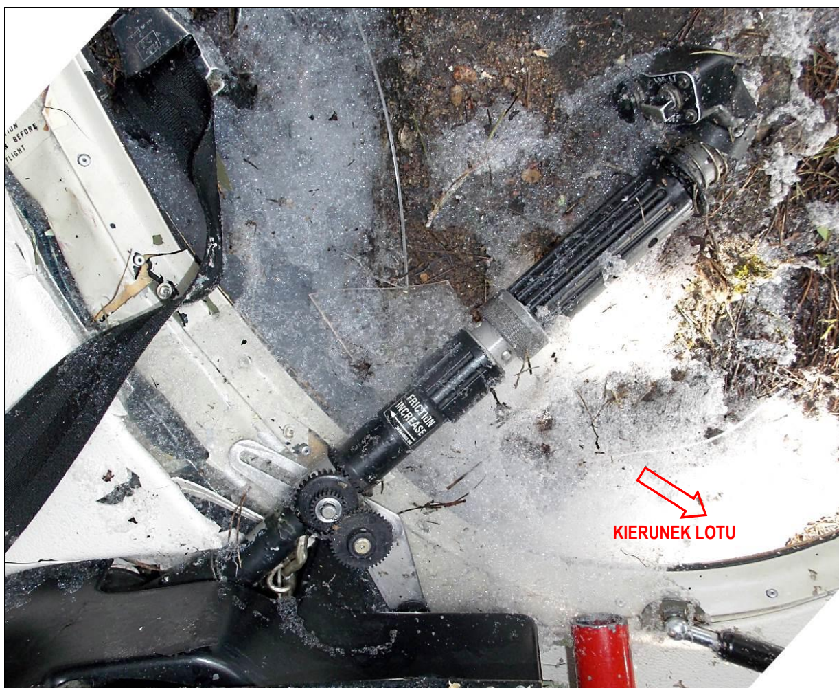
67 – Dźwignia skoku i mocy pokazana od strony wnętrza kabiny. Dobrze widoczne jej położenie.
