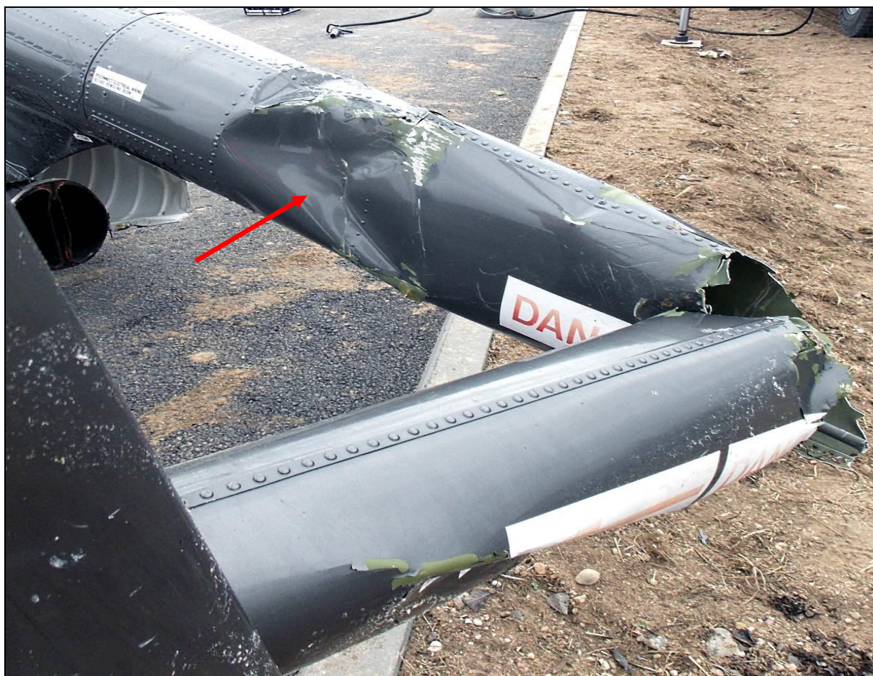
23 – Przełom belki ogonowej. Widoczne wgniecenie od uderzenia łopatą wirnika głównego (czerwona strzałka).
