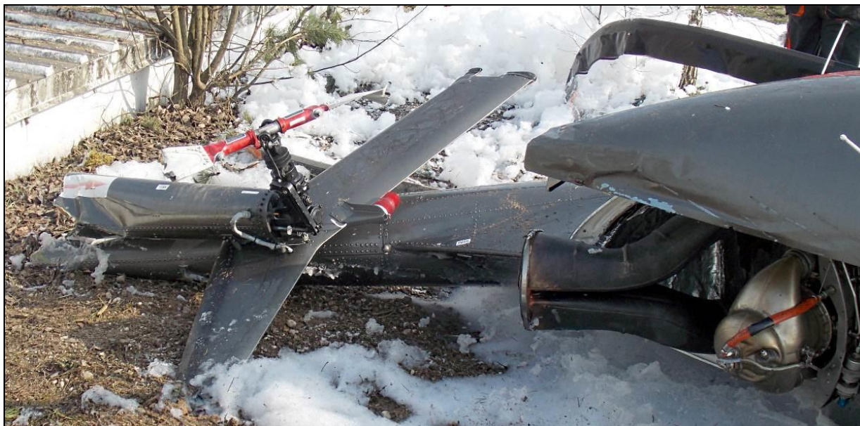
15 – Silnik i złamana belka ogonowa z usterzeniem pionowym i śmigiełkiem ogonowym.
