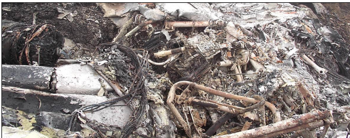
29 – Wypalona kabinowa część kadłuba. Widoczne szczątki szkieletów foteli [foto: PKBWL, R.Rutkowski].
