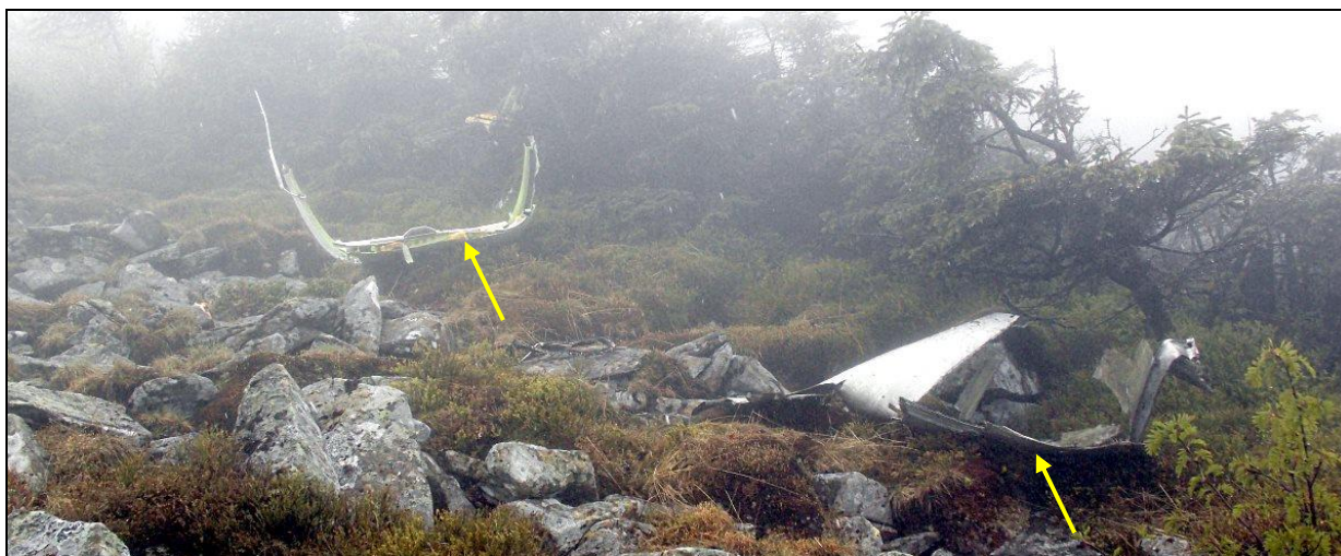
34 – Oderwane elementy dachu kabiny [foto: PKBWL, R.Rutkowski].
