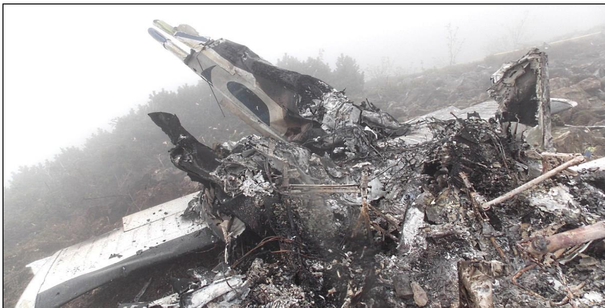
28 – Ogólny widok zniszczonej tylnej części kadłuba. Na pierwszym planie wypalona kabina [foto: PKBWL, R.Rutkowski].
