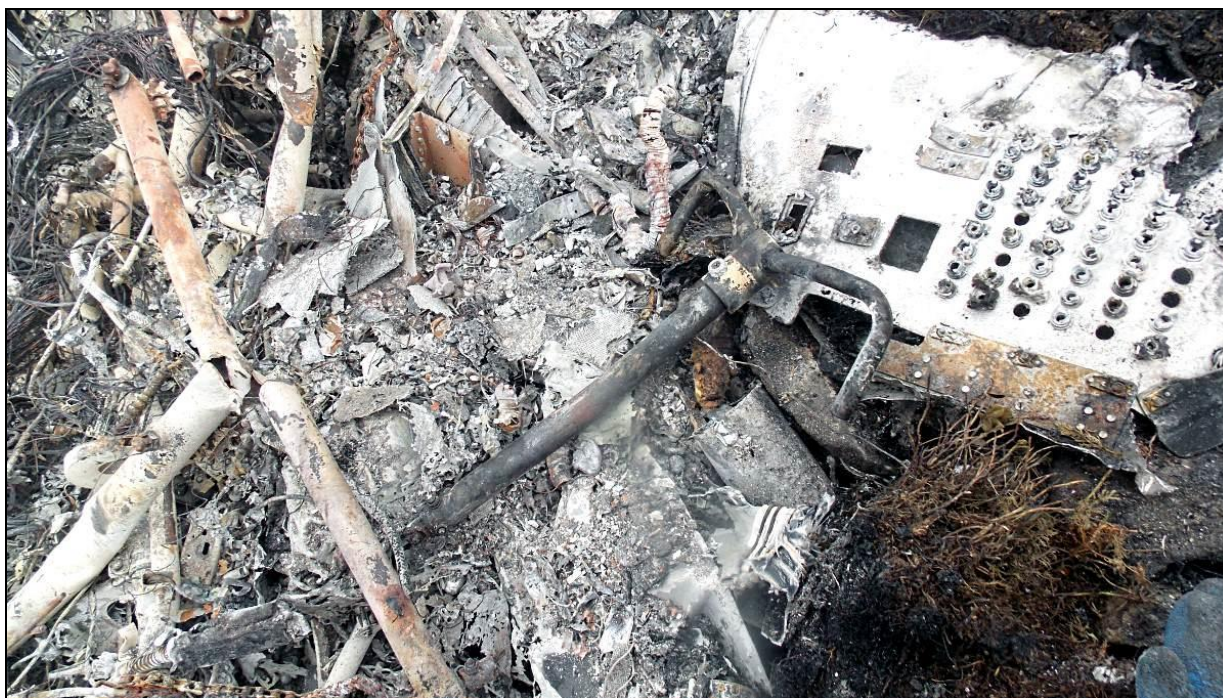
32 – Wypalone wnętrze kabiny. Na pierwszym planie jeden z wolantów. Dobrze widoczny panel bezpieczników [foto: Policja].
