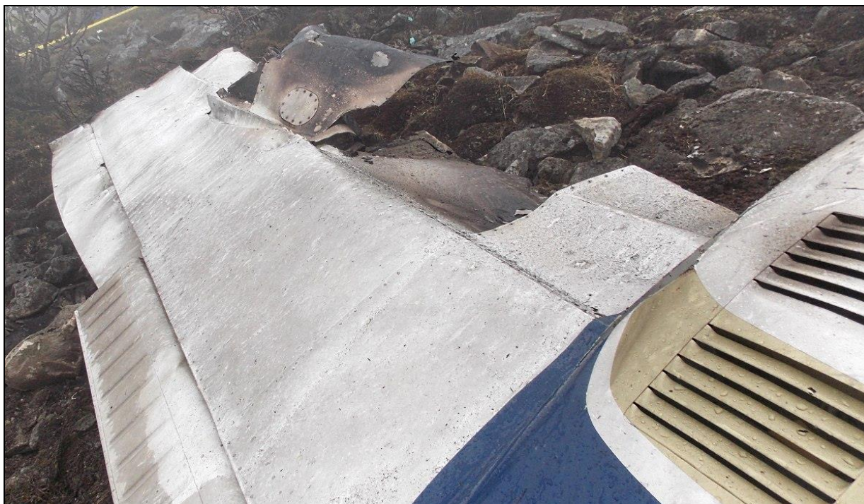
24 – Lewe skrzydło, widok od strony kadłuba. Widoczny rozerwany zbiornik paliwa [foto: PKBWL, R.Rutkowski].
