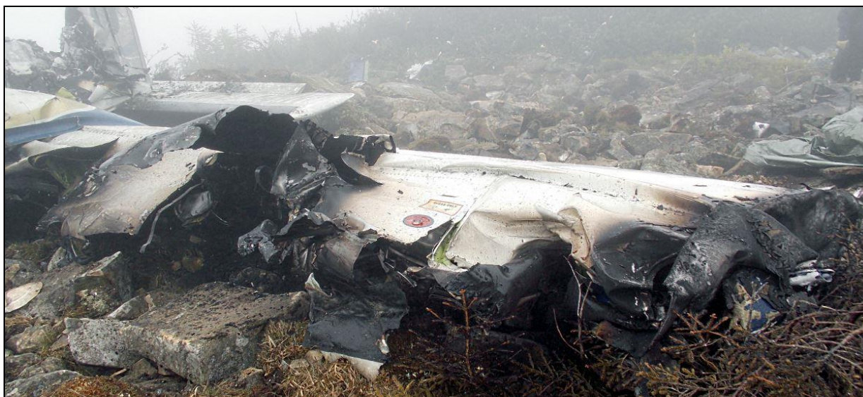
25 – Lewe skrzydło, widok od przodu. Widoczny rozerwany zbiornik paliwa [foto: PKBWL, R.Rutkowski].
