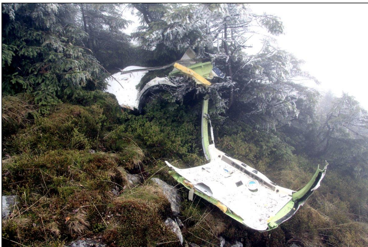
35 – Szczątki dachu kabiny [foto: Policja].
