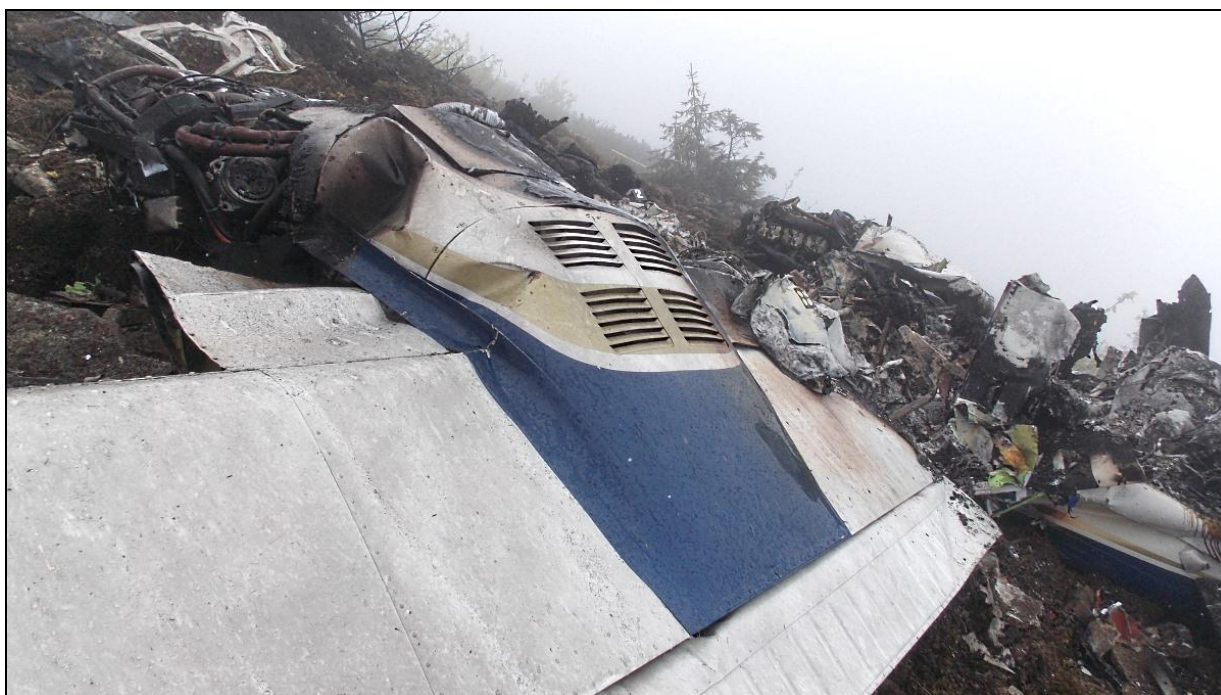
23 – Lewe skrzydło – widoczna gondola silnika i kłapa, w głębi spalona kabinowa część kadłuba [foto: PKBWL, R.Rutkowski].
