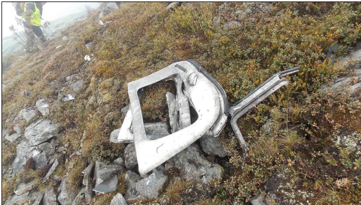
38 – Górna część lewych drzwi kabiny z fragmentem obramowania [foto: PKBWL, R.Rutkowski].
