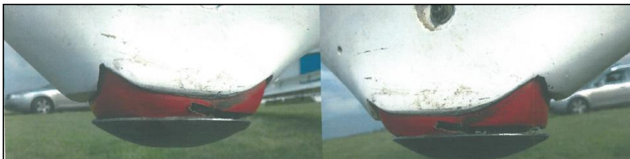
Rys. 2. Uszkodzenie płoży ogonowej szybowca SZD-50-3 Puchacz [źródło: użytkownik]
