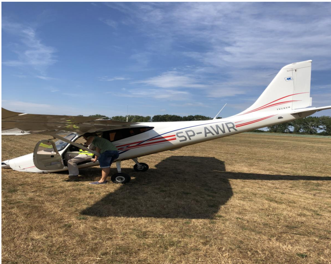
Fot.nr 2(PKBWL). Widok ogólny samolotu z miejsca zatrzymania po wyłamaniu gołeni podwozia przedniego.
