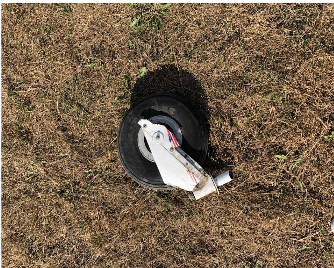
Fot.nr 5 (PKBWL). Koło podwozia przedniego po wyłamaniu z płatowca samolotu P2008
