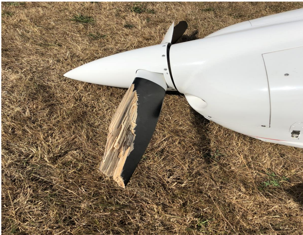
Fot nr 4 (PKBWL). Widoczny efekt uderzenia łopaty śmigła P2008 o płaszczyznę lotniska.
