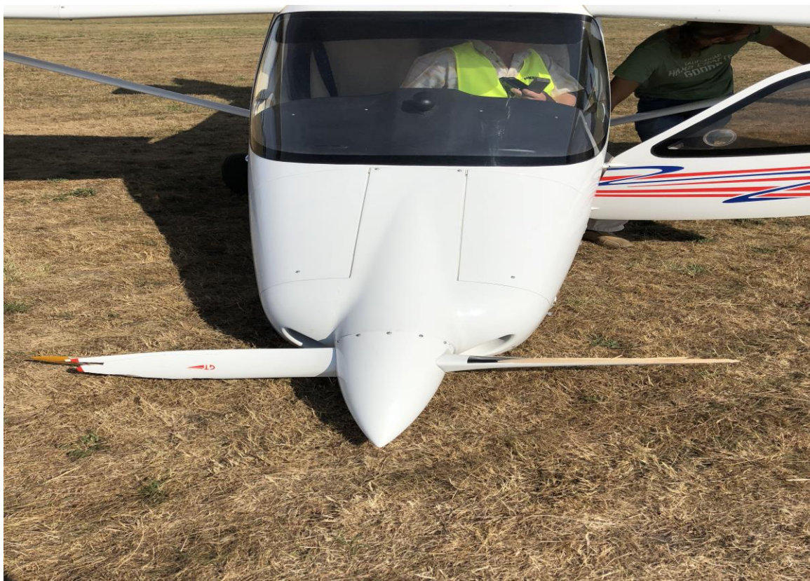
Fot.nr 3(PKBWL). Samolot oparty na masce silnika z uszkodzonym śmigłem.
