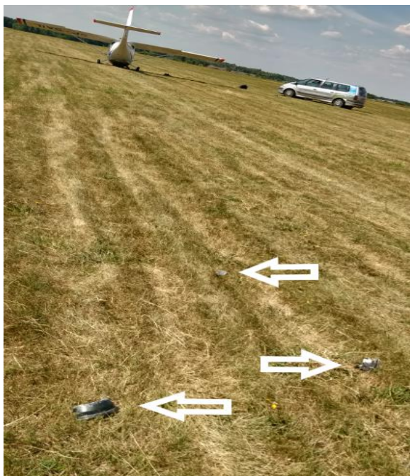
Rys. 2. Widoczne fragmenty zniszczonej laminatowej felgi przedniego koła [źródło: użytkownik].
