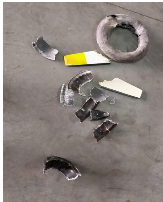
Rys. 3. Fragmenty zniszczonej felgi i śmigła [źródło: użytkownik].
