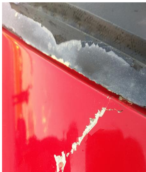
Rys. 5 Pęknięte poszycie (górną część kadłuba), zniszczona limuzyna kabiny [źródło: użytkownik].
