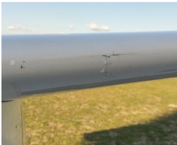
Rys. 2 Rozwarstwiony statecznik poziomy [źródło: użytkownik].
