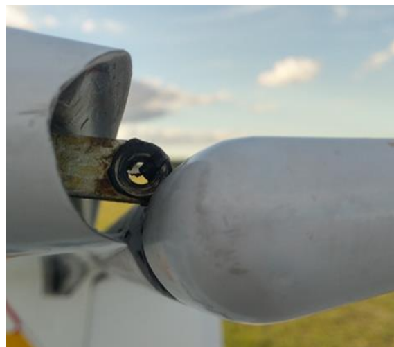
Rys. 3 Uszkodzone mocowanie steru wysokości [źródło: użytkownik].
