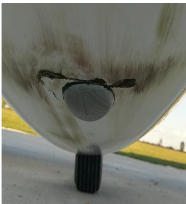
Rys. 4 Uszkodzenie dolnej części kadłuba szybowca (pęknięte poszycie) [źródło: użytkownik].
