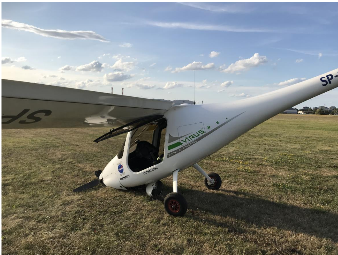
Rys.1 Złamana goleń podwozia przedniego, zniszczony kołpak, śmigło i uszkodzone osłony silnika. [źródło: użytkownik]
