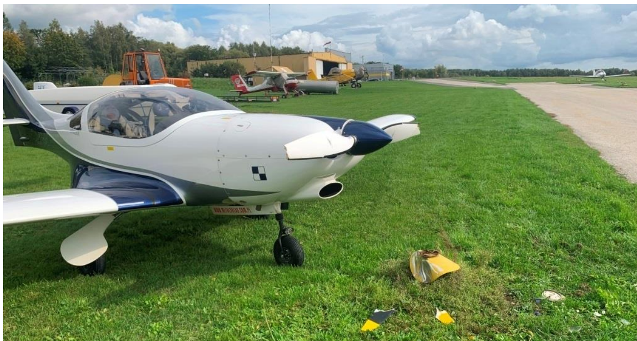
Rys.2. Widok na samolot po zdarzeniu. Widoczne fragmenty łopat śmigła i uszkodzona lampa oświetlenia drogi kołowania [ źródło: użytkownik]
