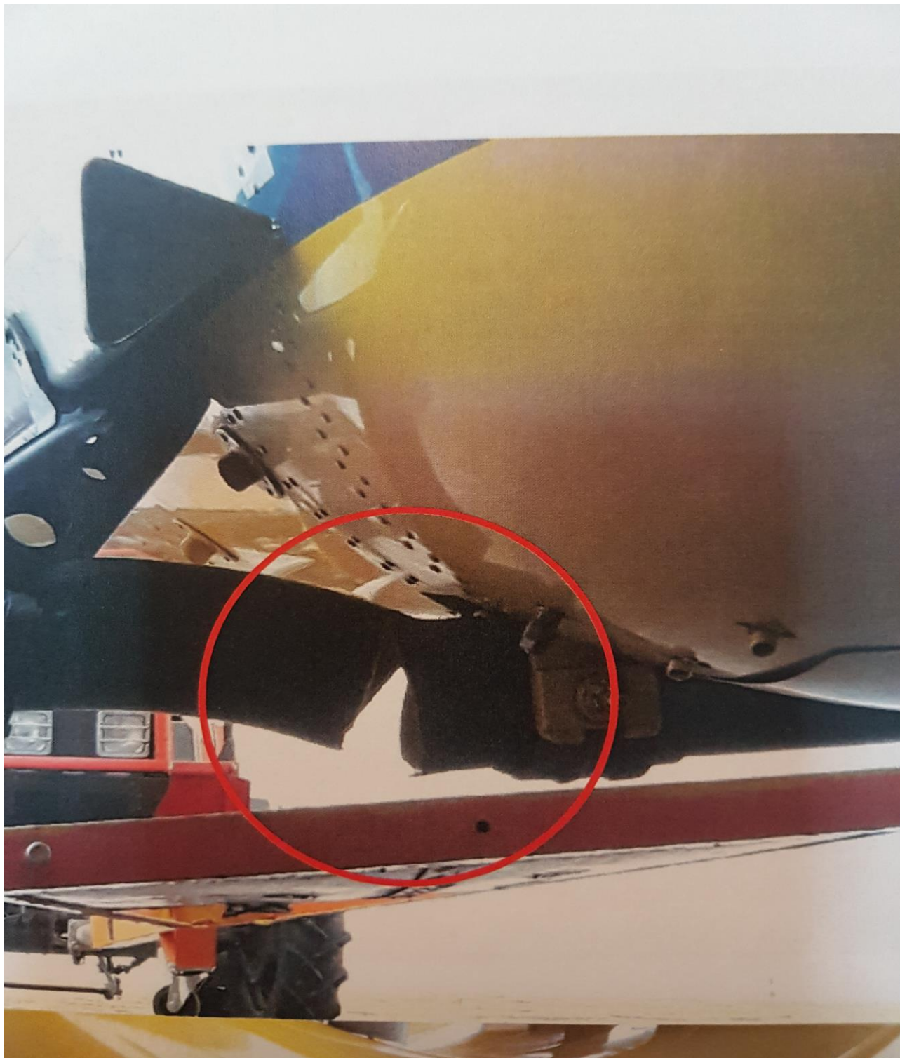
Rys. nr 1. Widok pękniętej lewej goleni podwozia śmigłowca [źródło: użytkownik]
