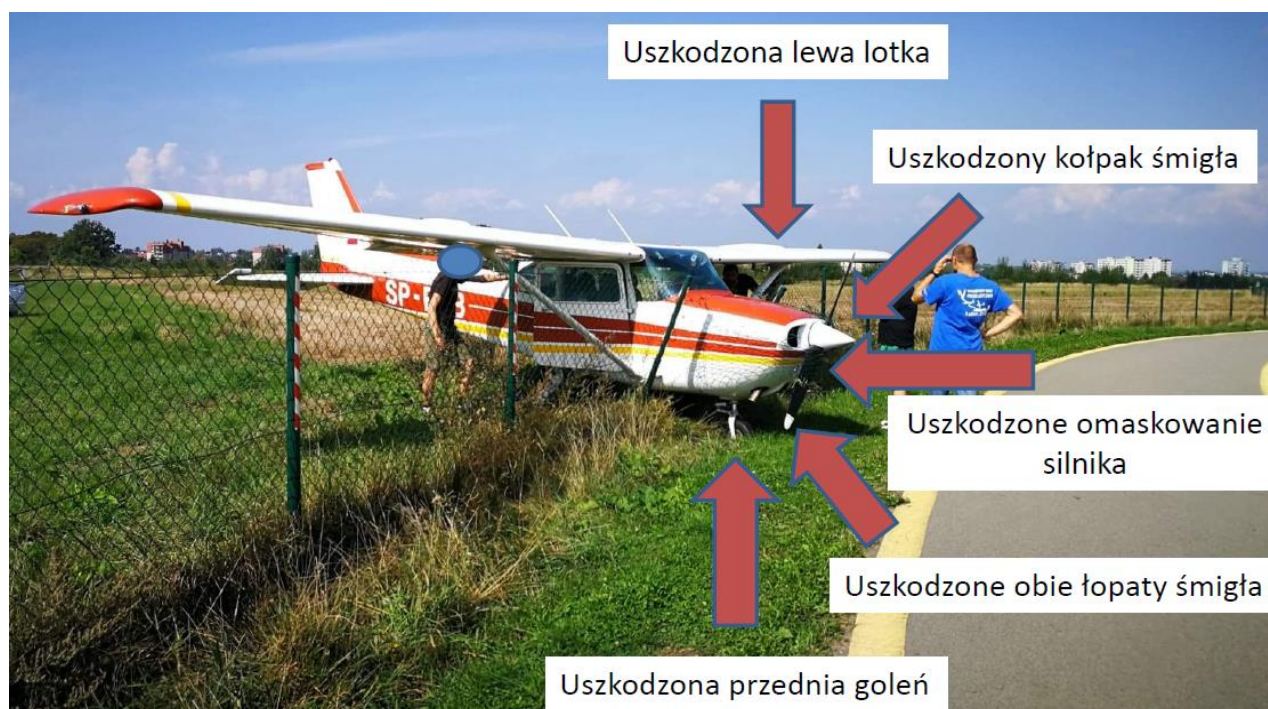
Rys. 2 Miejsce zatrzymania samolotu z opisem uszkodzeń [źródło: użytkownik]
