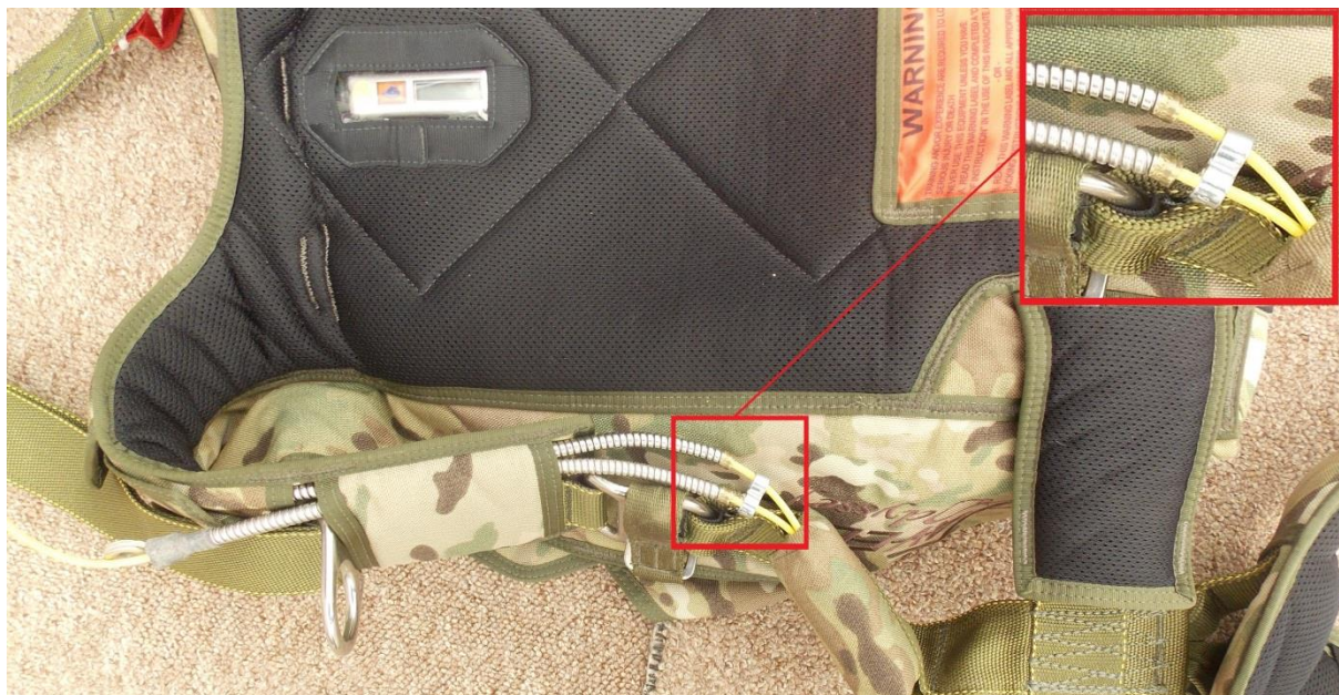
Rys.11. Widok na wyrwane osłony kabli [źródło: PKBWL]
