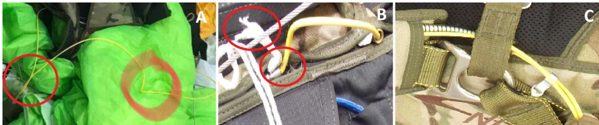
Rys. 7. Na zdjęciu A pokazano stan kabla zaraz po wypadku. Na zdjęciu B widać uszkodzenia kabla i wyrwane mocowanie osłony kabla w pokrowcu spadochronu. Na zdjęciu C widoczne brak uszkodzeń na końcówce kabli przy uchwycie wypinania czaszy głównej [źródło: skoczek, PKBWL]
