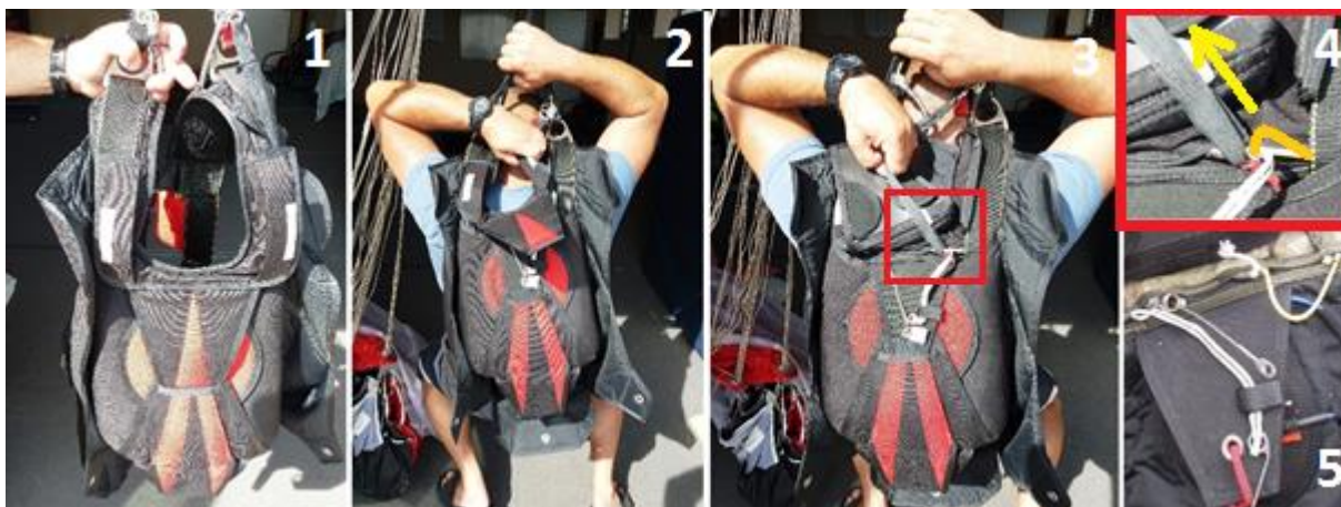
Rys. 5. Najbardziej prawdopodobny przebieg rozerwania taśmy RSL-a wyrwania osłony kabla i zagięcia kabla. Na ilustracji nr. 4 strzałką pokazano kierunek działania siły i sposób, w jaki wygiął się kabel. Na ilustracji 5 widok na te elementy po wypadku [źródło: PKBWL]
