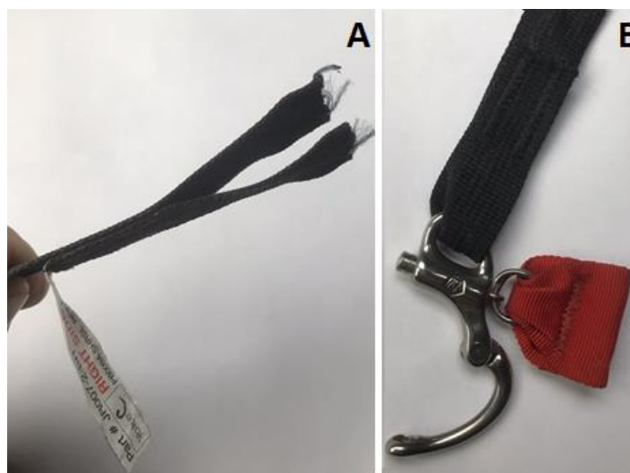
Rys. 6. Na zdjęciu pokazano końcówki taśmy RSL-a [źródło: skoczek]
