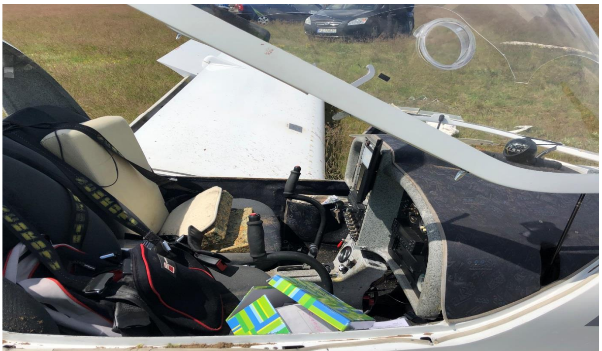
Rys. 3. Ogólny widok kabiny tuż po zdarzeniu z widocznym przemieszczeniem drążków sterowych. (źródło PKBWL)
