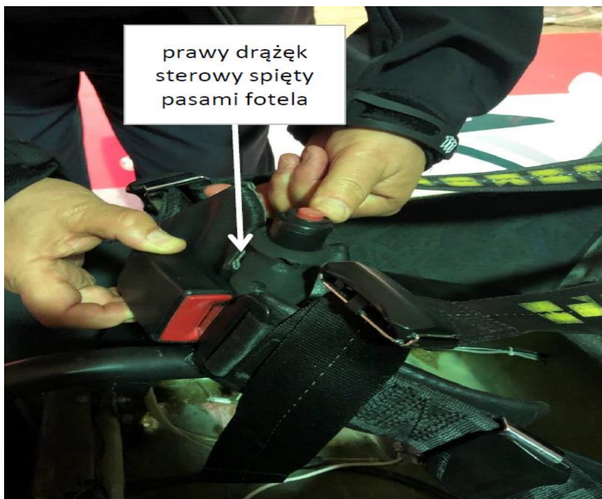
Rys. 6. Prawy drążek sterowy spięty pasami bezpieczeństwa fotela. (źródło PKBWL)
