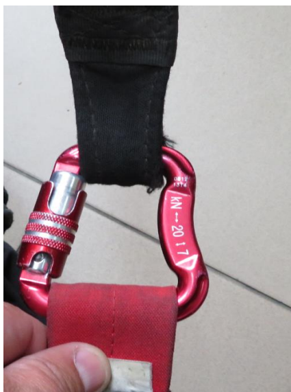
Rys. 6. Prawidłowo zapięty karabińczyk do taśmy rozpórki [źródło: PKBWL]
