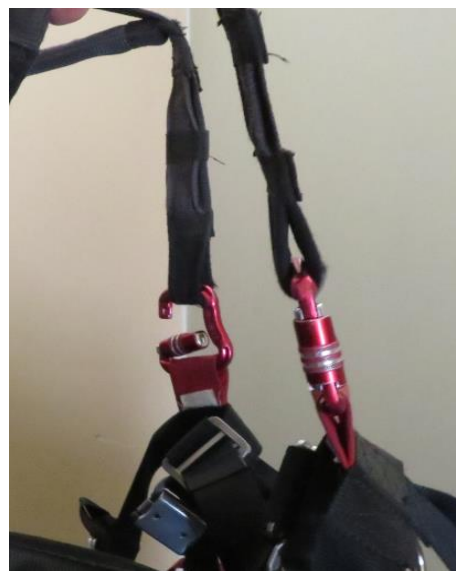
Rys. 7. Widok otwartego karabińczyka [źródło: PKBWL]
