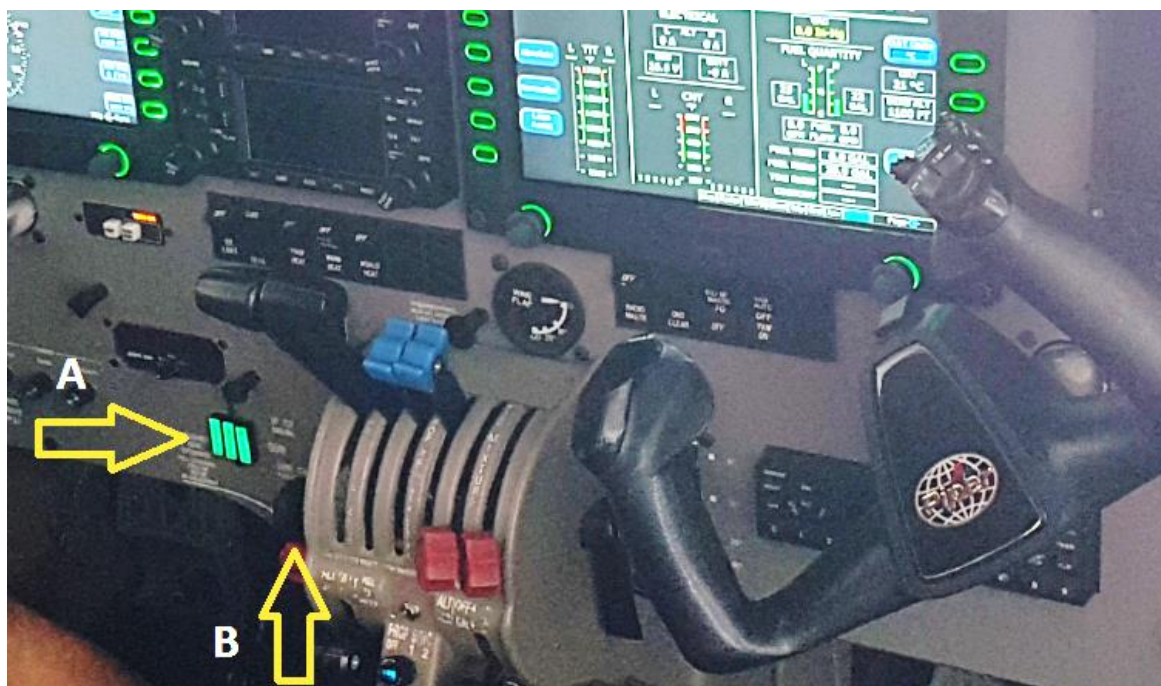
Rys. 1. Widok: A-sygnalizacja świetlna wypuszczonego podwozia, B-dźwignia wypuszczonego podwozia [źródło: użytkownik].
