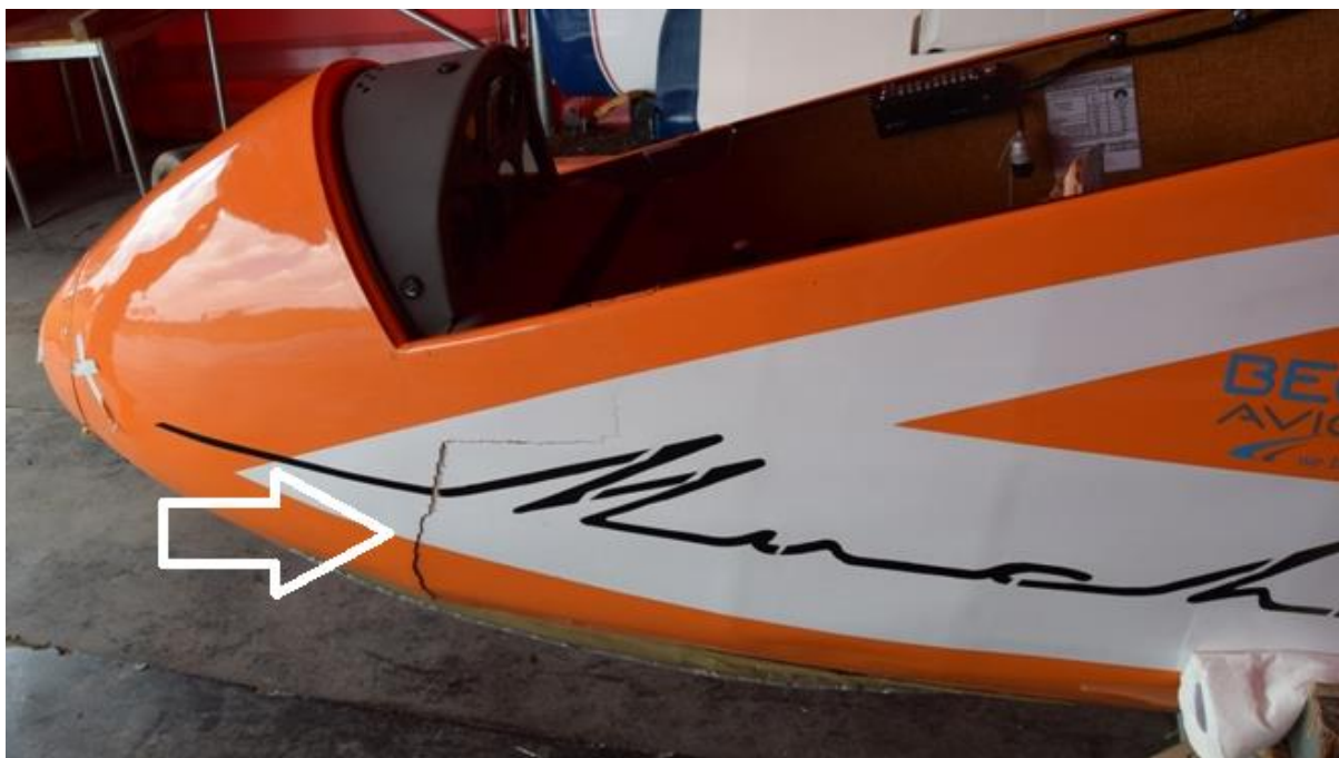
Rys. 2 Pęknięcie sklejki pokrycia z lewej strony kadłuba [źródło: użytkownik]
