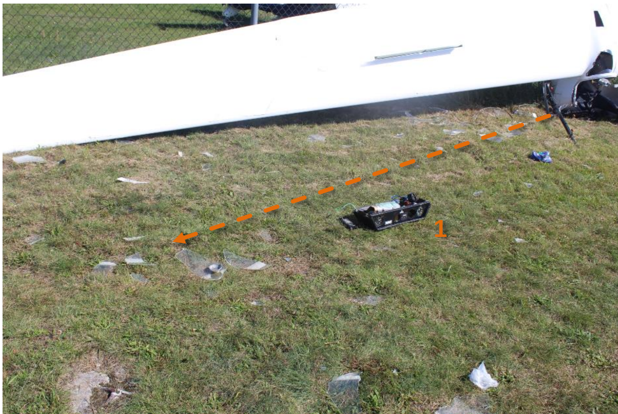
Rys. 8. Widok na prawe skrzydło szybowca, zaznaczono kierunek rozrzutu szczątków oszklenia i fragmentów szybowca
