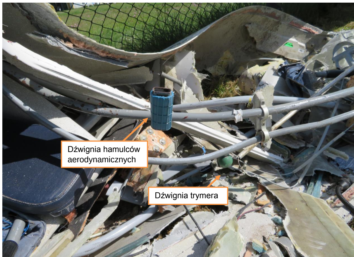
Rys.15. Druga kabina szybowca – popychacze wygięte w trakcie procesu niszczenia kabiny uniemożliwiające ocenę położenia dźwigni w chwili zderzenia
