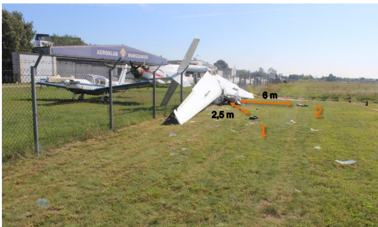
Rys. 7. Szybowiec na miejscu zdarzenia, prawa strona, widok w kierunku startu (1 – tablica przyrządów tylnej kabiny, 2 – spadochron pilota odciągnięty w czasie akcji ratowniczej) [źródło: policja]
