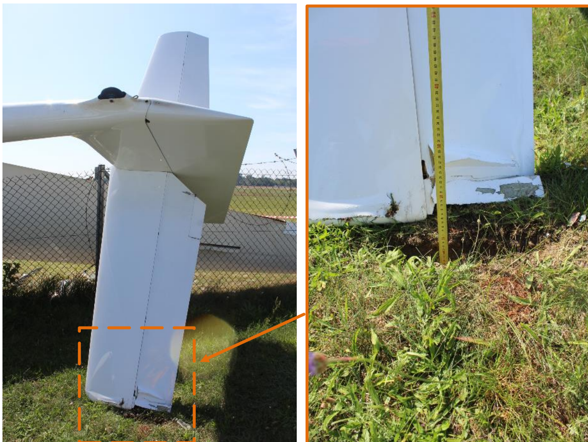
Rys. 21. Miejsce kontaktu złamanego ogona z ziemią [źródło: policja]
