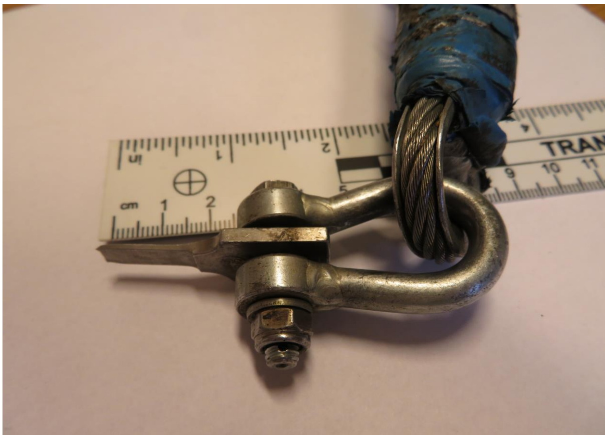
Rys. 24. Zerwany bezpiecznik liny wyciągarkowej wraz z fragmentem liny – cz. 2
