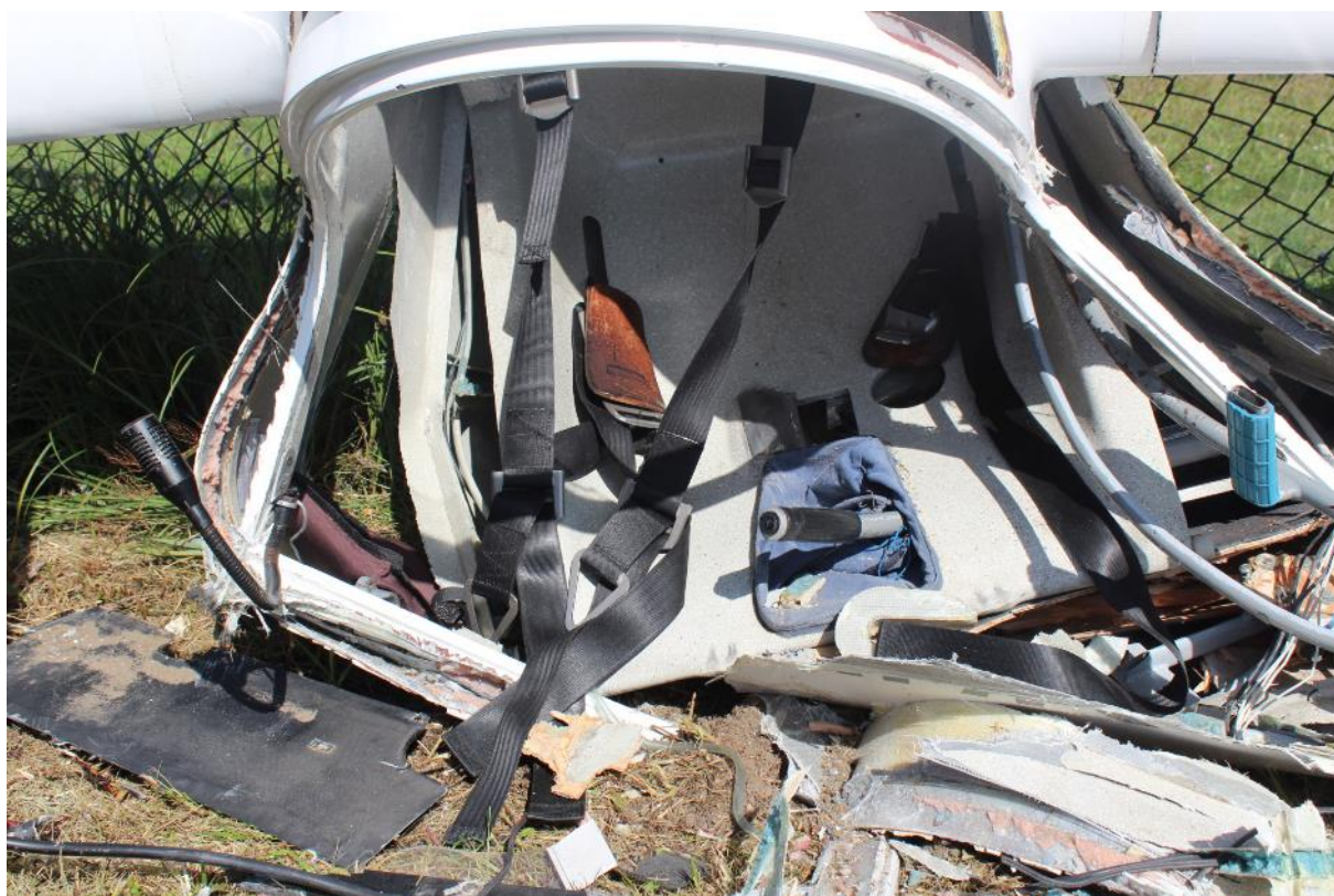
Rys. 16. Druga kabina szybowca po rozpięciu pasów i wyjęciu poduszki siedzeniowej [źródło: policja]
