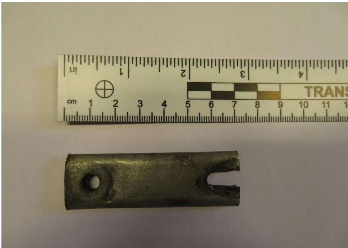
Rys. 23. Zerwany bezpiecznik liny wyciągarkowej – cz. 1
