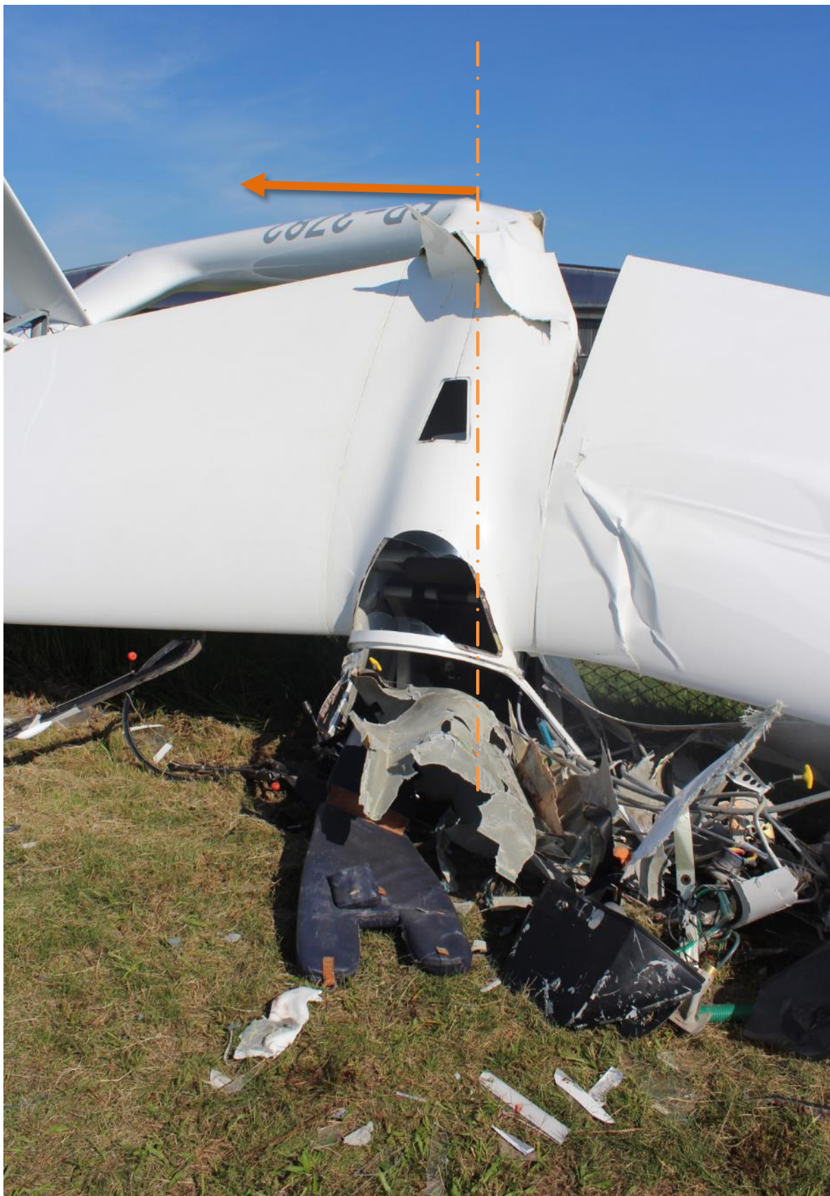
Rys. 12. Zaznaczona schematycznie oś obrotu i strzałka wskazująca kierunek łamania się ogona [źródło: policja]
