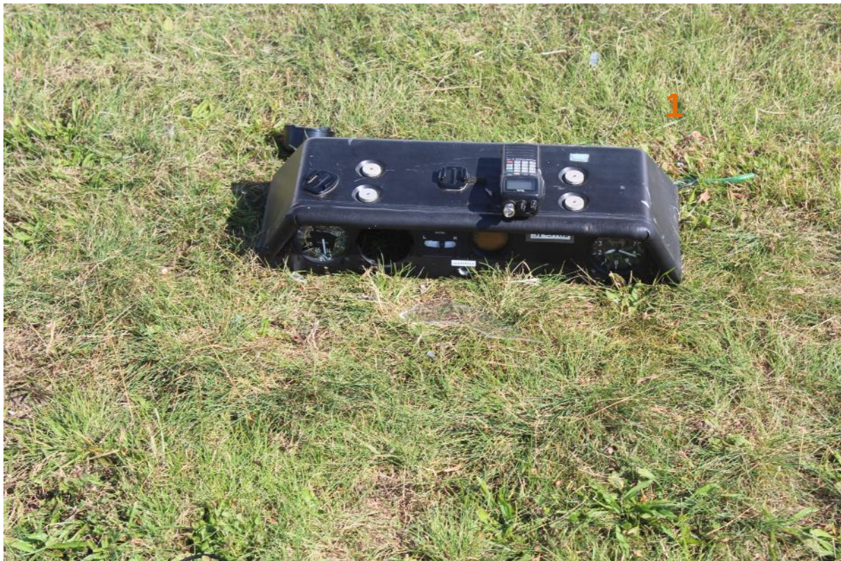
Rys. 9. Tablica przyrządów z drugiej kabiny wyrwana w trakcie zdarzenia [źródło: policja]
