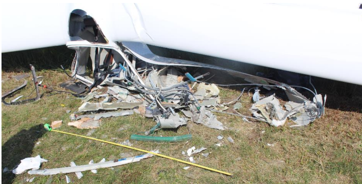
Rys. 14. Szczątki kabinowej części kadłuba z lewej strony [źródło: policja]
