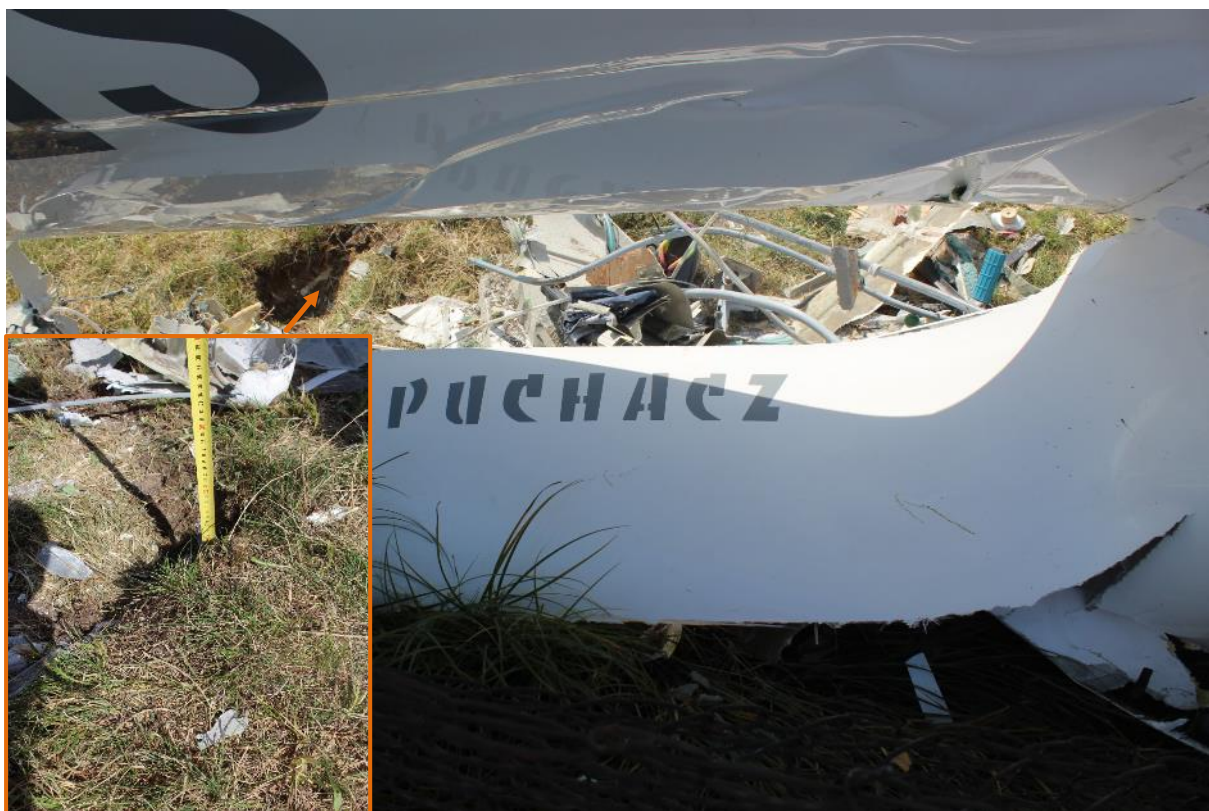
Rys. 19. Miejsce pierwszego kontaktu kabiny szybowca z ziemią – zagłębienie na około 0,18 m
