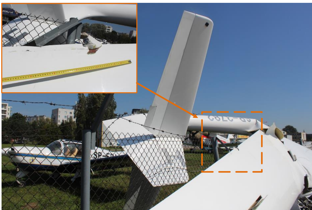
Rys. 20. Fragment spływu skrzydła prawego uszkodzony podczas kontaktu z słupem ogrodzeniowym [źródło: policja]
