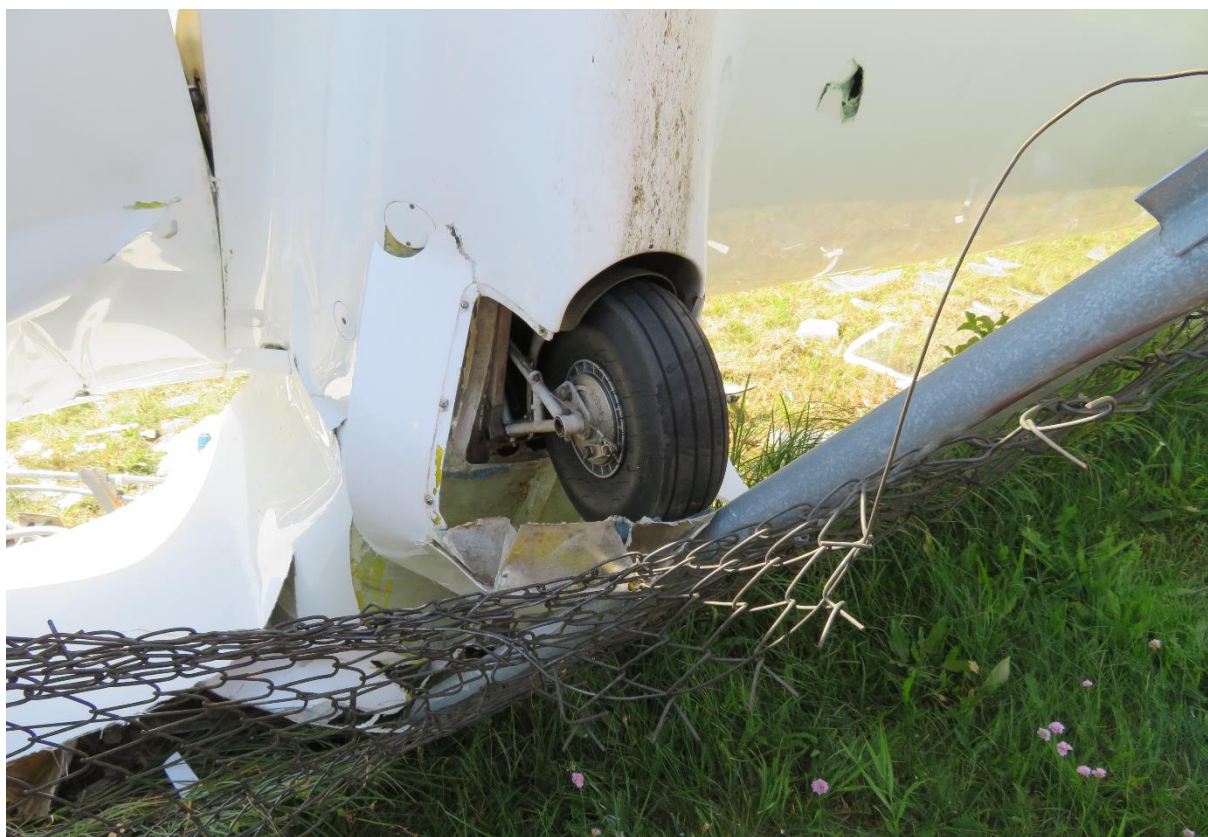
Rys. 22. Uszkodzenie pokrycia w obrębie koła głównego
