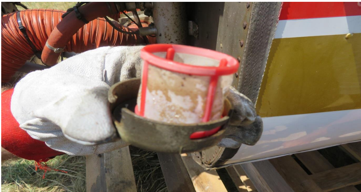
Rys. 5 Widok zanieczyszczeń na filtrze paliwowym. [ Źródło, PKBWL ]
