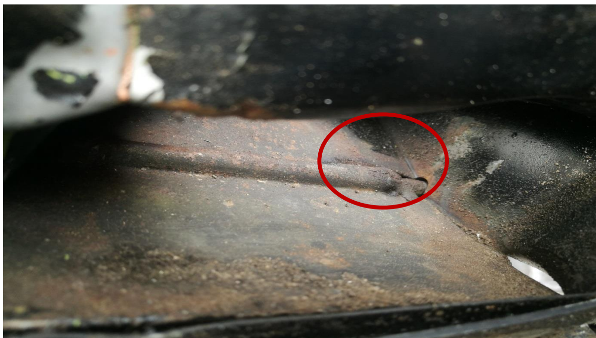
Rys.10 Widok osi obrotu zaworu podgrzewu gaźnika w miejscu ułożyskowania. [Źródło, PKBWL]
