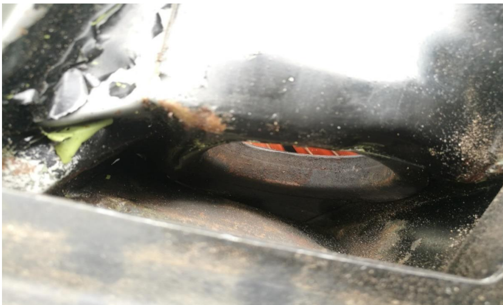
Rys.9 Ślady pożaru we wlocie powietrza do silnika. [Źródło, PKBWL]
