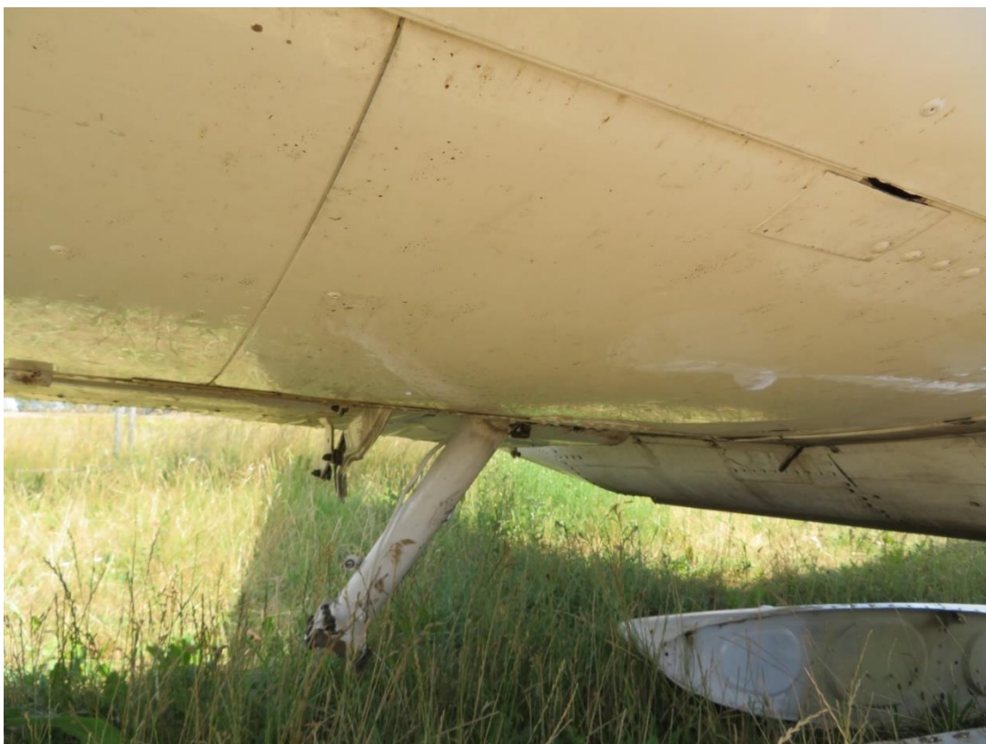
Rys.3 Widok uszkodzonej prawej goleni.[Źródło, PKBWL]
