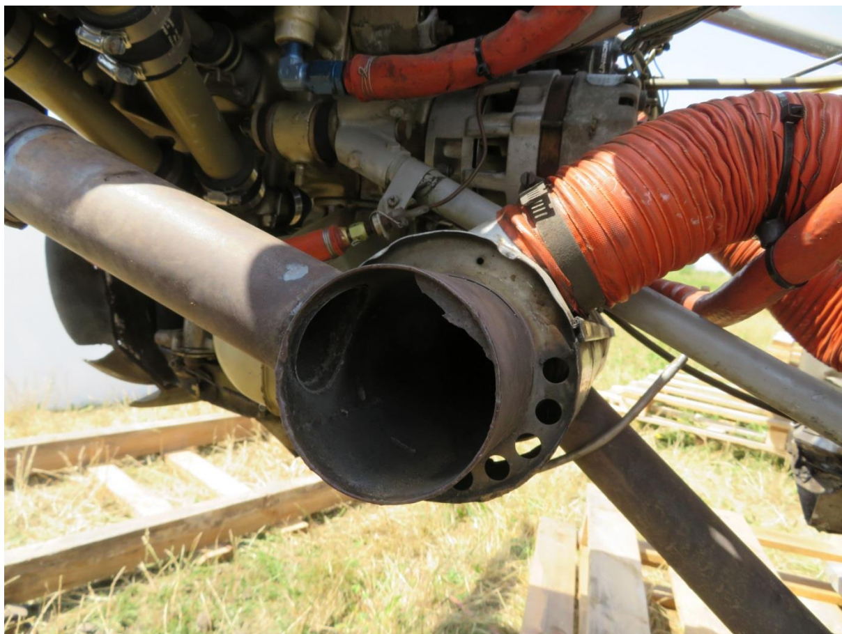
Rys.6 Widok tłumika z wyrwanym denkiem.[Źródło, PKBWL]
