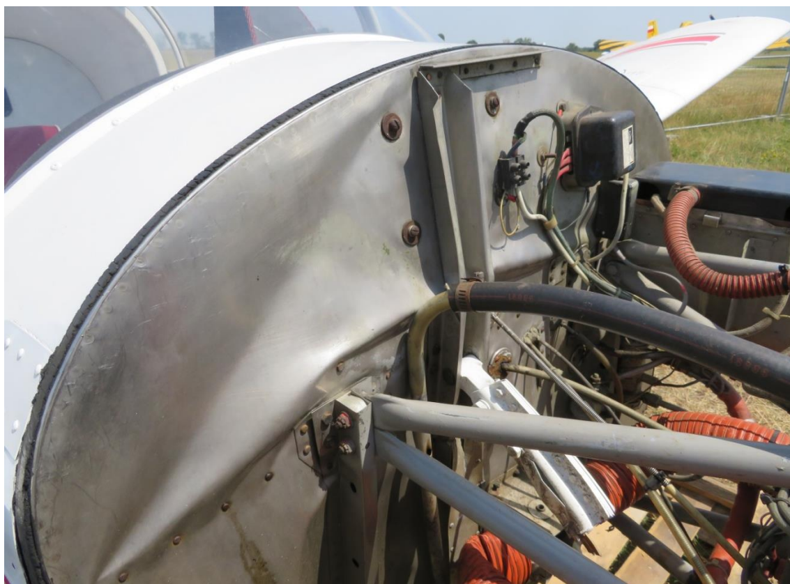
Rys.1 Widok zdeformowanej ściany ogniowej.[Źródło, PKBWL]
