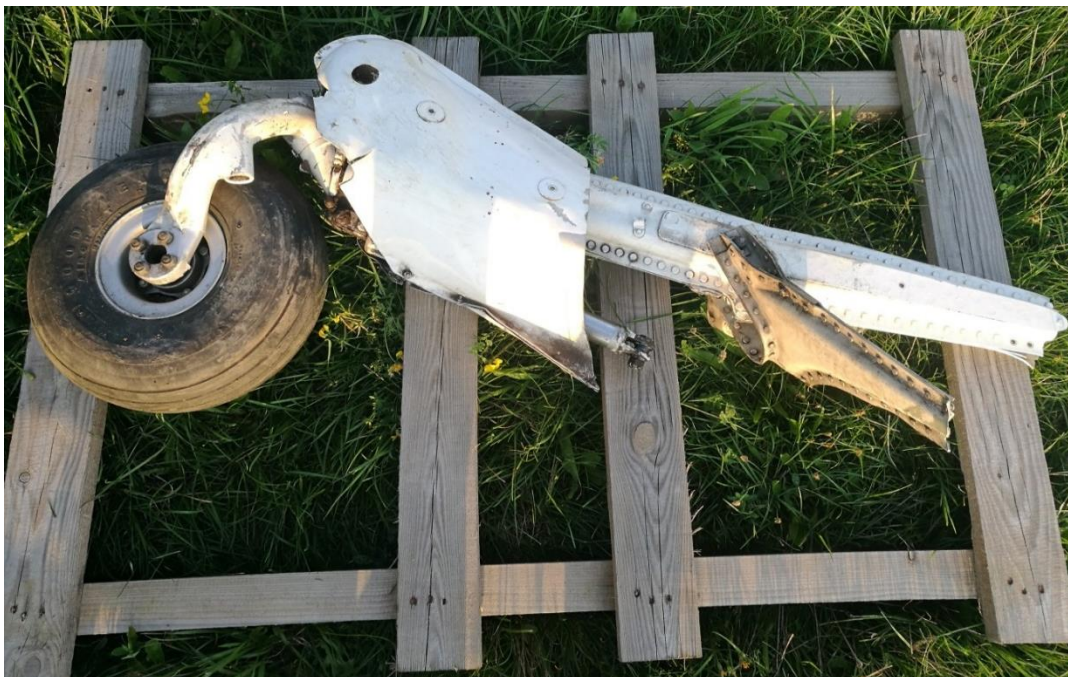
Rys.2 Urwana przednia goleń.[Źródło, PKBWL]
