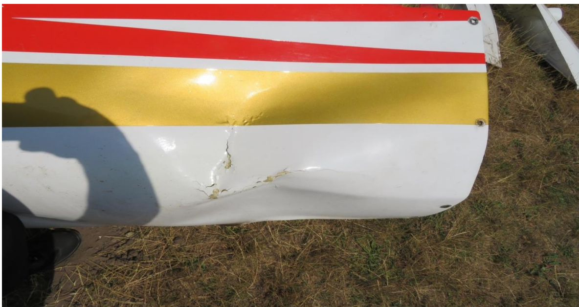
Rys.4 Zdeformowana osłona silnika. [ Źródło, PKBWL ]
