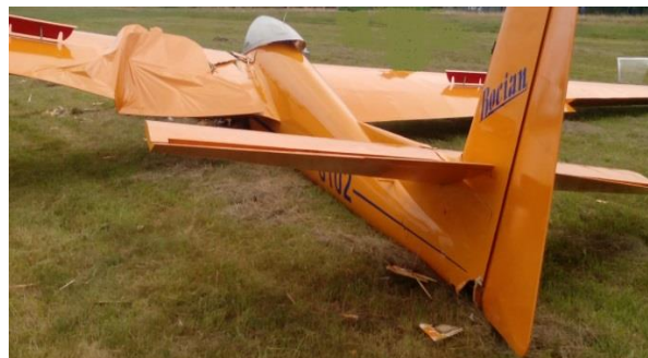
Rys. 5 Zniszczone mocowanie lewego skrzydła, wyłamana płoza ogonowa [źródło: PKBWL].
