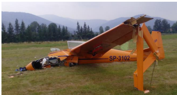
Rys. 4 Zniszczona kabina, złamane lewe skrzydło [źródło: PKBWL].
