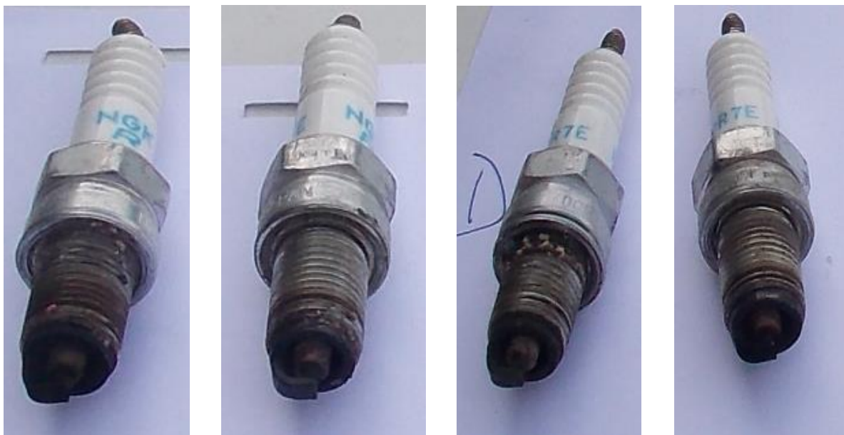
Rys. 4. Stan świec drugiego i czwartego cylindra [źródło: PKBWL].
