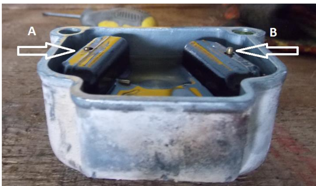
Rys. 5. Widoczna różnica pływalności między pływakami A i B w lewym gaźniku [źródło: PKBWL].
